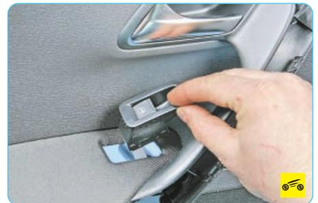
7. ...и снимите выключатель.
