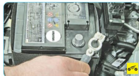
1. Снимите аккумуляторную батарею (см. «Снятие и установка аккумуляторной батареи», с. 183).
