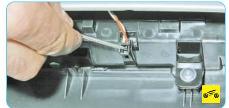
2. Отверткой отожмите фиксатор колодки проводов дополнительного стоп-сигнала...
