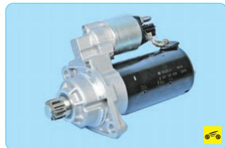
Стартер автомобиля представляет собой четырехполюсный четырехщеточный электродвигатель постоянного тока с возбуждением от постоянных магнитов, совмещенный с планетарным редуктором и электромагнитным двухобмоточным тяговым реле. Технические характеристики стартера, применяемых на автомобилях, приведены в табл. 10.4.
