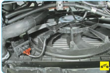
6. Очень часто причиной перегрева двигателя, система охлаждения которого оснащена электрическим вентилятором, становится выход вентилятора из строя. Пустите двигатель, следите за температурой и обратите внимание на то, включается ли при перегреве двигателя вентилятор системы охлаждения. Причинами не включения вентилятора могут быть перегоревший предохранитель (плавкая вставка), неисправное реле включения...
