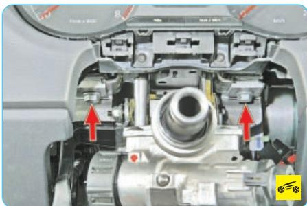
14. Выверните два болта крепления рулевой колонки...
