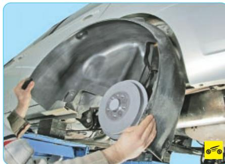
3. Снимите подкрылок заднего колеса (см. «Снятие и установка подкрылков колес», с. 224).
