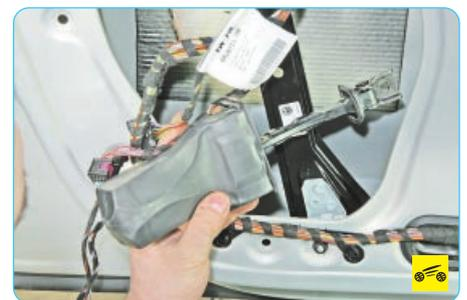
4. Снимите ограничитель через отверстие во внутренней панели двери.
