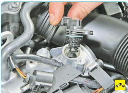
5. ...и извлеките датчик из отверстия в крышке головки блока цилиндров.
