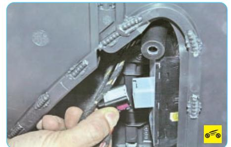
13. ...и отсоедините колодки жгутов проводов от выключателя электропривода замка крышки багажника и от блока управления стеклоподъемниками.
