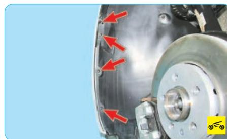
11. Выверните по три винта крепления бампера к подкрылку и по одному винту крепления бампера к крылу с каждой стороны.
