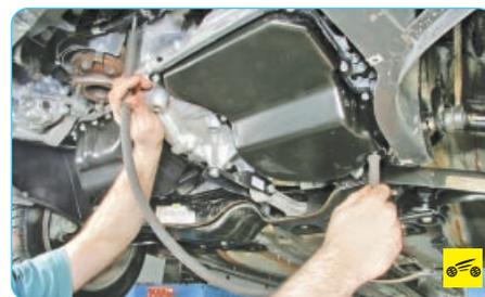
9. Через отверстие для контроля уровня вставьте в перепускную трубку шланг таким образом, чтобы его конец был выше кромки перепускной трубки.
