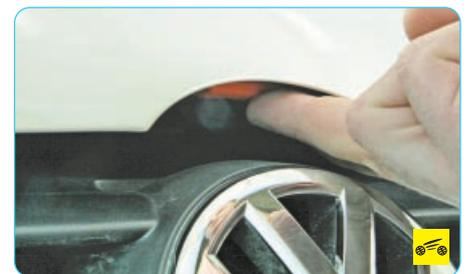
Приподнимите капот и через образовавшуюся щель нажмите на лапку предохранительного крючка.
