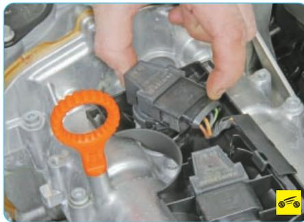
2. Проверьте посадку катушки зажигания на свече.
