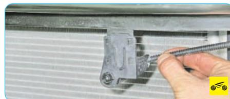
3. Извлеките жгут проводов датчика наружной температуры из прорези кронштейна.
