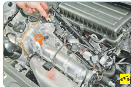
6. Отсоедините от катушек зажигания колодки жгутов проводов (см. «Снятие и установка катушек зажигания», с. 194) и снимите направляющую низковольтных проводов.
