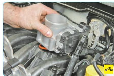
4. Снимите дроссельный узел (см. «Снятие и установка дроссельного узла», с. 107).
