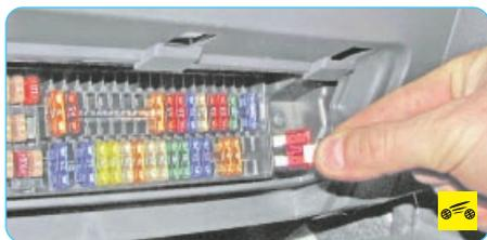
3. Пинцетом извлеките предохранитель из контактного разъема.
