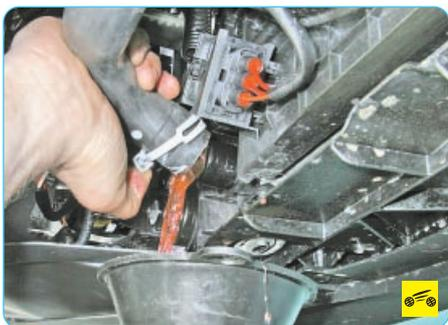
2. Слейте 2–3 л охлаждающей жидкости из системы охлаждения двигателя (см. «Замена охлаждающей жидкости», с. 94).
