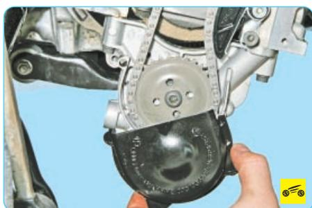
2. Снимите защитный кожух звездочки масляного насоса.
