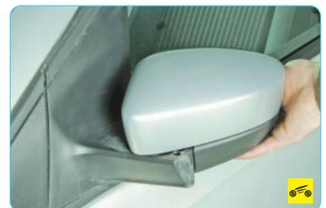
Для уменьшения габарита автомобиля при парковке в местах с интенсивным движением наружное зеркало можно сложить, повернув на шарнире рукой назад...
