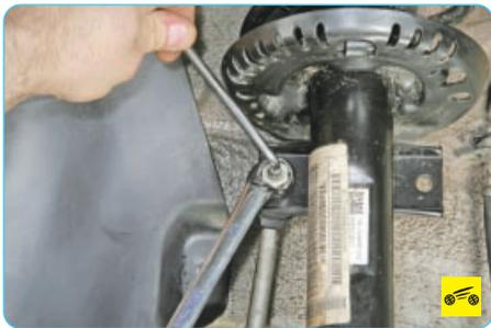
3. Удерживая от проворачивания, отверните гайку верхнего крепления пальца шарнира стойки стабилизатора к кронштейну амортизаторной стойки...
