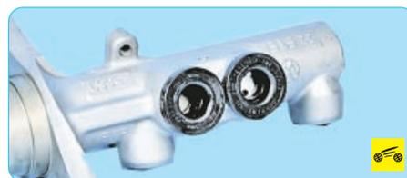
9. Если в процессе эксплуатации наблюдалась течь тормозной жидкости через соединительные втулки, извлеките втулки из отверстий корпуса цилиндра. Для этого, поддев отверткой край втулки, извлеките ее из отверстия главного тормозного цилиндра. Аналогично извлеките другую втулку.
