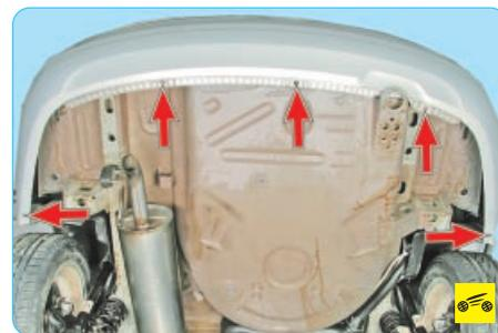
8. Выверните пять винтов нижнего крепления бампера.
