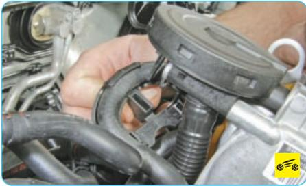
5. ...и снимите держатель с фиксатора.
