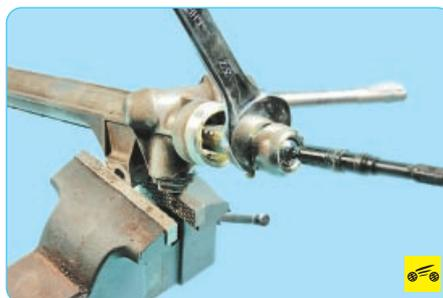
8. Отверните шарнир рулевой тяги от рейки рулевого механизма и снимите тягу.
