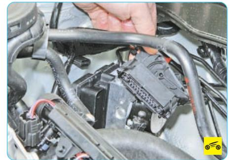
4. ...и отсоедините колодку от гидроэлектронного блока управления антиблокировочной системой тормозов.
