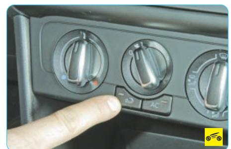
Для включения режима рециркуляции нажмите на кнопку выключателя 2 (см. рис. 1.9)
