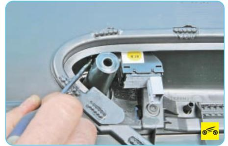
5. Отожмите фиксатор выключателя...
