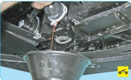
7. Слейте охлаждающую жидкость из системы охлаждения (см. «Замена охлаждающей жидкости», с. 94).
