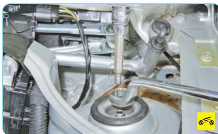
8. Проверьте затяжку гайки штока амортизаторной стойки.
