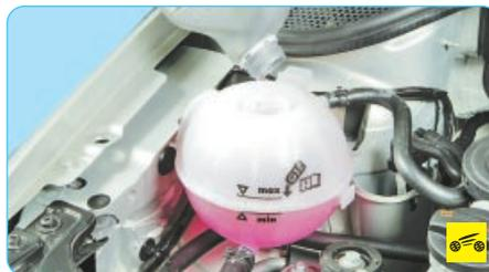
13. Залейте жидкость в систему охлаждения двигателя (см. «Замена охлаждающей жидкости», с. 94).
