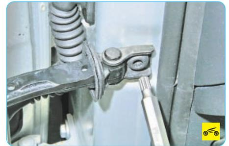
2. Выверните винт крепления ограничителя к стойке кузова...
