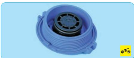
**Пробка расширительного бачка** с впускным и выпускным клапанами. Выпускной клапан поддерживает повышенное давление в системе с целью повышения температуры кипения охлаждающей жидкости. Клапан открывается, когда давление становится выше 0,16 МПа (1,16 кгс/см<sup>2</sup>). При остывании двигателя давление в системе снижается и открывается впускной клапан.
