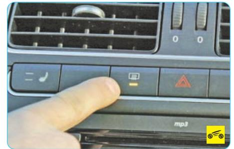
13 – выключатель обогрева заднего стекла. При нажатии на клавишу выключателя (двигатель должен работать) включается электрообогрев стекла, одновременно в клавише загорается контрольная лампа. При повторном нажатии на клавишу обогрев выключается, контрольная лампа гаснет.
