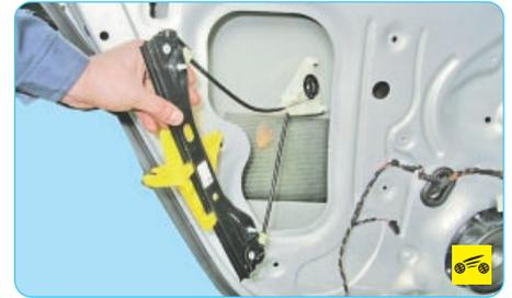
6. Снимите стеклоподъемник.
