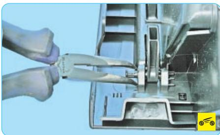
7. Для того чтобы снять крышку вещевого ящика, сожмите свободные концы осей петель крышки...
