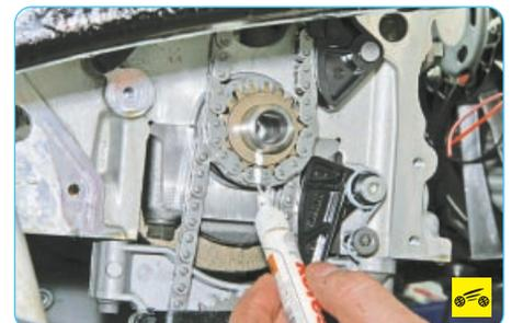
4. ...и звездочки коленчатого вала.
