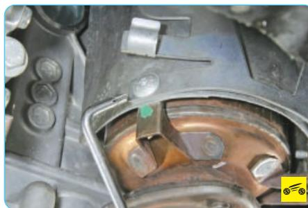
3. Выверните два винта крепления нижней части термоэкрана...
