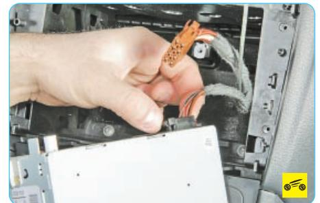
10. Отожмите фиксатор колодки жгута проводов...
