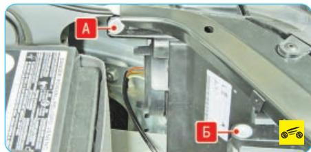
Так расположены винты регулировки света фар по горизонтали **Б** и вертикали **А** (показано на левой блок-фаре автомобиля).
