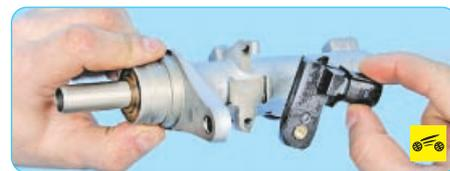
5. ...и снимите выключатель с главного тормозного цилиндра.
