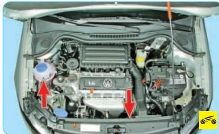
5. Внимательно осмотрите двигатель и подкапотное пространство. Обратите внимание на потеки бензина, масла, тормозной и охлаждающей жидкостей. Убедитесь в целостности электропроводки.
