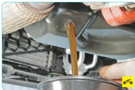
4. ...отверните пробку, предварительно подставив емкость для сливаемого масла, и слейте масло в подходящую емкость.
