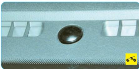
**В автоматическом режиме система отопления, вентиляции и кондиционирования работает с учетом информации, получаемой от фотодатчика, установленного на панели приборов. Никогда не загромождайте этот датчик посторонними предметами.**
