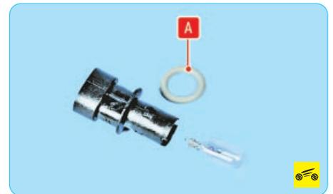
4. Установите новую лампу в патрон, а патрон в блок-фару. При необходимости замените резиновую уплотнительную прокладку **A**. Для замены лампы противотуманной фары выполните следующие операции.
