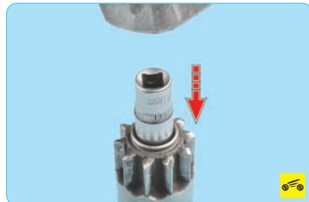
30. Сдвиньте по валу привода ограничительное кольцо с помощью оправки подходящего диаметра и молотка.
