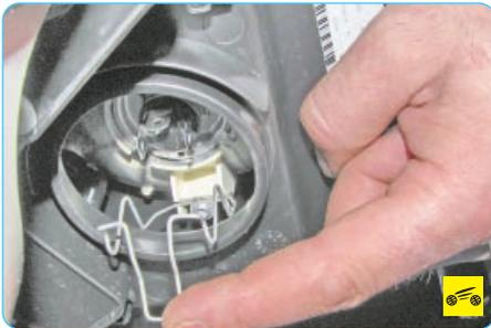
4. Выведите петлю пружинного фиксатора из паза на отражателе и опустите фиксатор.
