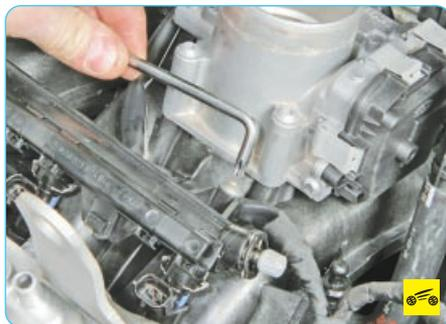
6. Выверните два винта крепления топливной рампы к головке блока цилиндров...
