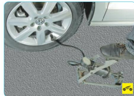
4. Если давление меньше требуемого, подсоедините наконечник шланга насоса к вентилю и подкачайте воздух, контролируя давление по манометру на насосе.
