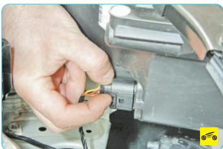
6. Отожмите фиксатор колодки жгута проводов электрокорректора света фар...
