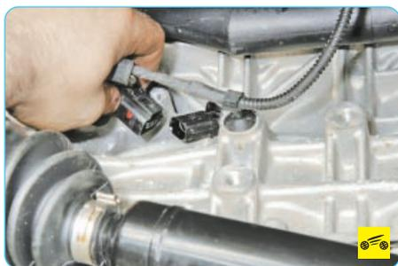
14. Нажмите на фиксатор колодки жгута проводов и отсоедините колодку от датчика детонации.
