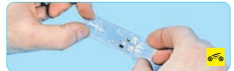
4. ...и выньте бесцокольную лампу (для наглядности показано на снятом фонаре освещения багажного отделения).
