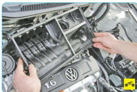
4. Снимите корпус воздушного фильтра и воздуховод (см. «Снятие и установка воздушного фильтра и воздухозаборника», с. 102).
