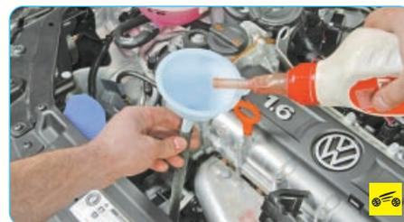
10. Установите в верхний конец шланга воронку и при работающем в режиме холостого хода двигателе заливайте рабочую жидкость до тех пор, пока она не начнет вытекать из контрольного отверстия.
