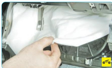
3. ...и шумоизоляционную прокладку (см. «Снятие и установка вещевого ящика», с. 240).
