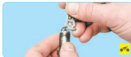
6. Если зазор не попадает в указанный интервал значений, отрегулируйте его, подгибая боковой электрод.
