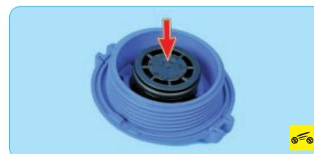
Поэтому раз в год промывайте пробку радиатора проточной водой, а клапан проверяйте
