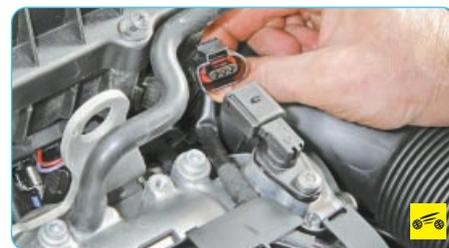
5. Отсоедините колодку жгута проводов от датчика положения распределительного вала.
