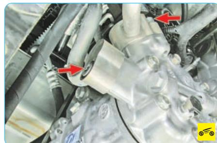
7. Выверните болты крепления фланцев трубопроводов высокого и низкого давления к корпусу компрессора и отсоедините трубопроводы.
