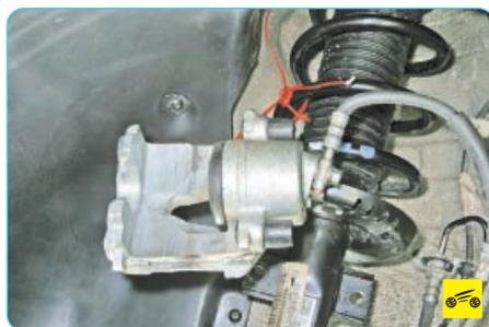
6. Снимите суппорт тормозного механизма переднего колеса, не отсоединяя от него тормозной шланг (см. «Замена суппорта тормозного механизма переднего колеса», с. 172), и закрепите проволокой на витках пружины амортизаторной стойки, не допуская натяжения и перегибов шланга.
