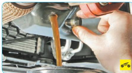
3. Слейте масло из системы смазки двигателя (см. «Замена масла в двигателе и масляного фильтра», с. 90).
