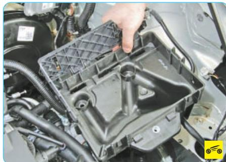
4. Снимите полку крепления аккумуляторной батареи (см. «Снятие и установка полки крепления аккумуляторной батареи», с. 243).
