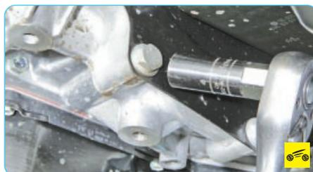
4. Выверните два болта крепления защитного щитка маховика (диска гидротрансформатора)...
