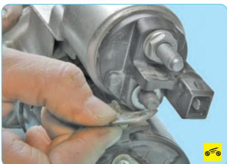
2. ...и отсоедините клемму провода щеточного узла от болта.
