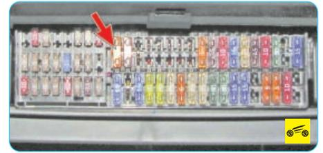
8. Замените предохранитель в монтажном блоке в панели приборов...
