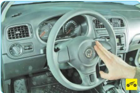
7. Проверьте исправность звукового сигнала.
