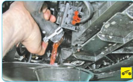
2. Слейте охлаждающую жидкость (см. «Замена охлаждающей жидкости», с. 94).
