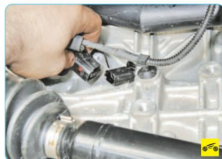
3. ...и отсоедините колодку от датчика детонации.
