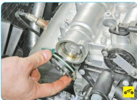
12. Снимите крышки распределительных валов (см. «Установка поршня первого цилиндра в положение ВМТ такта сжатия», с. 68).
