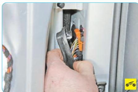
1. Поддев отверткой, отведите резиновый уплотнитель жгута проводов от стойки кузова.
