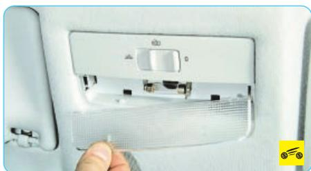
2. Поддев отверткой, снимите рассеиватель плафона освещения салона.
