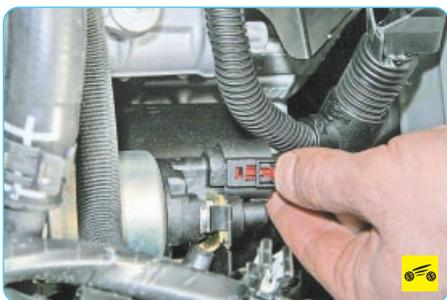
3. Нажмите на фиксатор колодки жгута проводов...
