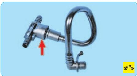
В шланге, соединяющем вакуумный усилитель с впускной трубой, установлен обратный клапан. Он удерживает разрежение в усилителе при его падении во впускной трубе и препятствует попаданию топливовоздушной смеси в вакуумный усилитель.
