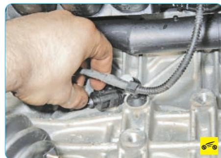
2. Отожмите фиксатор колодки жгута проводов...
