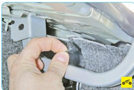
4. Извлеките пины крепления облицовок боковин багажника и снимите облицовки.
