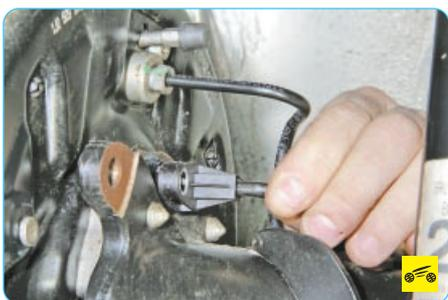
5. Выверните болт крепления датчика частоты вращения заднего колеса и извлеките датчик из отверстия продольного рычага задней подвески.
