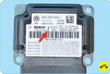
9. Установите блок управления дополнительной системой пассивной безопасности и все остальные детали в обратном порядке. Стрелка на этикетке блока управления, показывающая направление его установки, служит только для дополнительного контроля правильности установки, так как из-за асимметричного расположения отверстий для крепления блок можно установить только в одном положении.
