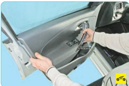
1. Поднимите стекло в крайнее верхнее положение и снимите обивку передней двери (см. «Снятие и установка обивки передней двери», с. 227).
