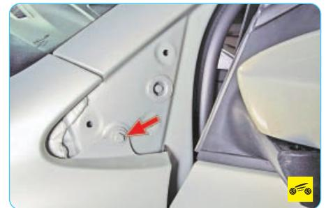
6. Выверните болт крепления крыла, расположенный под накладкой.
