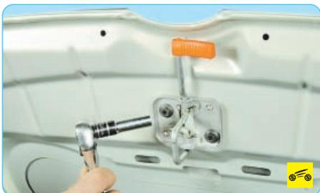
5. Выверните два болта крепления защелки замка к капоту...
