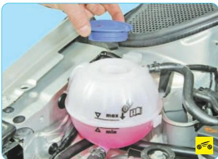
2. Отверните пробку расширительного бачка.
