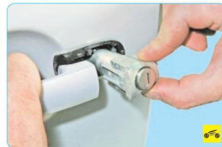
2. Снимите выключатель замка двери (см. «Замена выключателя замка передней двери», с. 229).
