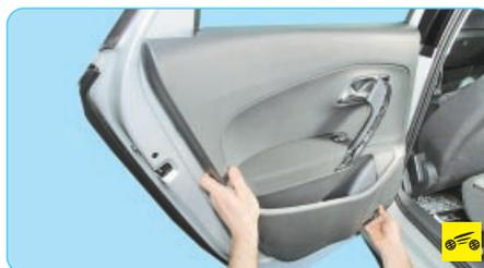
1. Поднимите стекло в крайнее верхнее положение и снимите обивку задней двери
