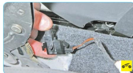
4. ...и снимите выключатель с рычага привода стояночного тормоза.
