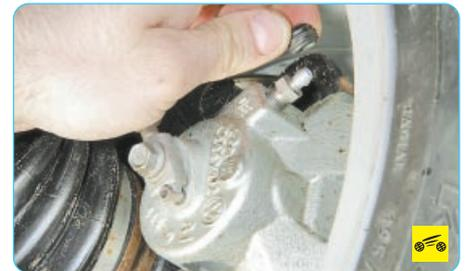
7. Снимите защитные колпачки и проверьте на отсутствие утечек клапаны для выпуска воздуха тормозных механизмов передних...
