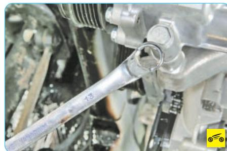
8. Выверните три болта крепления, извлеките их из монтажных отверстий...
