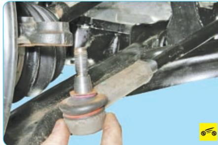
7. Отсоедините от поворотного кулака -конечник рулевой тяги (см. «Замена наружного наконечника рулевой тяги», с. 156).
