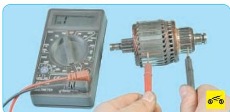
20. Проверьте омметром каждую обмотку ротора на короткое замыкание с корпусом ротора. Сопротивление должно стремиться к бесконечности. Если нет, замените ротор.
