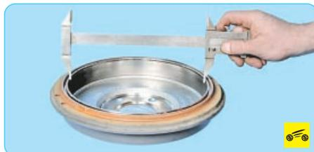
5. Измерьте штангенциркулем диаметр рабочей поверхности. Если он больше максимально допустимого значения, барабан подлежит замене (см. «Проверка степени износа тормозных колодок, дисков и барабанов», с. 162).
