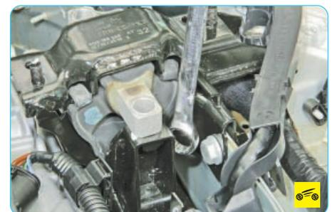
6. Выверните два болта бокового крепления левой опоры подвески силового агрегата к отбортовке лонжерона кузова...
