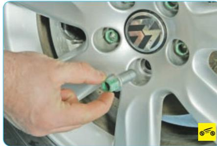
10. Поднимите домкратом автомобиль так, чтобы колесо оторвалось от дороги, после чего полностью выверните болты...
