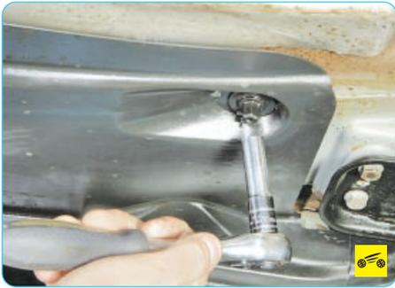
4. Отверните семь пластмассовых гаек крепления защитного кожуха...
