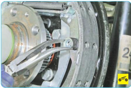
6. Придерживая опорную стойку, нажмите на чашку крепления прижимной пружины, поверните ее на четверть оборота...
