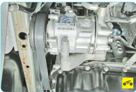
**Компрессор** установлен на блоке цилиндров двигателя и приводится во вращение поликлиновым ремнем. Компрессор обеспечивает циркуляцию хладагента в системе. Вал компрессора установлен в алюминиевой передней крышке корпуса на подшипниках и уплотнен со стороны шкива привода сальником.
