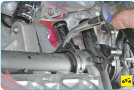
8. Захватите пассатижами фиксирующую пластину водораспределителя и трубы водяного насоса...
