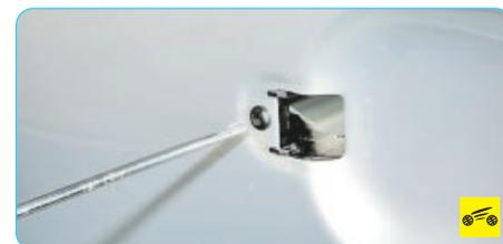
4. Выверните винт крепления кронштейна наружной ручки...
