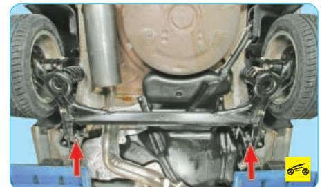
3. Проверьте с помощью монтажной лопатки состояние шарниров (сайлентблоков) рычагов задней подвески. Упираясь монтажной лопаткой в кронштейн кузова, попытайтесь покачать рычаг подвески. Если есть люфты в шарнире, замените резино-металлический шарнир (сайлентблок).
