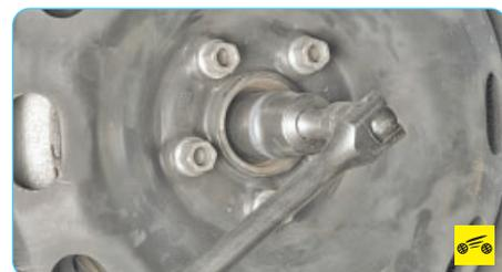
3. Если на автомобиль установлены стальные штампованные колесные диски, снимите декоративный колпак колеса, ослабьте затяжку гайки передней ступицы...
