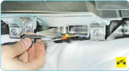
5. Подденьте отверткой и опустите вниз фиксатор колодки жгута проводов модуля подушки безопасности переднего пассажира...
