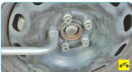
2. На стоящем на земле автомобиле ослабьте затяжку болтов крепления колеса...
