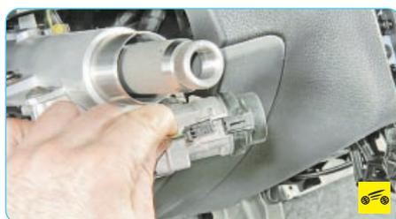
8. ...и отсоедините колодку (для наглядности показано со снятым блоком подрулевых переключателей).
