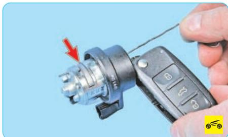
Так выглядит стопорный рычаг в разблокированном положении (для наглядности показано на снятом цилиндре замка).
