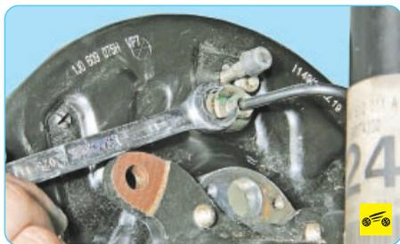
7. Отверните гайку крепления тормозной трубки к рабочему цилиндру, сдвиньте гайку по трубопроводу, отсоедините трубку и заглушите ее отверстие, например, колпачком клапана выпуска воздуха.
