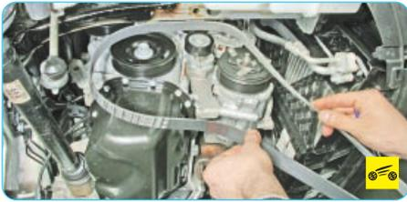
7. ...со шкивов компрессора кондиционера, генератора и коленчатого вала.
