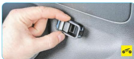
6. ...и извлеките выключатель из проема обивки передней двери.
