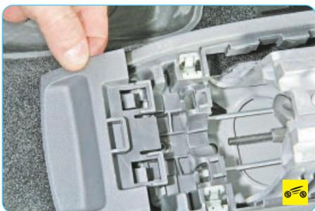
13. ...и снимите заднюю накладку облицовки тоннеля пола.
