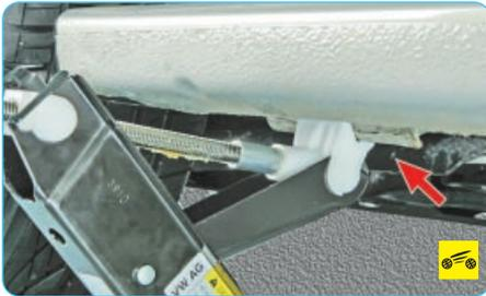
В месте установки домкрата на пороге сделано ребро, на которое должна попасть про- резь лапы домкрата.
