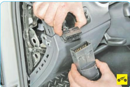
5. Отожмите фиксаторы и отсоедините колодку жгута проводов от блока управления наружным освещением.
