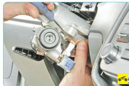
9. Отожмите фиксатор колодки жгута проводов датчика положения ключа в замке зажигания...
