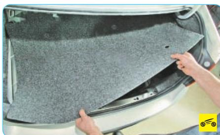
3. Снимите покрытие пола.
