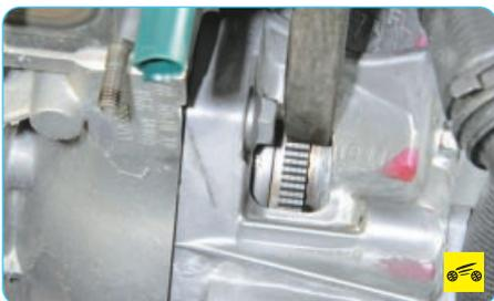
6. Удерживая коленчатый вал от проворачивания монтажной лопаткой за маховик, как показано на фото...
