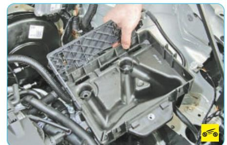
4. Снимите полку крепления аккумуляторной батареи (см. «Снятие и установка полки крепления аккумуляторной батареи», с. 243).
