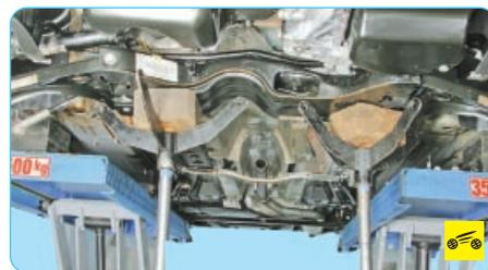
8. Установите опору (домкрат) под поперечину передней подвески.
