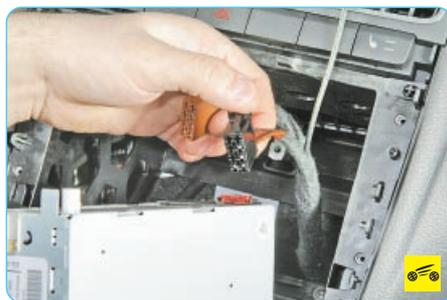
9. ...и верхнюю колодку жгутов проводов от разъемов головного устройства аудиосистемы и снимите устройство.
