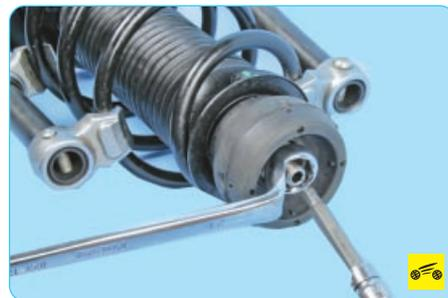
3. Удерживая шток амортизатора от проворачивания, ослабьте затяжку гайки штока амортизаторной стойки...
