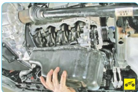
1. Снимите масляный картер (см. «Замена уплотнения масляного картера двигателя», с. 74).
