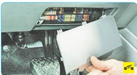
1. Подденьте край декоративной крышки и, преодолевая сопротивление фиксаторов, снимите ее.
