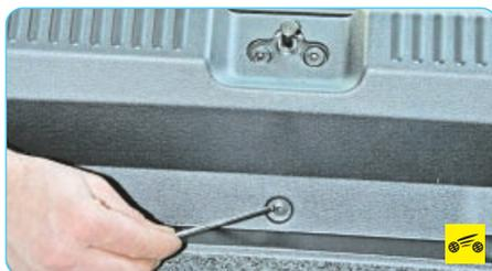
1. Выверните винт крепления облицовки панели задка и, преодолевая сопротивление пластмассовых фиксаторов...
