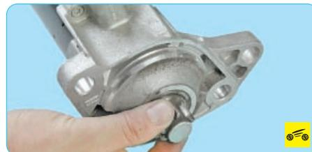
1. Рукой проверьте легкость перемещения муфты привода вдоль вала и легкость проворачивания шестерни. Она должна без усилия проворачиваться против часовой стрелки и с усилием – в противоположном направлении.
