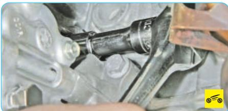
4. Выверните болт крепления автоматического натяжителя ремня привода вспомогательных агрегатов к кронштейну компрессора кондиционера со стороны катколлектора...
