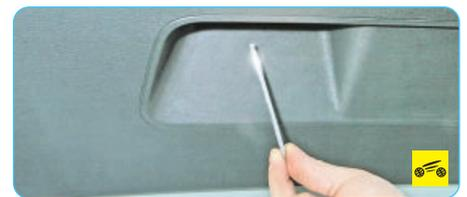
1. Выверните два винта крепления обивки к крышке багажника...
