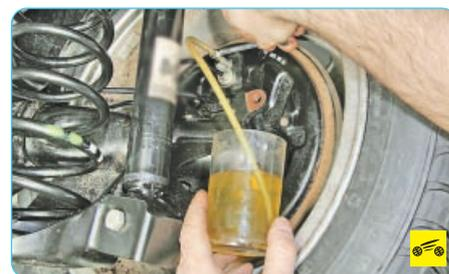
7. Отверните на 1/2–3/4 оборота клапан выпуска воздуха. Из шланга начнет вытекать старая (грязная) тормозная жидкость. Педаль тормоза в это время должна плавно дойти до упора. Как только жидкость перестанет вытекать, заверните клапан выпуска воздуха.
