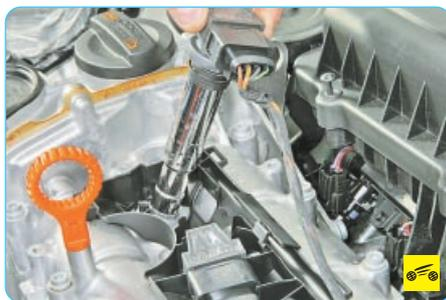
5. Снимите катушку зажигания с наконечника свечи и извлеките из свечного колодца.
