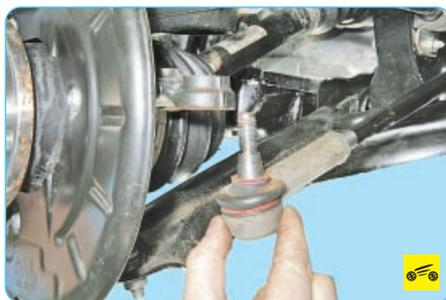
5. Отсоедините рулевые тяги от поворотных кулаков (см. «Замена наружного наконечника рулевой тяги», с. 156).
