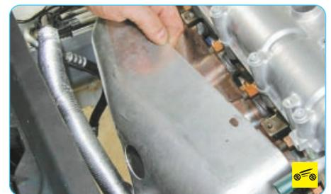
6. ...и снимите термоэкран катколлектора.
