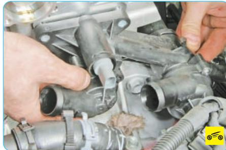
10. Выверните болты крепления и отведите от головки блока цилиндров корпус термостата, не отсоединяя шлангов системы охлаждения двигателя (см. «Замена термостатов», с. 97).
