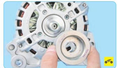
10. ...и снимите шкив с вала генератора.
