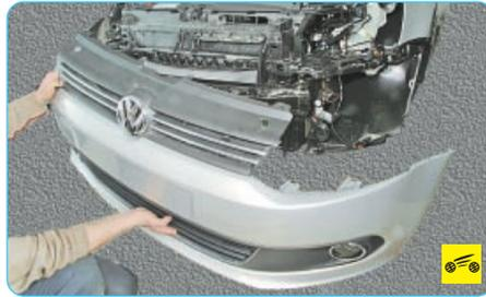
3. Снимите передний бампер (см. «Снятие и установка переднего бампера», с. 222).
