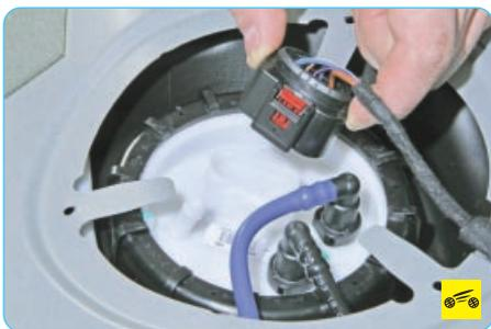
10. ...и отсоедините колодку жгута проводов от топливного модуля.
