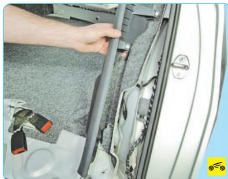
4. Снимите нижнюю облицовку задней стойки кузова (см. «Снятие и установка облицовок салона», с. 242).
