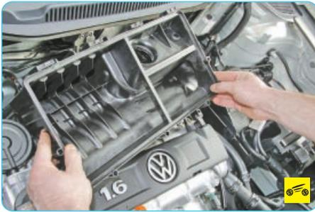
11. Преодолевая сопротивление фиксаторов, снимите корпус воздушного фильтра.
