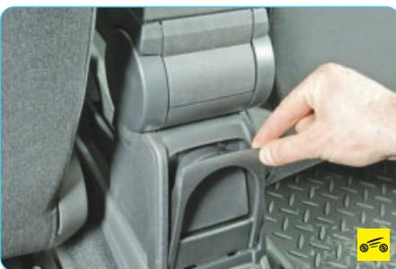
Для пользования подстаканником, установленным в заднем торце облицовки тоннеля пола, потяните за верхний край подстаканника...
