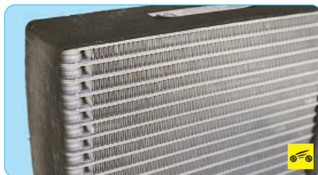
Испаритель расположен в блоке системы отопления и кондиционирования салона. Испаритель изготовлен из алюминиевых трубок с наружным оребрением для улучшения теплообмена. Проходя по трубкам испарителя, кипящий хладагент активно поглощает тепло
