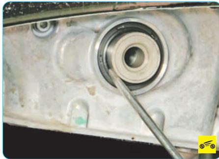
10. Поддев отверткой, извлеките сальник из крышки цепи привода газораспределительного механизма.
