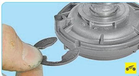
34. Снимите с вала привода стопорное и упорные кольца.
