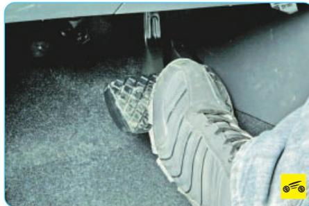
12. Перед поездкой обязательно проверьте на неподвижном автомобиле работу тормозной системы, нажав на педаль тормоза (показано на автомобиле с АКП). Если педаль без сопротивления «провалилась» до пола, значит, тормозная система неисправна. Эксплуатация такого автомобиля запрещена.
