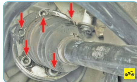
7. На автомобиле с механической коробкой передач проверьте затяжку шести болтов (один болт на фото закрыт чехлом шарнира) крепления внутреннего шарнира к полуосевой фланцу. Ослабленные болты подтяните или замените, если затяжка болтов ослабевает после небольшого пробега автомобиля.
