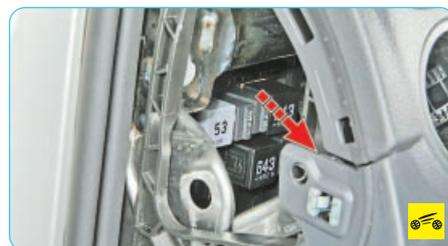
4. Покачивая реле из стороны в сторону, извлеките его из контактного разъема.
