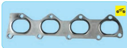
Прокладку катколлектора заменяйте новой при каждой разборке соединения.
