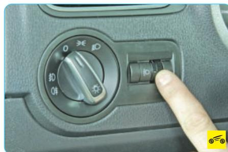
Вращением рукоятки регулятора корректора света фар изменяют (в зависимости от загрузки автомобиля) угол наклона пучка света
