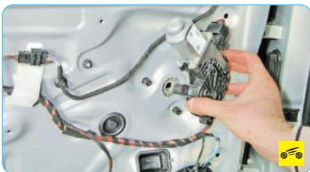
3. Снимите моторредуктор стеклоподъемника (см. «Замена моторредуктора стеклоподъемника передней двери», с. 212).
