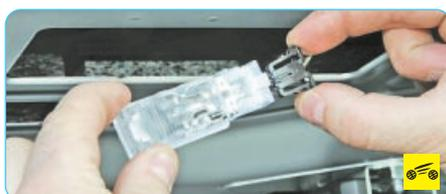
4. Нажмите на фиксаторы, отсоедините колодку жгута проводов и снимите плафон.
