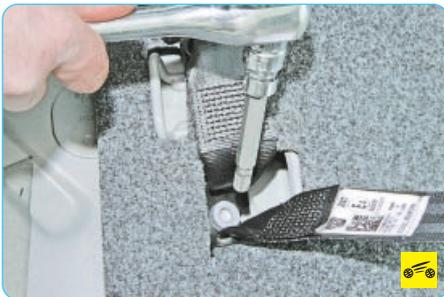
3. Выверните болт нижнего крепления заднего центрального ремня безопасности...
