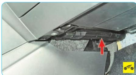
Салонный фильтр установлен под панелью приборов над правой стороной облицовки тоннеля пола, в отсеке, закрытом крышкой.
