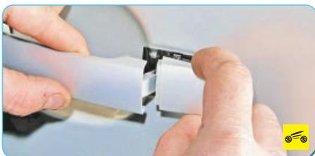
4. ...и, оттянув ручку на себя, снимите крышку ручки.
