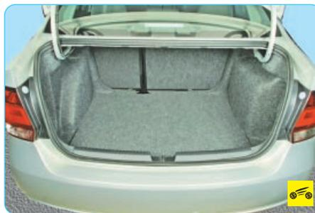
Стенки багажника облицованы формованными обивками, а на пол уложена жесткая, обитая ворсовым материалом крышка.
