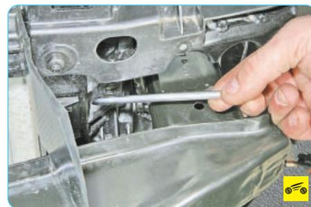
18. Выверните четыре винта крепления радиатора к кузову..
