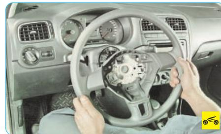
7. Снимите рулевое колесо.
