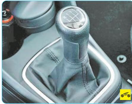
Механической коробкой передач управляйте согласно схеме переключений, нанесенной на рукоятку ее рычага. В нейтральном положении рычаг автоматически устанавливается в положение для включения III или IV передачи, из которого его можно переместить соответственно вперед или назад. Для включения I или II передачи переместите рычаг влево до упора и затем соответственно вперед или назад. Для включения V передачи переместите рычаг вправо до упора и вперед.
