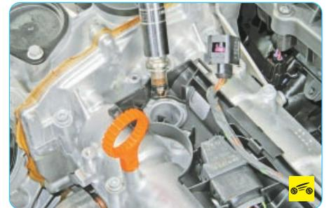
6. Выверните свечу зажигания 1-го цилиндра (см. «Замена и обслуживание свечей зажигания», с. 194).
