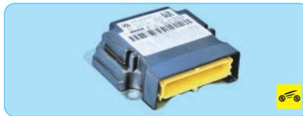
– электронный блок управления, установленный под консолью панели приборов и управляющий системой;
