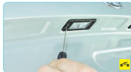
2. Подденьте отверткой плафон фонаря освещения номерного знака...
