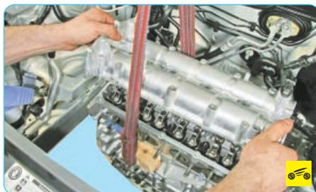
1. Снимите корпус распределительных валов с блока цилиндров (см. «Замена прокладок корпуса распределительных валов», с. 76).
