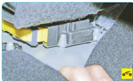
3. Отогните край напольного покрытия.
