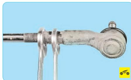
6. Ослабьте затяжку контргайки наконечника рулевой тяги, удерживая наконечник.
