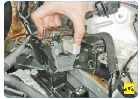
48. ...и левую опоры подвески силового агрегата (см. «Замена опор подвески силового агрегата», с. 72).
