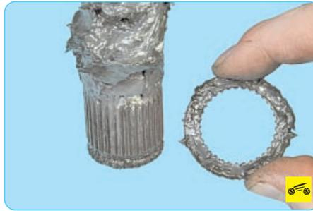
11. Снимите упорную шайбу.
