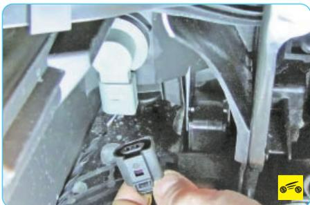
4. ...и отсоедините колодку жгута проводов от лампы указателя поворота.
