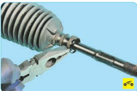
4. ...сдвиньте его вдоль рулевой тяги и снимите.
