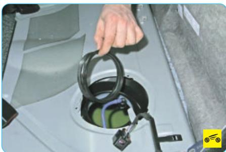
14. Снимите резиновую прокладку топливного модуля.
