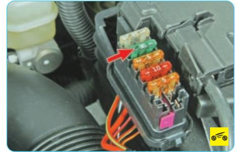
9. ...или в монтажном блоке предохранителей и реле, установленном в подкапотном пространстве. Если после замены предохранителей вентилятор не начал работать, проверьте электродвигатель, для чего возьмите два дополнительных провода и подайте на него питание непосредственно от аккумуляторной батареи. Провода должны быть надежно закреплены и изолированы.
