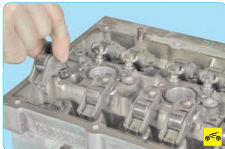
3. Снимите коромысла и гидрокомпенсаторы клапанов.
