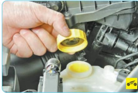
2. Если уровень жидкости ниже метки «MIN», отверните пробку бачка...
