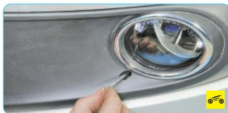
Вставьте в отверстие декоративной накладке противотуманной фары ключ TORX T25 и, вращая регулировочный винт, добейтесь, чтобы верхние границы световых пятен находились на линии **С** (рис. 10.7) или чуть ниже.
