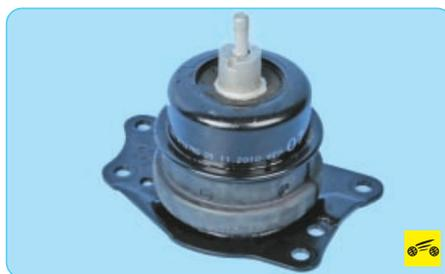
10. Установите правую опору подвески силового агрегата и кронштейн ее крепления в обратном порядке с учетом следующего:
