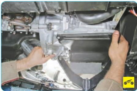
27. ...и, опустив под коробкой опору, снимите коробку передач.
