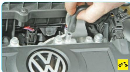
5. Снимите со штуцера корпуса распределительных валов шланг системы вентиляции картера.
