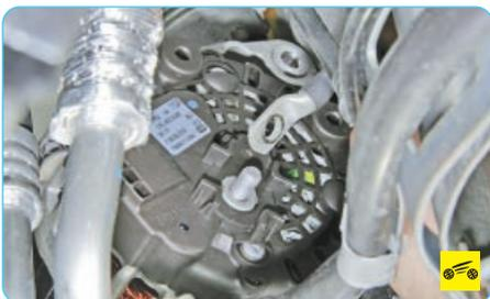
41. ...отсоедините клемму силового провода от шпильки генератора и отведите провод в сторону.
