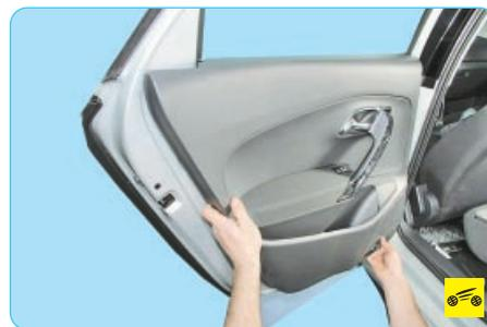
1. Снимите обивку задней двери (см. «Снятие и установка обивки задней двери», с. 231).
