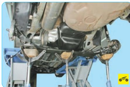
18. Снимите балку задней подвески с автомобиля.
