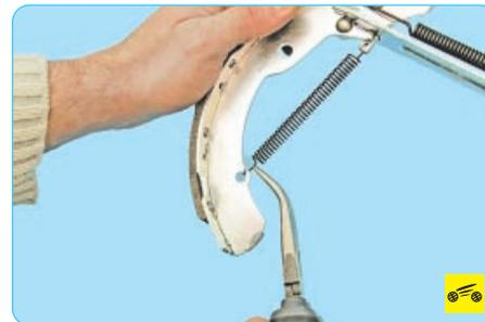
20. Выведите отогнутый конец пружины механизма регулировки зазоров из отверстия в ребре передней колодки...
