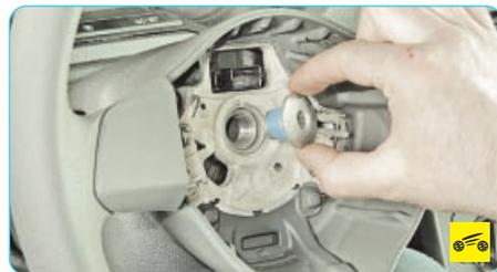
6. Окончательно выверните болт крепления рулевого колеса.
