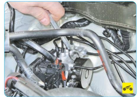
5. Ослабьте затяжку гаек шести трубок гидросистемы, присоединенных к гидроэлектронному блоку.
