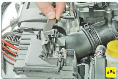
4. Отстегните крышку гайки клеммы «плюс» аккумуляторной батареи...
