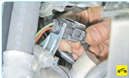
3. Нажмите на фиксатор колодки жгута проводов электромагнитной муфты включения компрессора...
