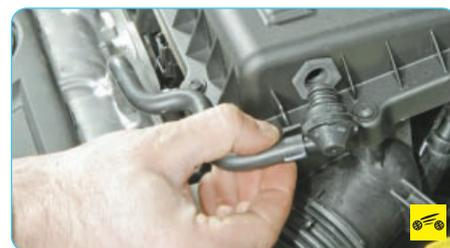
2. Извлеките обратный клапан шланга системы вентиляции картера из отверстия в крышке воздушного фильтра...
