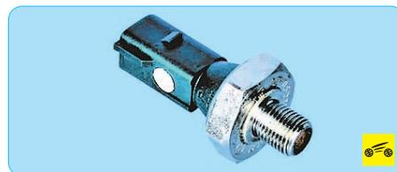
6. Установите датчик сигнальной лампы аварийного падения давления масла в порядке, обратном снятию.
