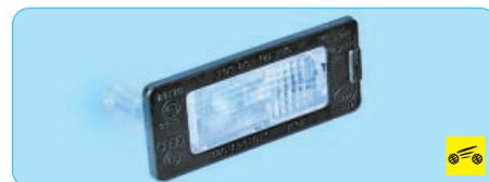
6. Установите фонари освещения номерного знака в порядке, обратном снятию.
