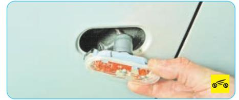
4. Снимите фонарь бокового указателя поворота (см. «Замена фонаря бокового указателя поворота», с. 206).
