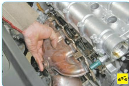
6. ...и снимите катколлектор и его прокладку.
