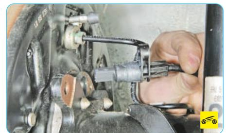
9. ...и извлеките датчик из отверстия фланца.
