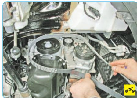
6. Снимите ремень привода вспомогательных агрегатов (см. «Снятие и установка ремня привода вспомогательных агрегатов», с. 70).
