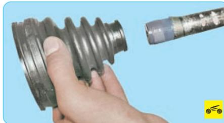
Для того чтобы при сборке не повредить чехол шарнира, оберните шлицевую часть вала изоляционной лентой.
