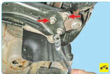
4. Отверните три гайки крепления шаровой опоры к рычагу передней подвески...
