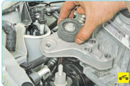
7. Снимите кронштейн правой опоры подвески силового агрегата.
