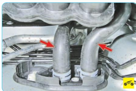
Радиатор отопителя объединен с системой охлаждения двигателя двумя шлангами, проходящими в моторном отсеке.
