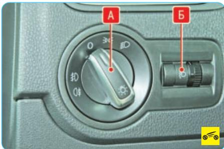
**32 – блок управления наружным освещением.** В блоке установлены центральный переключатель А света и корректор Б света фар.
