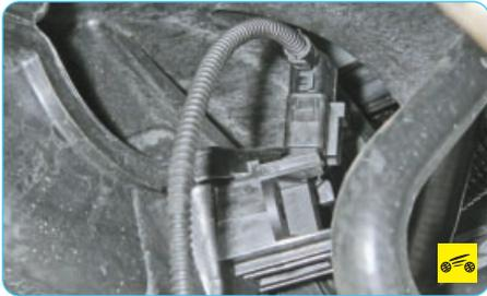
– комбинированного датчика абсолютного давления (разрежения во впускной трубе) и температуры воздуха на впуске – увеличение расхода топлива, значительное ухудшение динамики, проблемы с пуском двигателя, увеличение уровня токсичности отработавших газов;
