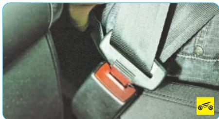
...и вставьте язычок пряжки в замок до щелчка, не допуская скручивания лямок.
