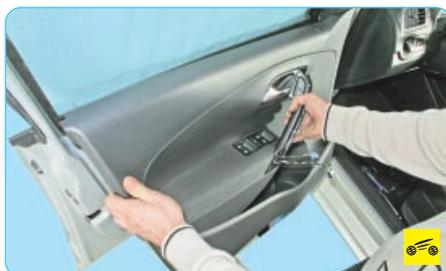
2. Снимите обивку передней двери (см. «Снятие и установка обивки передней двери», с. 227).
