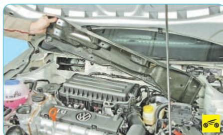
3. Снимите короб воздухопритока (см. «Снятие и установка решетки и короба воздухопритока», с. 226).
