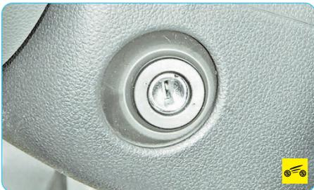
Для коммутации основных цепей автомобиля служит комбинированный выключатель (замок) зажигания, состоящий из контактной части и механического противоугонного устройства с замком.
