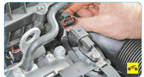
6. Отсоедините колодку жгута проводов от датчика положения распределительного вала.
