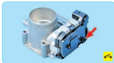
Датчик положения дроссельной заслонки встроен в крышку дроссельного узла и может быть заменен только в сборе с дроссельным узлом (см. «Снятие и установка дроссельного узла», с. 107).
