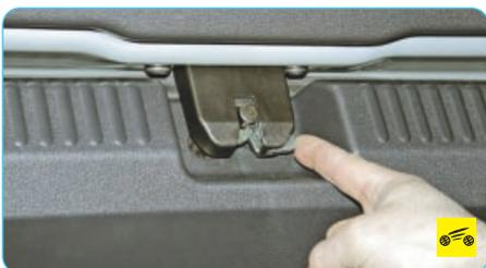
...и, получив доступ в багажник через открытый проем, нажмите на рычаг аварийного разблокирования замка.
