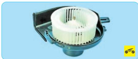
9. Установите электродвигатель с крыльчаткой в сборе в корпус воздуханасветателя, а также все детали в порядке, обратном снятию.
