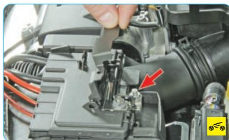
3. Если и при нормальном натяжении ремня сигнальная лампа все равно горит, проверьте провода, подсоединенные к «плюсовой» клемме аккумуляторной батареи...
