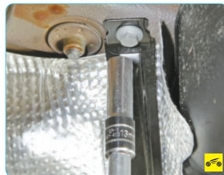
20. Выверните четыре болта хомутов крепления топливного бака к кузову...
