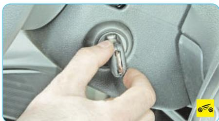
При повороте ключа в выключателе (замке) зажигания в положение «II» напряжение от аккумуляторной батареи подается на втягивающую и удерживающую обмотки тягового реле, якорь которого перемещает рычаг привода, и шестерня муфты привода стартера входит в зацепление с зубчатым венцом маховика двигателя. Одновременно якорь тягового реле замыкает силовые контакты (в этот момент
