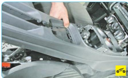
5. Снимите облицовку тоннеля пола (см. «Снятие и установка облицовок тоннеля пола и консоли панели приборов», с. 238).
