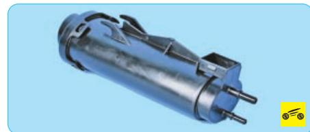
Адсорбер системы улавливания паров топлива снимают для проверки или замены при появлении стойкого запаха бензина, вызванного негерметичностью адсорбера. Кроме того, нарушение герметичности адсорбера может стать причиной неустойчивой работы двигателя на холостом ходу вплоть до его остановки.
