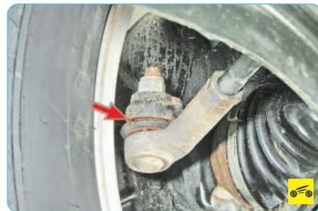
1. Проверьте состояние защитных чехлов наконечников рулевых тяг. Замените порванные, потрескавшиеся или потерявшие эластичность чехлы.
