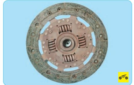
5. Осмотрите ведомый диск сцепления. Трещины на деталях ведомого диска не допускаются.
