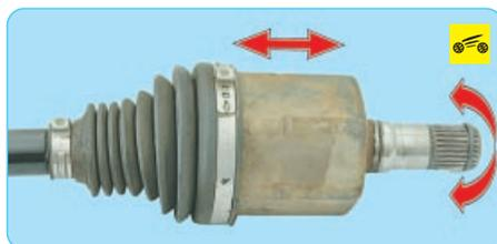
...или Трипод должен перемещаться в угловых и осевых направлениях с легким усилием, при этом не должно ощущаться рывков, заеданий и радиальных люфтов. В противном случае замените внутренний шарнир;
