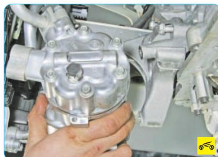
7. Снимите компрессор кондиционера, не отсоединяя от него трубопроводов, и закрепите компрессор на кузове (см. «Снятие и установка компрессора кондиционера», с. 257).
