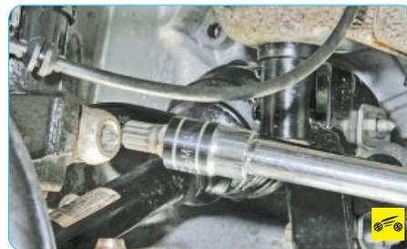
9. Удерживая от проворачивания головку стяжного болта, отверните гайку крепления поворотного кулака к амортизаторной стойке и извлеките болт.
