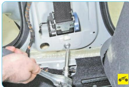
13. Выверните болт крепления инерционной катушки ремня безопасности...
