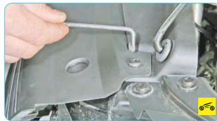
10. Выверните два винта крепления облицовки радиатора к кузову.
