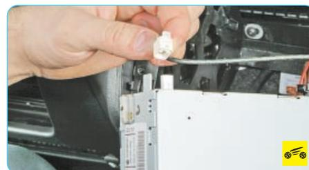
7. ...отсоедините наконечник провода антенны от головного устройства аудиосистемы.
