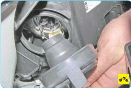
3. Подденьте уплотнитель лампы и снимите его.
