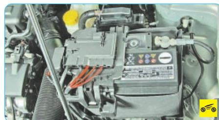
Завод-изготовитель устанавливает на автомобиле необслуживаемую аккумуляторную батарею номинальным напряжением 12 В, емкостью 60 А·ч. Элементы батареи расположены в полипропиленовом моноблоке и закрыты
