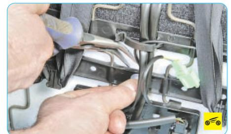
19. Сожмите пассатижами ушки фиксатора провода сигнальной лампы непристегнутого ремня безопасности и извлеките фиксатор из отверстия в сиденье.
