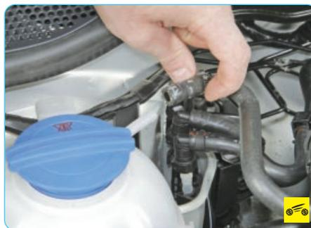
3. ...и снимите пароотводящую трубку со штуцера расширительного бачка.
