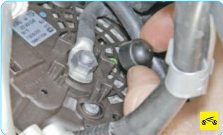
39. Снимите защитный колпачок гайки силового провода.
