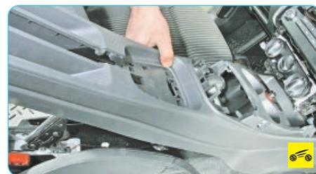
2. Снимите облицовку тоннеля пола (см. «Снятие и установка облицовок тоннеля пола и консоли панели приборов», с. 238).
