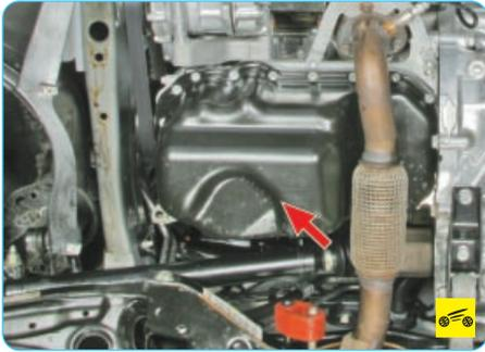
2. Загляните под переднюю часть автомобиля – не пробит ли масляный картер двигателя, нет ли там течи.
