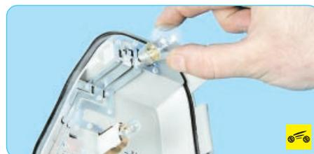
5. Нажмите на лампу стоп-сигнала, поверните ее против часовой стрелки...
