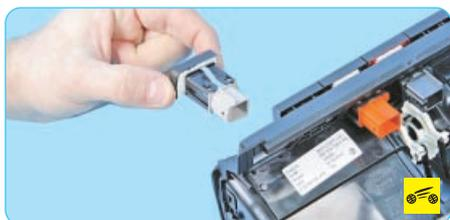
9. ...и снимите выключатель. Аналогично снимите второй выключатель обогрева переднего сиденья, выключатели аварийной сигнализации и обогрева заднего стекла.
