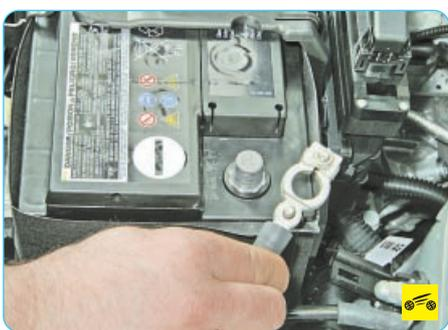
1. Отсоедините провод от клеммы «минус» аккумуляторной батареи.
