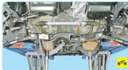
11. Установите опору (домкрат) под поперечину передней подвески, выверните болты крепления поперечины к кузову и опустите, насколько это возможно, поперечину вниз.
