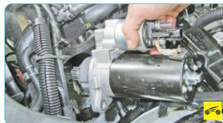
13. ...и снимите стартер с автомобиля.
