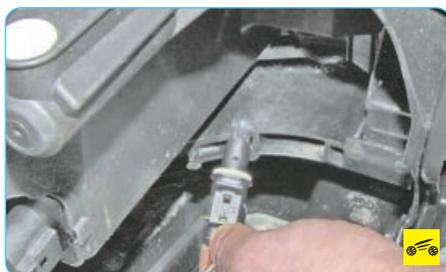
5. Извлеките патрон лампы переднего габаритного огня из отверстия блок-фары.
