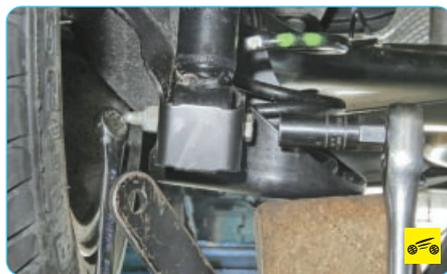
6. Отверните гайку болта нижнего крепления амортизатора к кронштейну рычага...
