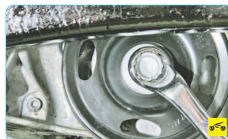
12. ...выверните болт крепления шкива, извлеките болт из отверстия...
