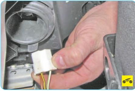
2. Подденьте колодку жгута проводов лампы ближнего/дальнего света фары и отсоедините колодку от лампы.
