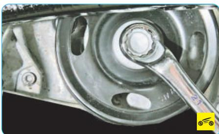
10. Проворачивайте коленчатый вал двигателя за болт крепления к нему шкива ремня привода вспомогательных агрегатов до установки поршня 1-го цилиндра в положение ВМТ, при этом следите за показаниями маленькой стрелки индикатора, которая должна остановиться на максимальном значении.
