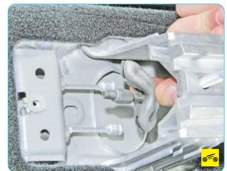
1. Отсоедините уравниватель от передних концов задних тросов (см. пп. 4–6 «Снятие и установка рычага привода стояночного тормоза», с. 177).
