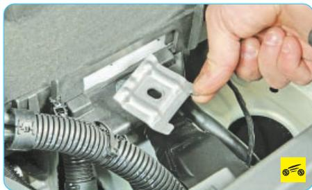
8. ...и снимите пластину.
