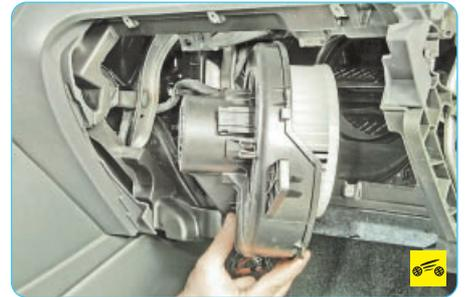
4. Снимите воздуходуватель.
