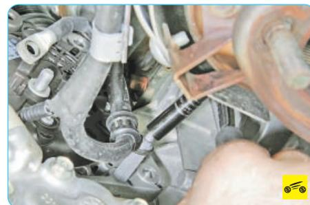
8. Отверните гайку крепления держателя жгута проводов...
