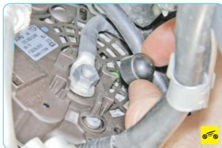
4. Снимите защитный колпачок гайки силового провода.
