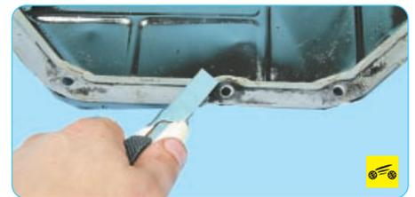
8. Очистите от старого герметика сопрягаемые поверхности масляного картера ...
