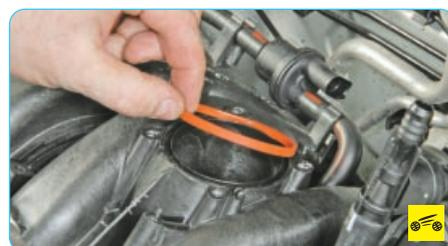
6. Снимите прокладку дроссельного узла.
