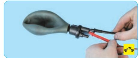
6. Наденьте на штуцер клапана сжатую резиновую грушу. Поскольку в нормальном состоянии клапан закрыт, в груше должно сохраняться созданное разрежение. Затем подайте на контакты клапана напряжение 12 В, клапан откроется и груша наполнится воздухом. В противном случае замените клапан новым.
