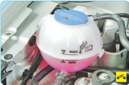
5. Проверьте уровень охлаждающей жидкости в расширительном бачке. При необходимости доведите его до нормы.
