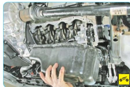
10. Снимите масляный картер двигателя (см. «Замена уплотнения масляного картера двигателя», с. 74).
