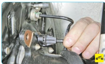
3. Выверните болт крепления датчика частоты вращения заднего колеса и извлеките датчик из отверстия продольного рычага задней подвески. Аналогично извлеките из отверстия продольного рычага задней подвески датчик вращения второго колеса.
