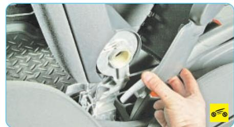
3. ...и облицовку шарнира подлокотника (см. «Снятие и установка облицовок тоннеля пола и консоли панели приборов», с. 238).
