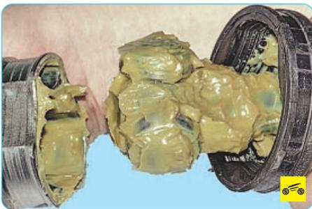
30. Отсоедините от привода корпус внутреннего шарнира.
