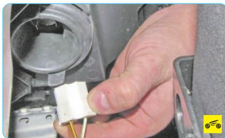
3. Подденьте колодку жгута проводов лампы ближнего/дальнего света фары и отсоедините колодку от лампы.
