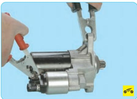
3. Отсоедините провод от управляющего вывода тягового реле и подсоедините к контактному болту тягового реле с плетеным проводом. Вал привода стартера должен начать вращаться с частотой более 2000 мин<sup>-1</sup>. В противном случае отремонтируйте стартер.
