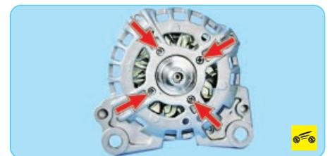
11. Выверните четыре винта крепления прижимной пластины переднего подшипника.
