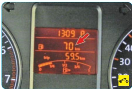
В режиме **отображения расстояния, которое можно проехать на остатке топлива в баке**, выводится примерное расстояние, которое можно проехать на остатке топлива в баке с учетом средней скорости движения и текущего расхода топлива. Это расстояние повторно рассчитывается и обновляется каждую секунду.
