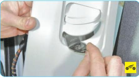
6. ...проденьте пряжку ремня безопасности через прорезь верхней облицовки центральной стойки и снимите облицовку.
