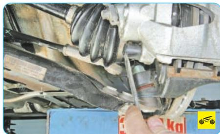
3. Поддев отверткой крышки защитных втулок обоих направляющих пальцев...
