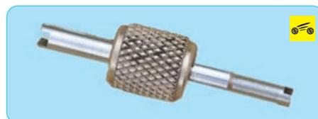
Для выворачивания и вворачивания золотников используется специальный ключ.
