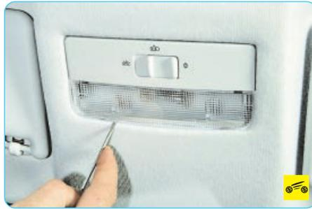
1. Подденьте отверткой рассеиватель плафона общего освещения...
