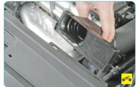
4. Снимите воздухоподводящий рукав (см. «Снятие и установка воздушного фильтра и воздухозаборника», с. 102).
