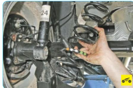
7. Опустите балку задней подвески и снимите пружины в сборе с их верхними прокладками.
