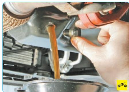
9. Слейте масло из системы смазки двигателя (см. «Замена масла в двигателе и масляного фильтра», с. 90).
