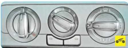
**Панель блока управления** системой вентиляции, кондиционирования и отопления автомобиля установлена на консоли панели приборов.
