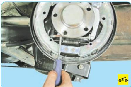
10. Преодолевая сопротивление нижней стяжной пружины, отожмите отверткой переднюю колодку вперед...
