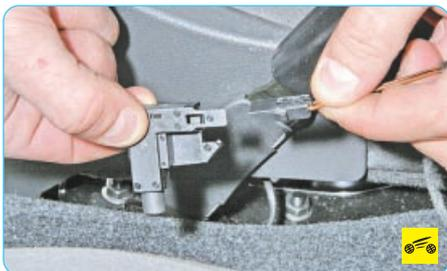
6. ...отсоедините колодку и снимите выключатель.
