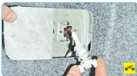
3. Выверните фиксатор заднего фонаря и извлеките фиксатор из отверстия в кузове.
