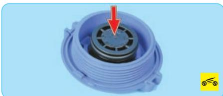
Поэтому раз в год промывайте пробку расширительного бачка проточной водой, а также периодически проверяйте подвижность штока выпускного клапана, нажав на тарелку клапана пальцем. Если появились сомнения, замените пробку. Очевидно, что если на перегретом двигателе снять пробку радиатора и по времени это действие совпадет с тепловым ударом, то вскипание жидкости и образование воздушных пробок в системе охлаждения будет гарантировано.
