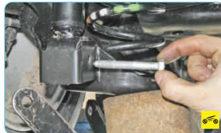
6. Отверните гайку болта нижнего крепления амортизатора к кронштейну рычага и извлеките болт. Аналогично извлеките болт нижнего крепления амортизатора с другой стороны.
