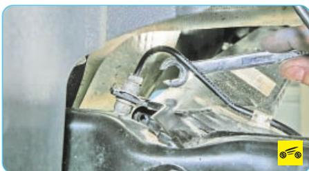
2. Отверните гайку крепления наконечника тормозной трубки к наконечнику тормозного шланга на кронштейне рычага балки задней подвески...
