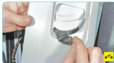
8. ...и, продев ремень в отверстие верхней облицовки центральной стойки, снимите облицовку.
