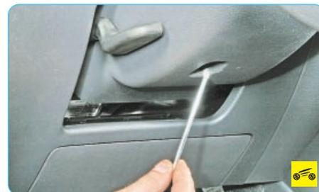
1. Выверните стяжной винт частей кожуха рулевой колонки.
