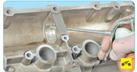
20. Перед установкой распределительных валов смажьте рабочие поверхности подшипников в корпусе.
