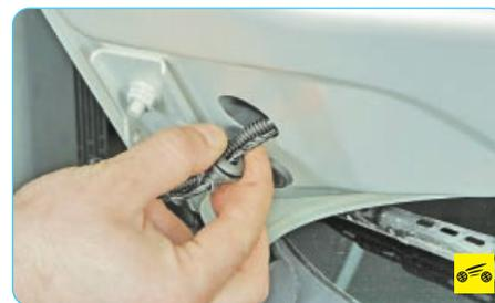
9. Извлеките трубку подачи омывающей жидкости и жгут проводов из отверстия во внутренней панели капота.
