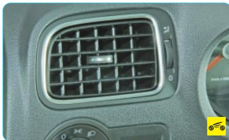
**5, 18** – боковые сопла системы отопления (кондиционирования) и вентиляции салона. Соплами регулируют направление и интенсивность потоков воздуха, см. «Отопление (кондиционирование) и вентиляция салона», с. 22.
