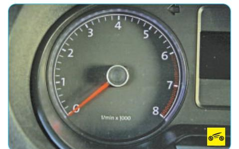
**1 – тахометр** электронного типа. Показывает частоту вращения коленчатого вала двигателя. Шкала имеет деления от 0 до 8, цена деления 0,2. Чтобы узнать частоту вращения коленчатого вала в мин<sup>-1</sup>, нужно показания тахометра умножить на 1000. Красная зона шкалы означает опасный режим работы двигателя.
