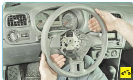
5. Резкими ударами рук сбейте рулевое колесо со шлицев рулевого вала.
