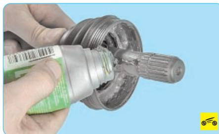
14. Перед установкой нового наружного шарнира заполните его полость смазкой (если шарнир не был смазан изготовителем) в количестве около 100 г. Причем в шарнир заложите 40 г, а в чехол – остальную смазку.
