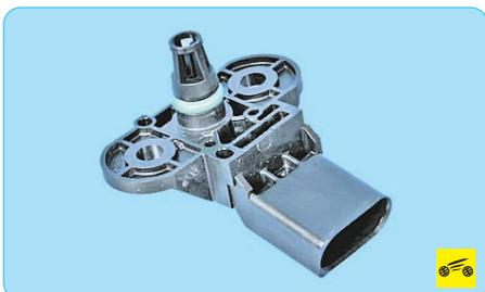
5. Установите датчик абсолютного давления в порядке, обратном снятию.
