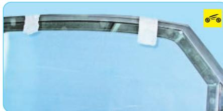
2. Извлеките распорную планку крепления обоймы стекла к стеклоподъемнику (см. «Замена стекла задней двери», с. 233) и закрепите стекло в оконном проеме (например, малярным скотчем).
