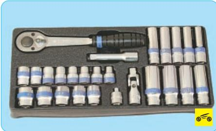
– при работах с труднодоступными узлами и агрегатами необходим набор торцовых ключей с воротком-трещоткой и карданным шарниром;
