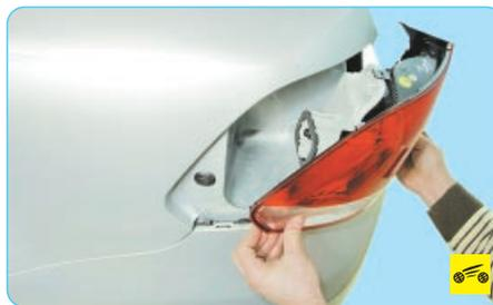
6. Преодолевая сопротивление фиксаторов, сдвиньте задний фонарь назад и снимите его с автомобиля.
