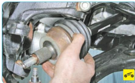
45. Снимите приводы колес (см. «Снятие и установка приводов колес», с. 130).
