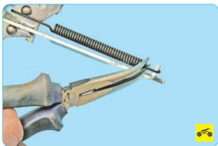
22. Отсоедините отогнутый конец оттяжной пружины от отогнутого уса распорной планки...
