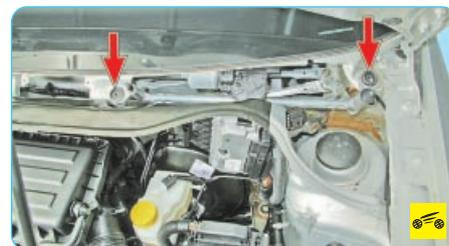
Так расположены болты крепления трапеции стеклоочистителя.
