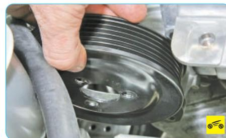
14. Снимите шкив водяного насоса (см. «Замена водяного насоса», с. 97).
