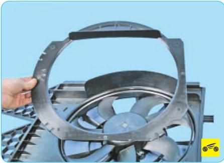
4. Снимите диффузор кожуха вентилятора.
