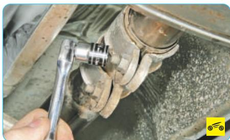
3. Ослабьте затяжку хомута крепления промежуточной трубы и дополнительного глушителя, отвернув гайки и вынув болты.
