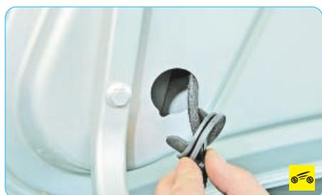
5. Извлеките жгут проводов из крышки багажника, пропустив его через технологические отверстия вместе с уплотнителем.
