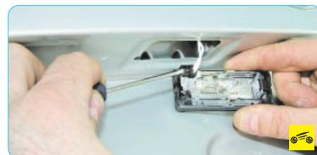
4. Отожмите фиксатор колодки жгута проводов фонаря освещения номерного знака...
