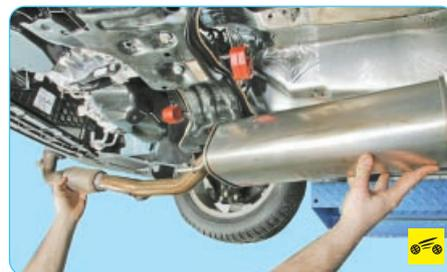
11. Снимите приемную трубу с дополнительным глушителем (см. «Замена блока дополнительного глушителя и приемной трубы», с. 111).
