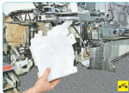
8. Снимите бачок стеклоомывателя с автомобиля, опуская его вниз (для наглядности показано со снятым передним бампером).
