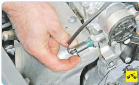
2. Отожмите фиксатор колодки жгута проводов датчика сигнальной лампы аварийного падения давления масла...
