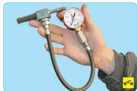
Проверка давления топлива в топливной рампе двигателя возможна только при наличии манометра с набором переходников для подключения к топливопроводу.
