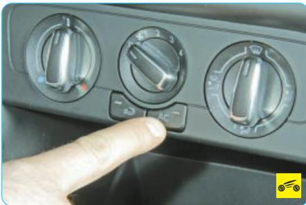
Для охлаждения воздуха, поступающего в салон автомобиля, нажмите на кнопку выключателя 4 кондиционера – в ней загорится контрольная лампа. Для выключения кондиционера повторно нажмите на кнопку.
