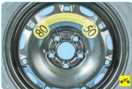
Однако если автомобиль оснащен легкосплавными колесами, то максимальная скорость автомобиля при движении с таким колесом не должна превышать 80 км/ч.
