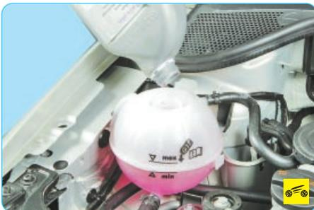
17. Залейте охлаждающую жидкость и удалите из системы охлаждения воздушные пробки (см. «Замена охлаждающей жидкости», с. 94).
