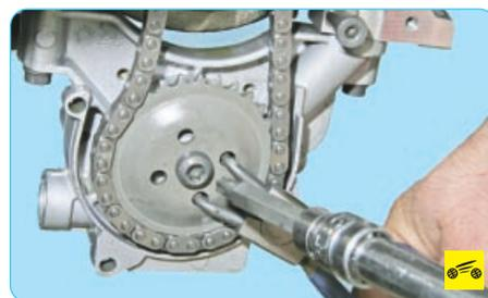
6. Выверните болт крепления звездочки масляного насоса, удерживая звездочку от проворачивания, и снимите ее.
