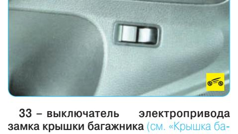
**33 – выключатель электропривода замка крышки багажника** (см. «Крышка багажника», с. 27).
