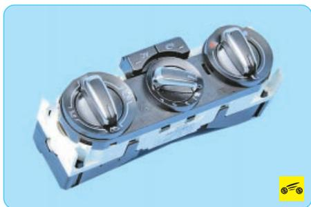
32. Установите блок управления системой отопления, кондиционирования и вентиляции салона, а также все снятые детали в порядке, обратном снятию.
