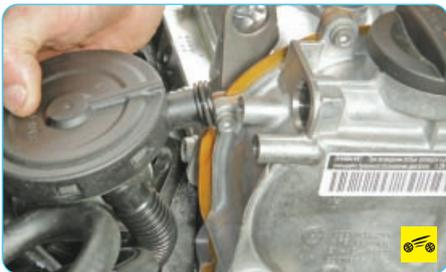
7. Извлеките патрубок маслоотделителя из отверстия в крышке привода газораспределительного механизма.
