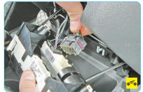
29. ...отсоедините от блока колодку жгута проводов выключателя кондиционера.
