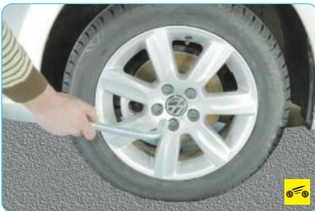
7. Включите I передачу и стояночный тормоз. Штатным баллонным ключом ослабьте пять болтов крепления колеса.
