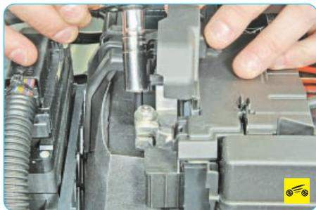
5. ...ослабьте затяжку гайки стяжного болта наконечника провода...
