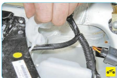
5. Поднимите фиксатор верхнего крепления бачка стеклоомывателя к кузову.
