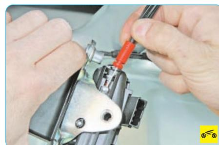
5. ...и трос выключателя замка, снимите замок.
