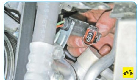
36. Отсоедините колодку проводов от разъема электромагнитной муфты компрессора кондиционера.
