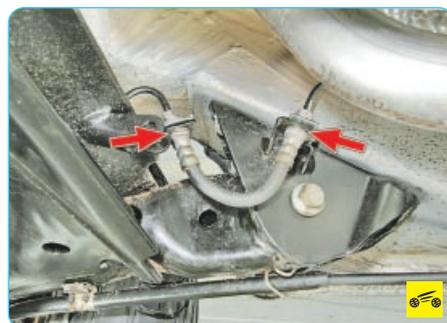
4. Проверьте, нет ли утечки жидкости из соединений тормозных трубок с тормозными шлангами.
