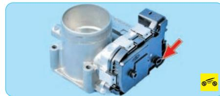
**Датчик положения дроссельной заслонки** установлен на корпусе дроссельной заслонки и связан с осью дроссельной заслонки.
