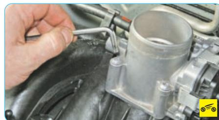
4. Выверните четыре винта крепления дроссельного узла к впускной трубе...
