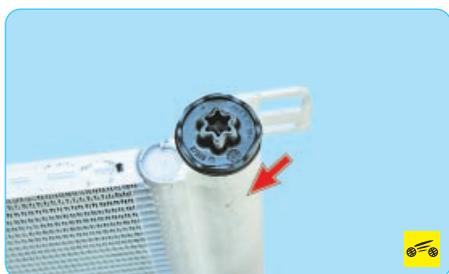
**Ресивер-осушитель** установлен на конденсоре с левой стороны и представляет собой разборный блок. Внутри корпуса находится фильтрующий элемент (картридж), заполненный гранулами осушителя (силикагеля). Проходящий через ресивер сжиженный хладагент очищается от возможных примесей, грязи и влаги. В верхней части корпуса ресивера расположено отверстие для замены фильтрующего элемента.
