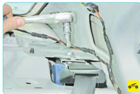
8. Выверните болт крепления инерционной катушки заднего ремня безопасности к кузову...
