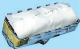
– модуль подушки безопасности переднего пассажира, находящийся в панели приборов со стороны пассажира и состоящий из сложной оболочки подушки и газогенератора;
