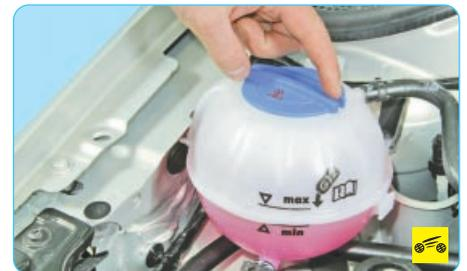
4. Заверните пробку расширительного бачка, пролитую жидкость удалите чистой тряпкой.
