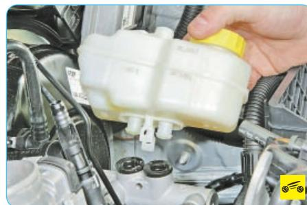
8. Снимите бачок, извлекая его патрубки из соединительных втулок.
