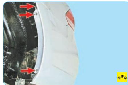
9. Изнутри обеих арок задних колес выверните по одному болту крепления бампера к кузову и по два болта крепления бампера к подкрылку.
