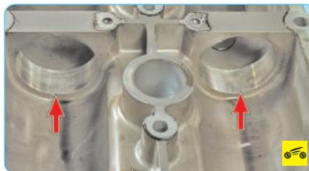
18. Осмотрите поверхности подшипников в корпусе распределительных валов...
