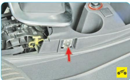
17. ...и по одному винту бокового крепления с обеих сторон облицовки.
