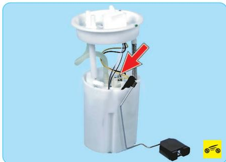
**Топливный модуль** включает в себя электрический насос, топливный фильтр, регулятор давления топлива и датчик указателя уровня топлива.
