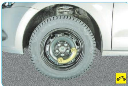
**Запасное колесо** можно устанавливать как на переднюю, так и на заднюю ось.
