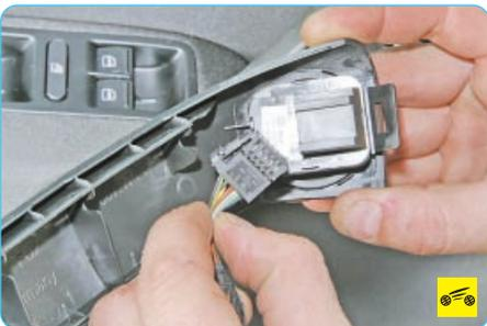
5. ...и отсоедините колодку жгута проводов от блока управления наружными зеркалами заднего вида.
