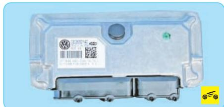
Электронный блок управления связан электрическими проводами со всеми датчиками системы. Получая от них информацию, блок выполняет расчеты в соответствии с параметрами и алгоритмом управления, хранящимися в памяти программируемого постоянного запоминающего устройства (ППЗУ), и управляет исполнительными устройствами системы. Вариант программы, записанный в память ППЗУ, обозначен номером, присвоенным данной модификации ЭБУ.
