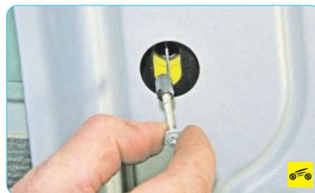
3. Ввернув самонарезающий винт в распорную планку, извлеките ее.
