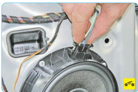
3. Сожмите фиксаторы колодки проводов динамика...
