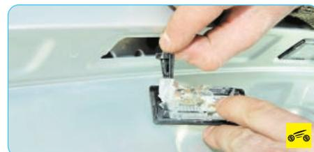
5. ...и отсоедините колодку от фонаря. Аналогично снимите второй фонарь освещения номерного знака.
