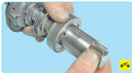
25. Шестерня должна легко проворачиваться относительно ступицы муфты в сторону вращения ротора и не должна проворачиваться в противоположном направлении. Если зубья шестерни изношены или повреждены либо шестерня проворачивается в обоих направлениях, замените муфту.
