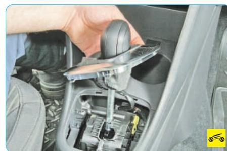
15. Снимите рамку чехла рычага селектора управления коробкой передач, преодолевая упругое сопротивление ее фиксаторов.
