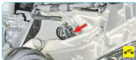
**Датчик положения коленчатого вала** предназначен для синхронизации работы электронного блока управления двигателем с угловым положением коленчатого вала. Действие датчика основано на эффекте Холла.
