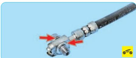
**Заглушите отверстия наконечника шланга любым доступным способом, чтобы предотвратить вытекание из него тормозной жидкости. Наконечник шланга с двух сторон уплотнен алюминиевыми шайбами. При каждой разборке соединения заменяйте шайбы новыми.**
