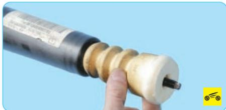
14. Снимите со штока защитный чехол 2 в сборе буфером сжатия 3.
