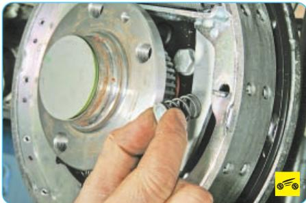
7. ...снимите чашку, прижимную пружину...
