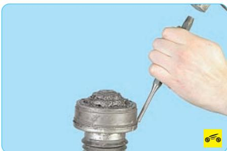
18. Сбейте с корпуса шарнира обойму защитного чехла...
