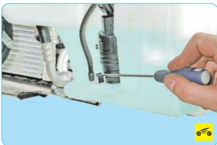
5. Подденьте отверткой фиксатор наконечника шланга стеклоомывателя, приподнимите фиксатор...
