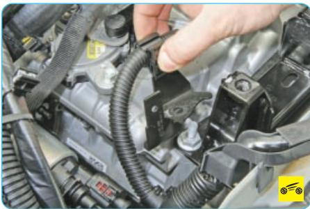
9. ...и снимите кронштейн со шпильки.
