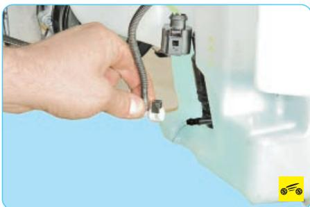
6. ...и снимите шланг с патрубка электронасоса. Слейте жидкость из бачка стеклоомывателя в заранее подготовленную емкость, если этого не было сделано ранее.
