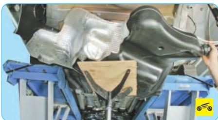
22. Сдвигая топливный бак вправо, снимите его в сборе с наливной горловиной.
