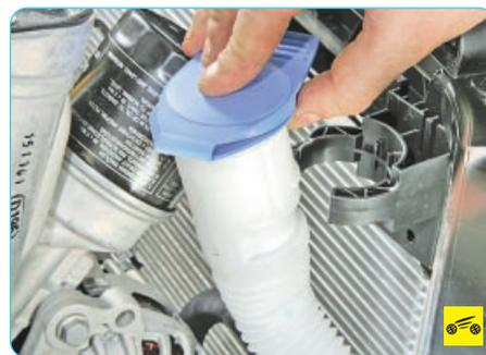
6. Извлеките наливную горловину бачка стеклоомывателя из кронштейна на радиаторе.
