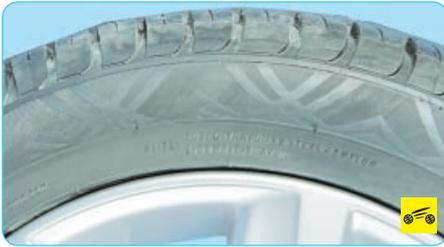
Иногда на боковине шины вместо обозначения «Steel» (или дополнительно к нему) может быть указан полный перечень материалов, из которых состоят отдельные элементы конструкции протектора шины («Piles tread» – состав слоя протектора).
