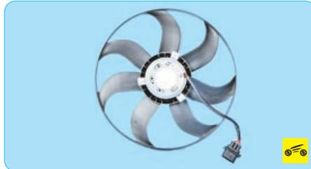
**Электродвигатель изготовлен в сборе с крыльчаткой, поэтому разборке и ремонту не подлежит.**
