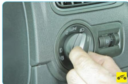
**4** – перемещением рукоятки в осевом направлении на себя из положения 3 до второго щелчка дополнительно включается задний противотуманный фонарь – в комбинации приборов загорится контрольная лампа 4 (см. «Комбинация приборов», с. 19).
