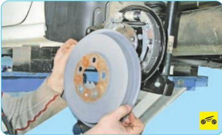
4. Снимите тормозной барабан (см. «Снятие и установка тормозного барабана», с. 173).
