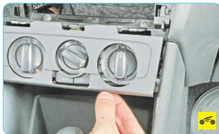
10. Подденьте край облицовки блока управления системой отопления, кондиционирования и вентиляции салона...
