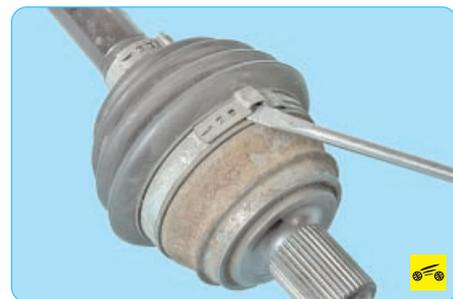
3. Для замены **наружного шарнира** и его чехла отсоедините отверткой или перекусите бокорезами замок большого хомута крепления наружного чехла шарнира...
