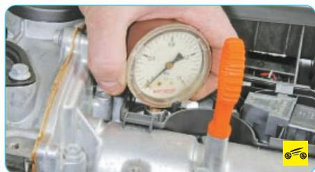
6. Вверните компрессометр в свечное отверстие проверяемого цилиндра.
