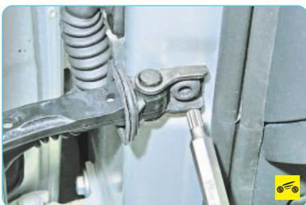
2. Выверните винт крепления ограничителя к стойке кузова...
