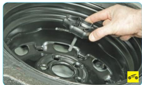
3. Выверните фиксатор крепления запасного колеса.
