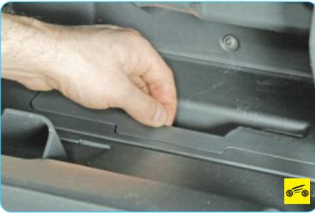
В дне вещевого ящика предусмотрен отсек для документов. Для получения доступа в отсек возьмитесь за край рукоятки крышки отсека...
