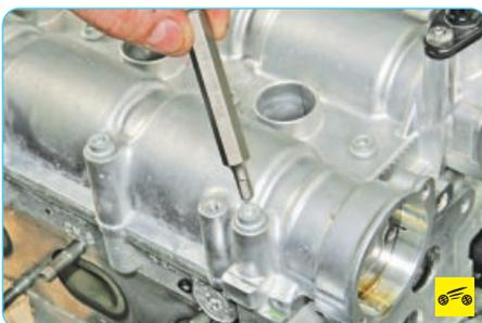
15. Выверните болты крепления корпуса распределительных валов...
