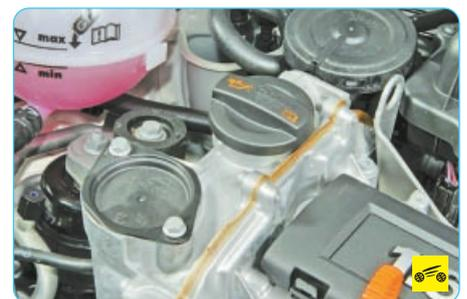
Маслоналивная горловина находится на крышке цепи привода газораспределительного механизма.
