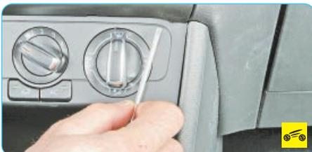
2. Подденьте отверткой с плоским лезвием декоративную накладку панели приборов...
