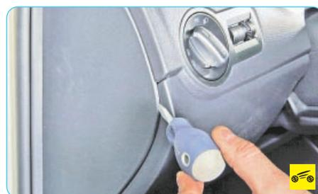
2. Подденьте отверткой крышку торца панели приборов...
