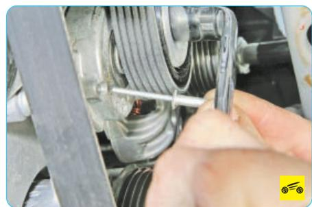
5. ...до совмещения отверстия в натяжителе и кронштейне компрессора кондиционера. Зафиксируйте натяжитель, вставив в отверстие штифт.
