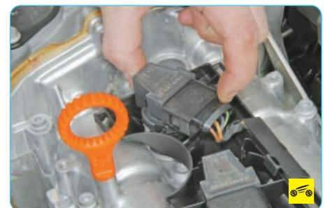
3. Проверьте посадку катушек зажигания на свечах и надежность присоединения колодок жгута проводов к катушкам зажигания.
