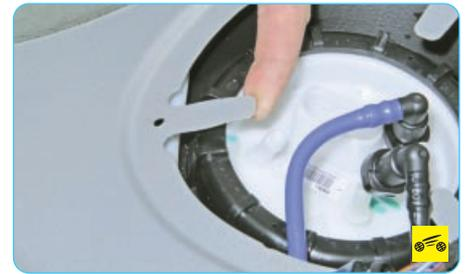
10. Отогните вверх пластины в отверстии люка.
