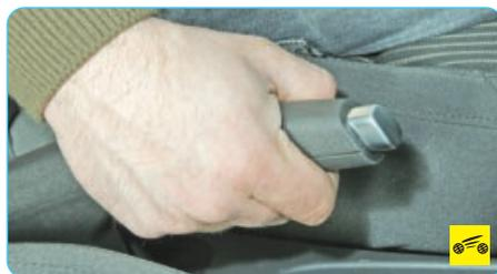
25 – рычаг стояночного тормоза (на рис. 1.7 закрыт центральным подлокотником). Для того чтобы затормозить автомобиль стояночным тормозом, поднимите рычаг до упора вверх – в комбинации приборов загорится красным светом сигнальная лампа 8.
