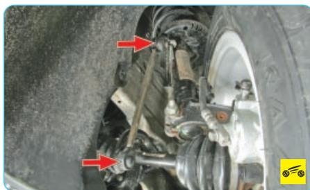
4. Проверьте состояние чехлов верхнего и нижнего шарниров стоек стабилизатора поперечной устойчивости.
