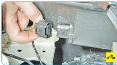
6. Отожмите отверткой фиксатор колодки жгута проводов электрокорректора света фар и отсоедините колодку от электрокорректора.
