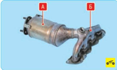
Отработавшие газы отводятся из двигателя через катколлектор (выпускной коллектор **Б**, объединенный с каталитическим нейтрализатором **А**). Далее газы поступают в приемную трубу **6** (рис. 5.6), объединенную в общий узел с дополнительным глушителем, из которой они проходят в промежуточную трубу **3**, объединенную с основным глушителем.
