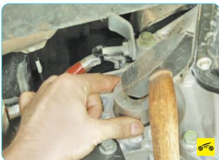
4. Смажьте рабочую кромку сальника трансмиссионной смазкой и запрессуйте его оправкой подходящего диаметра рабочей кромкой внутрь коробки передач.
