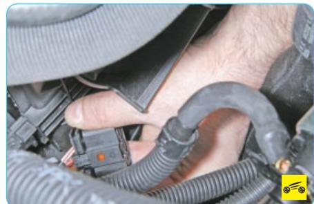
3. Сожмите фиксатор колодки жгута проводов электродвигателя вентилятора и отсоедините колодку.
