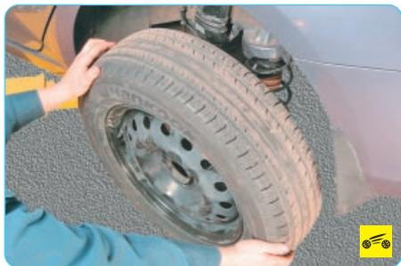
4. Приподнимите заднюю часть автомобиля, установите ее на надежные опоры и снимите колесо.
