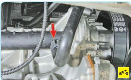
27. Отсоедините от патрубка подводящей трубы шланг расширительного бачка системы охлаждения двигателя.
