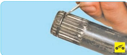
8. Снимите стопорное кольцо с вала, выведя его отверткой из проточки вала.
