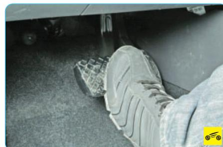
1. Причиной потери эффективности торможения может быть неудовлетворительная работа вакуумного усилителя. Для его экспресс-проверки нажмите несколько раз на педаль тормоза при неработающем двигателе, чтобы снять разрежение в усилителе, а затем, удерживая педаль,пустите двигатель. Если после пуска двигателя педаль немного опустится, вакуумный усилитель исправен.
