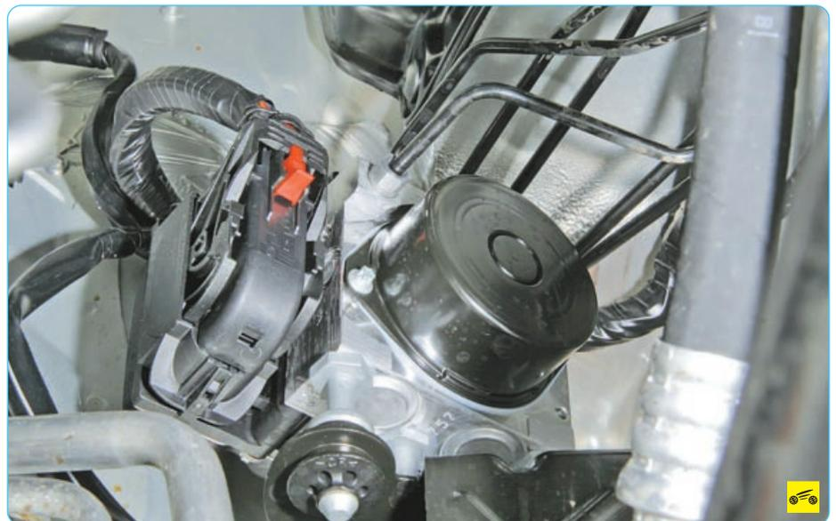
**Рис. 9.4. Гидроэлектронный блок управления**
