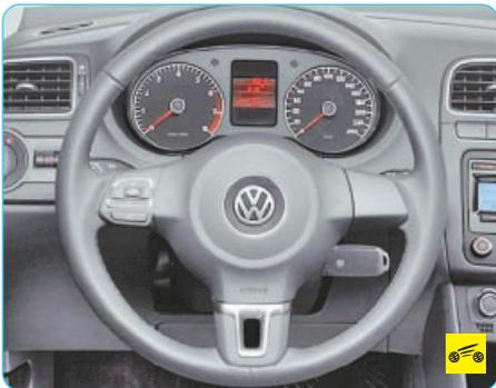
В зависимости от комплектации автомобиля в левой спице рулевого колеса может быть установлен блок управления аудиосистемой и телефоном.
