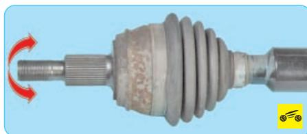
– наружный шарнир равных угловых скоростей должен поворачиваться с легким усилием, без рывков и заеданий, радиальных и осевых люфтов. При их наличии замените шарнир;
