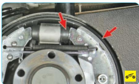
6. Проверьте подвижность поршней рабочего цилиндра заднего тормозного механизма. Для этого попробуйте сдвинуть с места поршни, сдавив тормозные колодки. Если сдвинуть поршни не удастся, значит, их заклинило в тормозном цилиндре.
