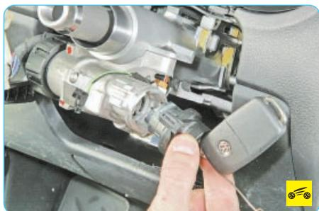
8. ...и извлеките цилиндр из корпуса замка рулевой колонки.
