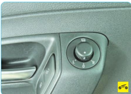
**4** – блок управления зеркалами с электроприводом и обогревом (см. «Зеркала заднего вида», с. 31).
