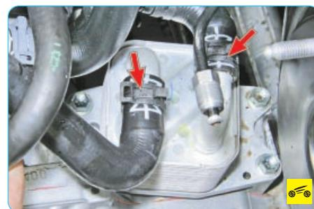
21. Сожмите пассатижами ушки хомута крепления шланга системы охлаждения двигателя, сдвиньте хомут по шлангу и отсоедините шланг от патрубка маслоохладителя коробки передач (для наглядности показано со снятым главным тормозным цилиндром). Аналогично отсоедините от патрубка маслоохладителя коробки передач второй шланг.
