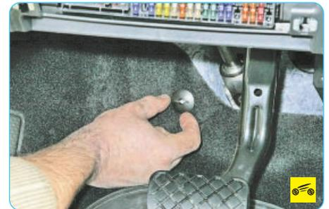
8. Под панелью приборов извлеките пистон крепления покрытия пола...
