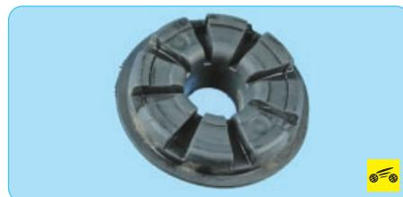
8. Снимите верхние прокладки с пружин и осмотрите прокладки. Надорванные, потерявшие эластичность прокладки замените.
