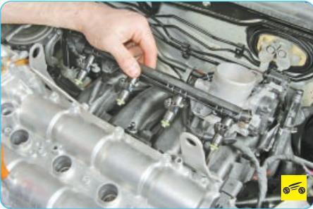
5. Снимите топливную рампу (см. «Снятие и установка топливной рампы», с. 106).
