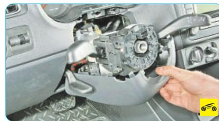
4. Снимите нижнюю часть кожуха рулевой колонки (см. «Снятие и установка кожуха рулевой колонки», с. 154).
