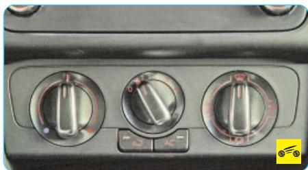
22 – блок управления системой отопления (кондиционирования) и вентиляции салона, см. «Отопление (кондиционирование) и вентиляция салона», с. 22.
