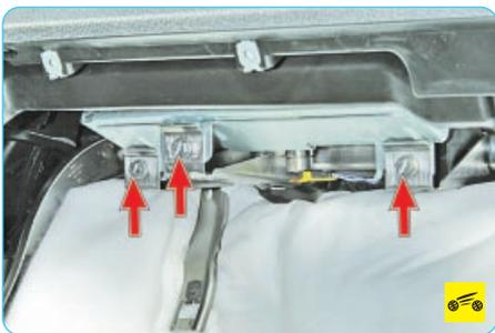
7. Выверните три болта крепления модуля подушки безопасности переднего пассажира к кронштейнам кузова.
