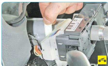
6. Выдвиньте фиксатор колодки жгута проводов подрулевых переключателей...
