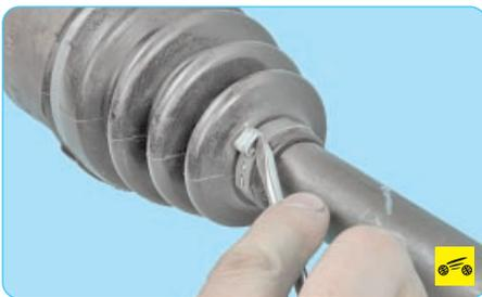
9. Отсоедините отверткой или перекусите бокорезами замок малого хомута крепления наружного чехла шарнира...
