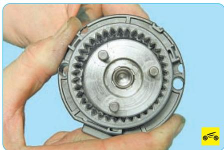
35. Снимите с вала привода коронную шестерню.
