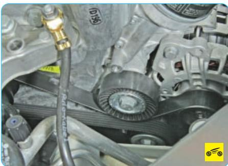
4. Обрыв или ослабление натяжения ремня привода генератора и водяного насоса практически всегда приводит к перегреву двигателя. Если ремень цел, проверьте его натяжение (см. «Снятие и установка ремня привода вспомогательных агрегатов», с. 70). Если произошел обрыв или ремень изношен
