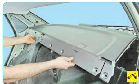
7. Снимите облицовку задней полки (см. «Снятие и установка облицовок салона», с. 242).
