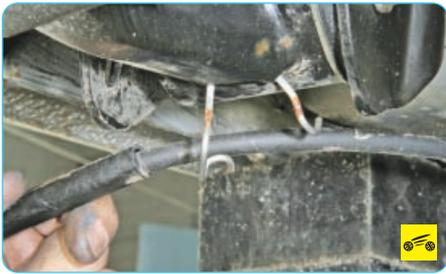
10. Извлеките из держателей на балке задней подвески трос привода стояночного тормоза. Аналогично извлеките из держателей на балке трос привода стояночного тормоза второго колеса.
