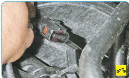
10. Отсоедините колодку жгута проводов от датчика абсолютного давления (разрежения) во впускной трубе (см. «Замена датчиков системы управления двигателем», с. 197).
