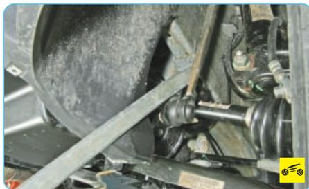
5. Проверьте шарниры стоек стабилизатора на наличие люфтов.
