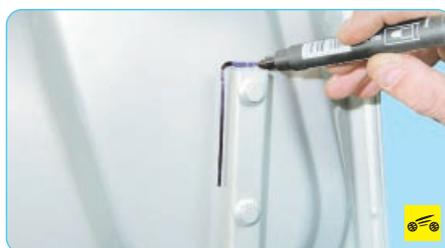
Если вы снимаете крышку багажника не для замены, рекомендуем пометить положение петель относительно крышки (например, обведите их по контуру фломастером).
