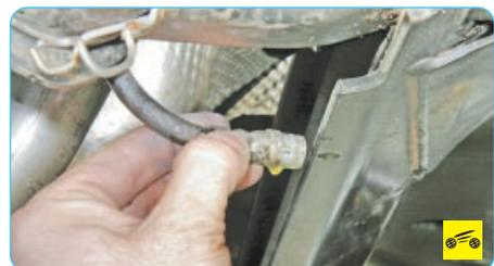
7. ...и выведите наконечник тормозного шланга из отверстия в кронштейне на балке задней подвески.
