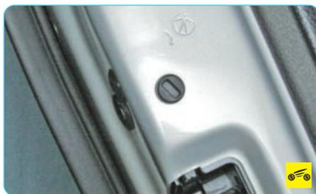
Замки задних дверей оборудованы механизмом, исключающим возможность открывания дверей изнутри («детский» замок).
