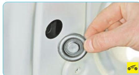
2. Снимите заглушку отверстия во внутренней панели двери и установите стекло задней двери в положение, при котором распорная планка крепления стекла к стеклоподъемнику будет расположена напротив открывшегося отверстия.
