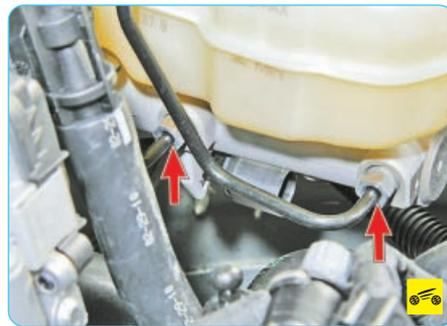
2. ...соединения трубопроводов с главным тормозным цилиндром...
