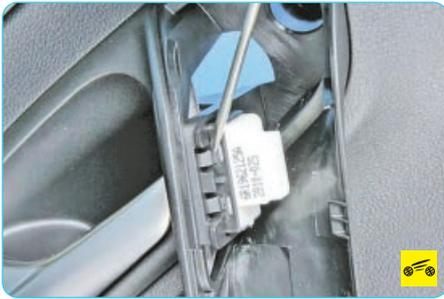
6. Отожмите фиксаторы выключателя...
