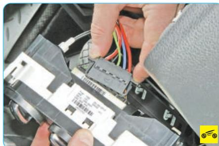
25. ...отсоедините от блока колодку жгута проводов регулятора частоты вращения крыльчатки электровентилятора.
