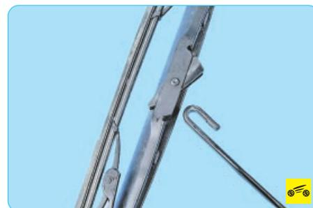
2. ...немного сдвиньте щетку вниз по рычагу и снимите щетку с рычага.
