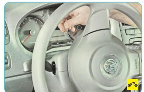
5. ...и, поднимая ее вверх, отожмите фиксатор модуля подушки безопасности водителя.
