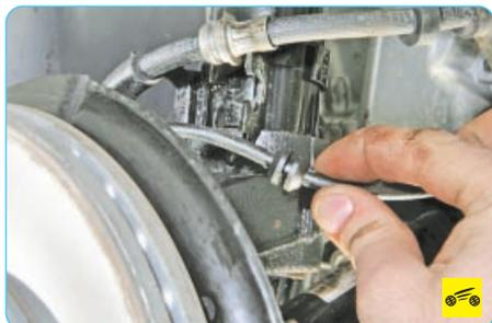
13. Извлеките втулку провода датчика частоты вращения колеса из держателя на амортизаторной стойке.
