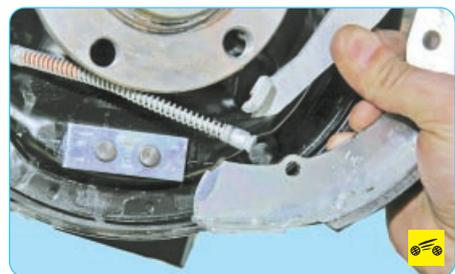
9. Снимите тормозные колодки и отсоедините от разжимных рычагов обоих тормозных
