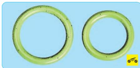
В местах соединений отдельных элементов системы установлены уплотнительные кольца круглого сечения из неопрена. Во время ремонта системы при разъединении участков трубопроводов уплотнительные кольца подлежат обязательной замене. Резьбовые соединения трубопроводов затягивайте рекомендуемым моментом. Слабая или излишне сильная затяжка приводит к деформации уплотняемых поверхностей и утечке хладагента.
