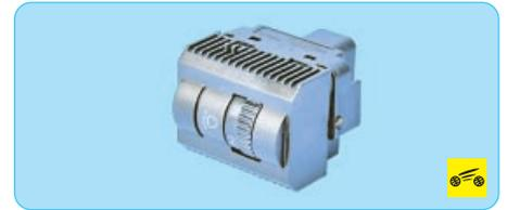
7. Установите блок управления электрокорректором света фар в порядке, обратном снятию.
