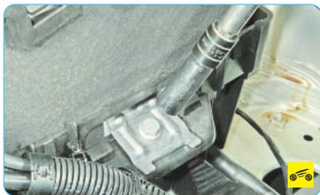
7. Выверните болт крепления прижимной пластины...
