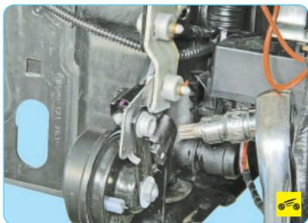
5. Отверните гайку крепления звукового сигнала к кронштейну..
