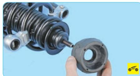
5. Снимите со штока верхнюю опору амортизаторной стойки...
