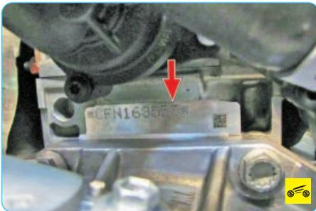
Идентификационный номер двигателя выбит на задней части блока цилиндров под термостатом.
