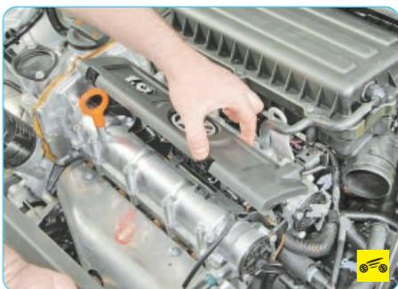
2. Сожмите фиксаторы и снимите крышку держателя проводов.
