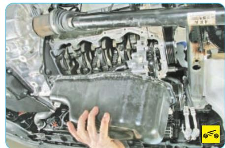
4. Снимите масляный картер двигателя (см. «Замена уплотнения масляного картера двигателя», с. 74).
