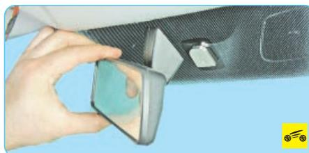
6. Снимите внутреннее зеркало заднего вида (см. «Снятие и установка внутреннего зеркала», с. 240).
