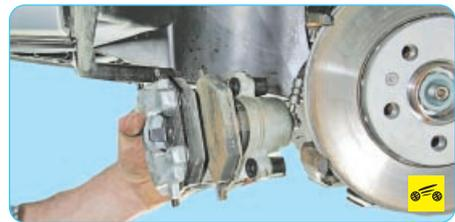
5. ...и снимите суппорт вместе с тормозными колодками с направляющей колодок.
