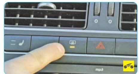
Для быстрого устранения запотевания заднего стекла нажмите на клавишу выключателя 13 (см. рис. 1.7) электрообогрева заднего стекла. При нажатии на клавишу выключателя (двигатель должен работать) включается электрообогрев стекла, одновременно в клавише загорается контрольная лампа. При повторном нажатии на клавишу обогрев выключается, контрольная лампа гаснет.
