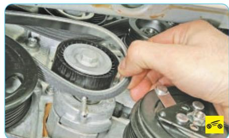
6. Снимите ремень привода вспомогательных агрегатов с ролика натяжного механизма...
