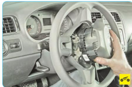
2. Снимите подушку безопасности (см. «Снятие и установка подушки безопасности водителя», с. 264).
