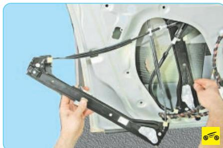
6. ...и снимите стеклоподъемник.
