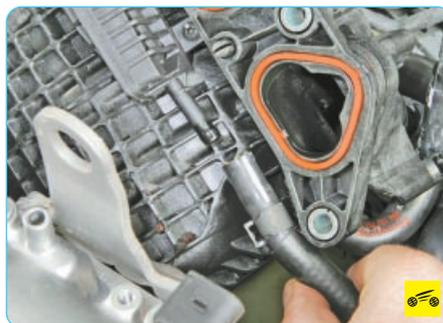
32. Аналогично отсоедините второй шланг системы охлаждения двигателя для подогрева системы вентиляции картера от патрубка подогревателя.
