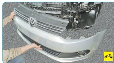
2. Снимите передний бампер (см. «Снятие и установка переднего бампера», с. 222).
