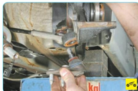
10. Снимите шаровую опору.
