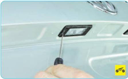
2. Подденьте отверткой корпус фонаря освещения номерного знака...
