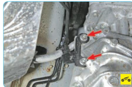
20. Отверните две гайки крепления кронштейна жгута проводов к корпусу коробки передач.
