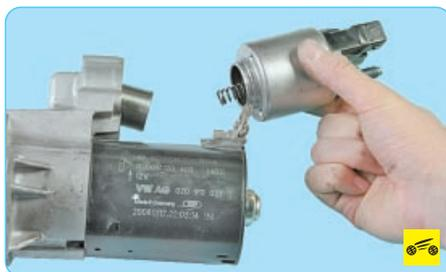
4. ...и снимите корпус тягового реле.
