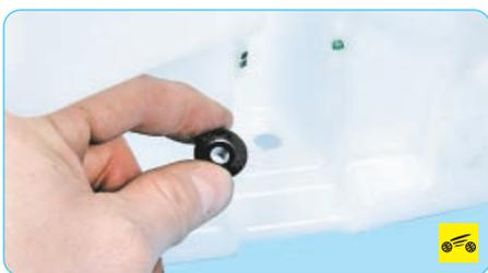
8. Извлеките втулку электронасоса стеклоомывателя из отверстия бачка.
