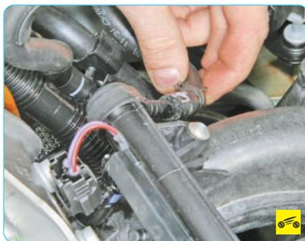
4. ...и снимите шланг со штуцера топливной рампы.
