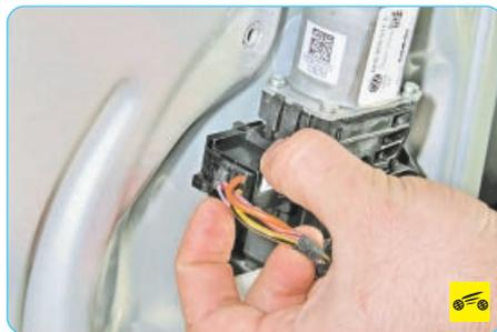
3. Отожмите фиксатор колодки жгута про-
