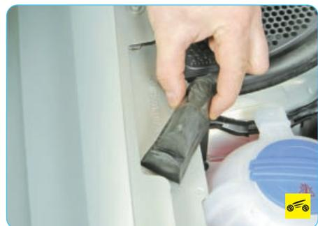
**Чтобы прочесть номер, отсоедините от кузова правую часть уплотнителя.**
