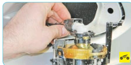
6. Нажмите на фиксатор колодки жгута проводов...
