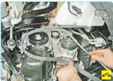
2. Снимите ремень привода генератора и водяного насоса (см. «Снятие и установка ремня привода вспомогательных агрегатов», с. 71).
