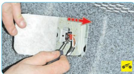
4. Подденьте отверткой фиксатор колодки жгута проводов, сдвиньте его в направлении стрелки...
