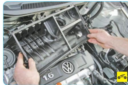
7. Снимите корпус воздушного фильтра (см. «Снятие и установка воздушного фильтра и воздухозаборника», с. 102).
