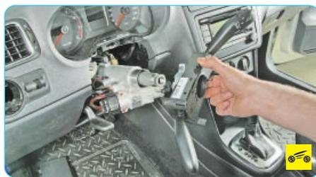
9. Снимите блок подрулевых переключателей с рулевой колонки.
