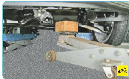
2. Подставьте через резиновую или деревянную проставку опору под двигатель.
