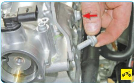
13. Выверните два болта крепления монтажной проушины...
