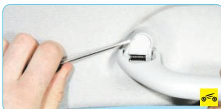
2. Поддев отверткой фиксатор...
