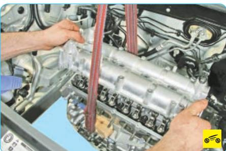
13. Снимите корпус распределительных валов (см. «Замена прокладок корпуса распределительных валов», с. 76).
