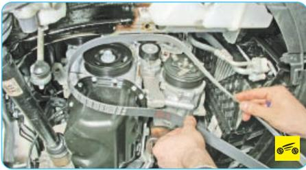
5. Снимите ремень привода вспомогательных агрегатов (см. «Снятие и установка ремня привода вспомогательных агрегатов», с. 70).
