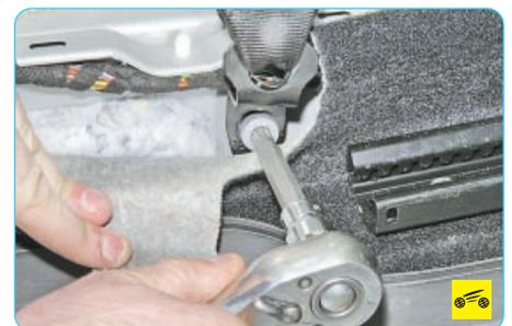
5. Выверните болт нижнего крепления ремня безопасности к кузову...
