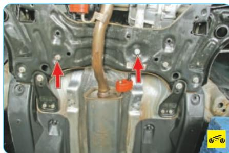
6. Выверните два болта крепления рулевого механизма к поперечине передней подвески...
