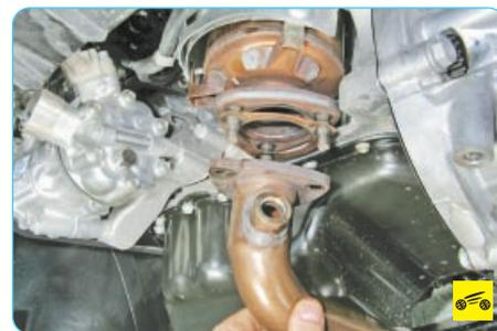
10. ...разъедините фланцы приемной трубы и катколлектора...
