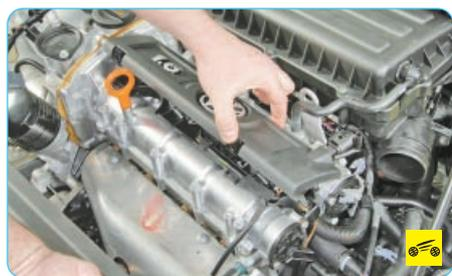
2. Отожмите фиксаторы и снимите крышку с направляющей проводов.
