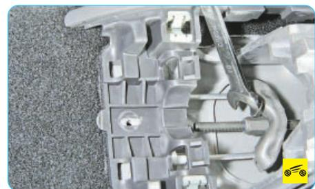
5. Заверните регулировочную гайку на тяге рычага привода стояночного тормоза до момента полного затормаживания задних колес.
