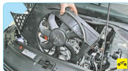
1. Снимите электровентилятор системы ох-
