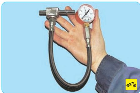
Проверка давления топлива в системе питания возможна только при наличии манометра со шлангом для подключения к топливной магистрали.
