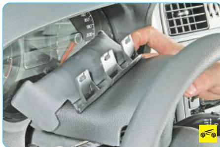
2. Снимите верхнюю часть кожуха рулевой колонки (см. «Снятие и установка кожуха рулевой колонки», с. 154).
