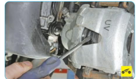
4. Проверьте подвижность поршня переднего тормозного механизма. Для этого попробуйте сдвинуть с места поршень отверткой. Если поршень не удается сдвинуть, значит, его заклинило в тормозном цилиндре.
