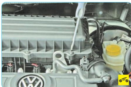
6. Выверните пять винтов крепления крышки корпуса воздушного фильтра.
