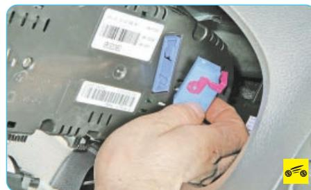
8. ...разъедините колодку жгута проводов и снимите комбинацию приборов.
