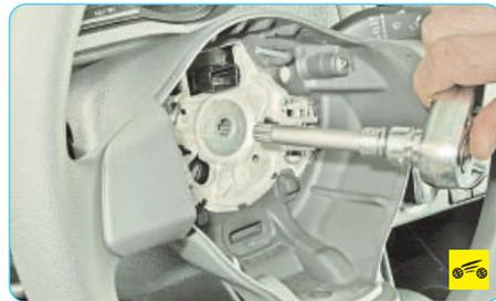
4. Ослабьте затяжку болта крепления рулевого колеса к рулевому валу, удерживая рулевое колесо от проворачивания.
