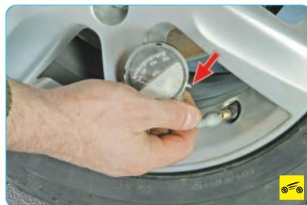
2. Проверьте давление воздуха в шине. Для этого сбросьте показания манометра на ноль, нажав на специальную кнопку на корпусе манометра...
