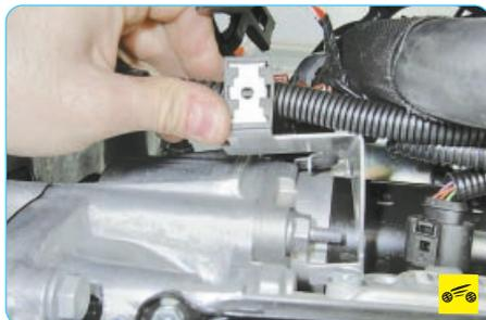
10. ...снимите кронштейн со шпильки и отведите в сторону.
