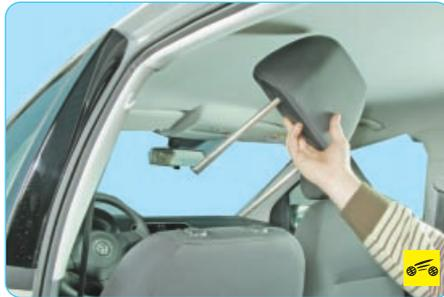
При необходимости (например, для складывания сиденья в спальное положение) подголовник можно снять, нажав на фиксатор.
