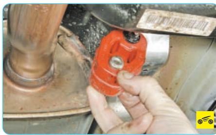
9. Снимите подушку подвески дополнительного глушителя с его кронштейна...
