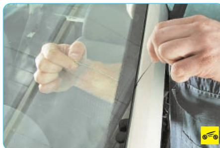
8. Слегка поддев стекло отверткой, проткните клеевой шов заостренным инструментом (например, шилом) и протяните в отверстие струну.
