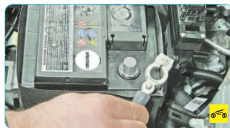
1. Отсоедините провод от клеммы «минус» аккумуляторной батареи.
