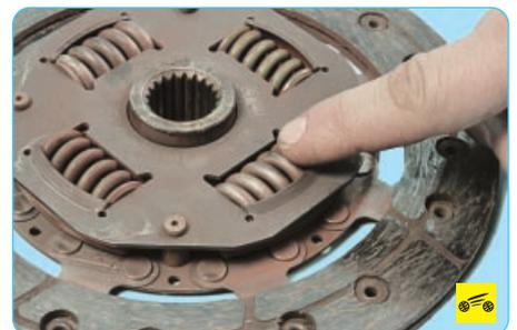
7. Проверьте надежность фиксации демферных пружин в гнездах ступицы ведомого диска, попытайтесь переместить их в гнезда ступицы рукой. Если пружины легко перемещаются в гнездах или сломаны, замените диск.
