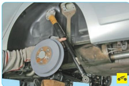
9. ...и снимите амортизатор.
