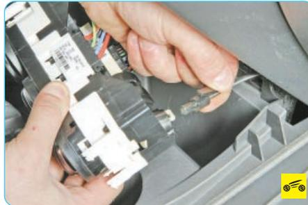
23. ...отсоедините от блока трос регулятора распределения потоков воздуха.
