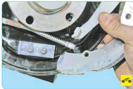
10. Отсоедините наконечник троса от разжимного рычага (см. «Замена тормозных колодок тормозного механизма заднего колеса», с. 173).
