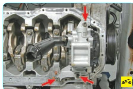
7. Выверните три болта крепления масляного насоса и снимите насос.
