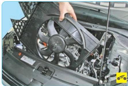
4. Снимите электровентилятор радиатора (см. «Снятие и установка электровентилятора радиатора системы охлаждения двигателя в сборе с кожухом», с. 94).
