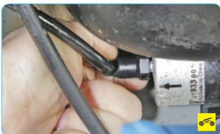
2. Сожмите фиксатор наконечника отводящего топливопровода...
