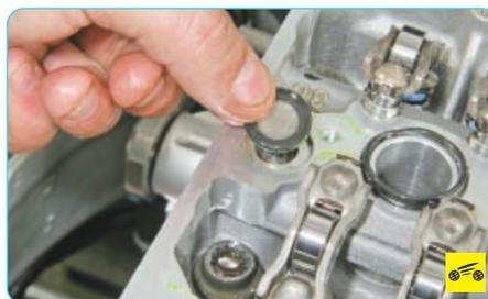
20. Снимите и замените сетчатый фильтр магистрали системы смазки двигателя.
