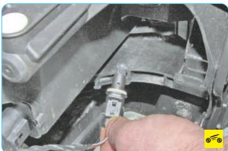
5. Извлеките патрон лампы переднего габаритного огня из отверстия блок-фары.
