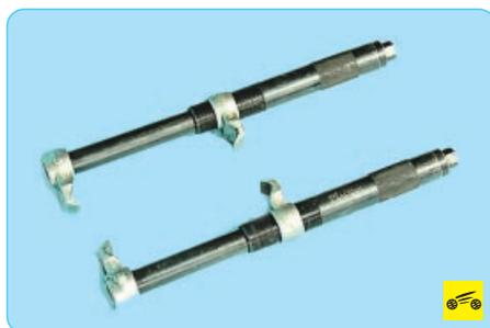
...и приспособление для сжатия пружин.
