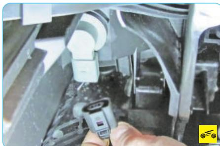
4. Нажмите на фиксатор и отсоедините колодку жгута проводов от лампы указателя поворота.
