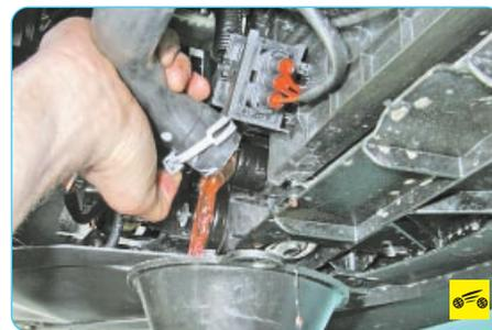
2. Слейте охлаждающую жидкость (см. «Замена охлаждающей жидкости», с. 94).
