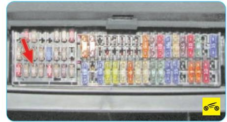
1. Стартер не включается. Причины – перегорание предохранителя в монтажном блоке предохранителей в панели приборов...
