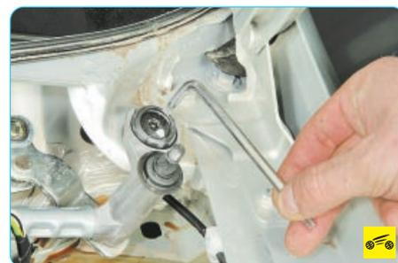
6. Выверните два болта крепления трапеции стеклоочистителя...
