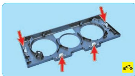
Так расположены пружинные держатели облицовки блока управления системой отопления, кондиционирования и вентиляции салона.
