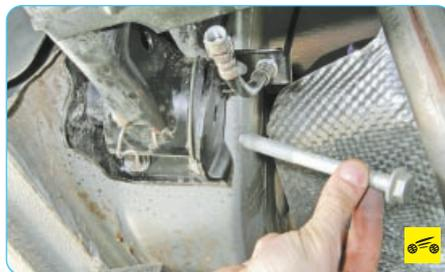
17. ...и извлеките болт из отверстий кронштейна и шарнира (сайлентблока). Аналогично отверните гайку и извлеките болт крепления шарнира (сайлентблока) с другой стороны.
