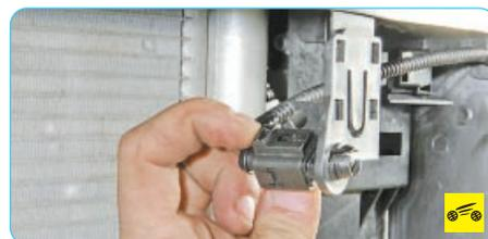
4. Нажмите на фиксатор колодки жгута проводов датчика наружной температуры...
