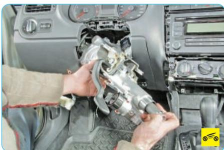
15. ...и снимите рулевую колонку с выключателем зажигания, промежуточным валом и электроусилителем рулевого управления.
