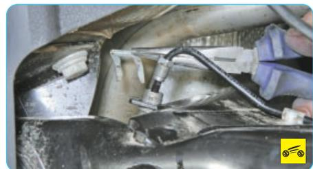
6. ...снимите фиксирующую скобу...
