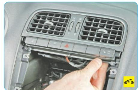
3. Подденьте нижнюю часть блока выключателей и центральных сопел системы отопления кондиционирования и вентиляции салона...
