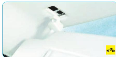
3. ...и извлеките кронштейн противосолнечного козырька из отверстия в обивке потолка.
