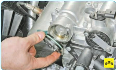
8. ...и снимите крышку. Аналогично снимите крышку впускного распределительного вала.
