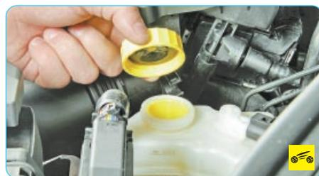
1. Отверните пробку бачка главного тормозного цилиндра.
