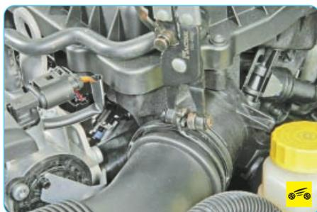
3. Сожмите свободные концы хомута крепления воздухоподводящего рукава к корпусу воздушного фильтра, сдвиньте хомут по шлангу...
