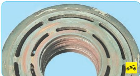
В результате трения детали нагреваются, и начинается выгорание изоляции обмотки катушки. Происходит электрическое замыкание, в результате чего электромагнит выходит из строя. В самых запущенных случаях происходит заклинивание подшипника и проворачивание внутренней обоймы подшипника на посадочной шейке крышки компрессора. После этого компрессор придется заменить в специализированном сервисе, что очень дорого обходится.
