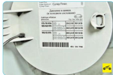
Давление в шинах также можно найти в табличке, закрепленной на внутренней стороне крышки люка наливной трубы топливного бака.
