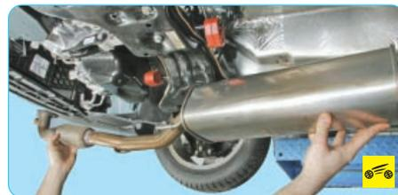
7. Снимите дополнительный глушитель (см. «Замена блока дополнительного глушителя и приемной трубы», с. 111).
