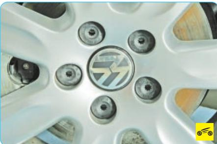
Если на автомобиль установлены легкосплавные диски колес, то центральная часть ступицы диска закрывает доступ к гайке ступицы.
