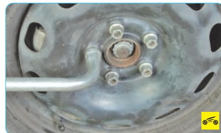
2. На стоящем на земле автомобиле ослабьте затяжку болтов крепления колеса...
