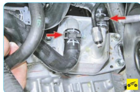
6. Сожмите отогнутые ушки хомутов крепления шлангов отвода и подвода рабочей жидкости, сдвиньте хомуты по шлангам, пережмите шланги любым доступным способом и отсоедините шланги от штуцеров теплообменника.
