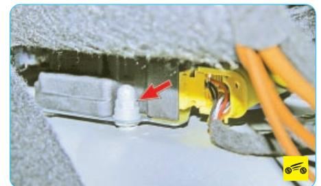
7. ...и одну гайку слева по направлению движения автомобиля.
