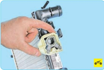
12. Снимите с радиатора подушки его опор.
