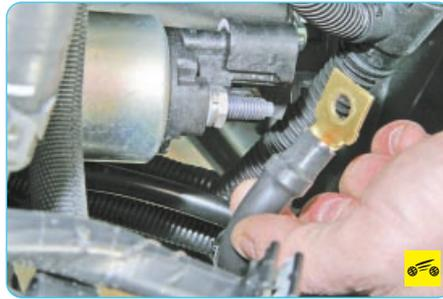
43. ...и, отвернув гайку шпильки крепления управляющего провода тягового реле, отсоедините провод от шпильки (см. «Снятие и установка стартера», с. 188).
