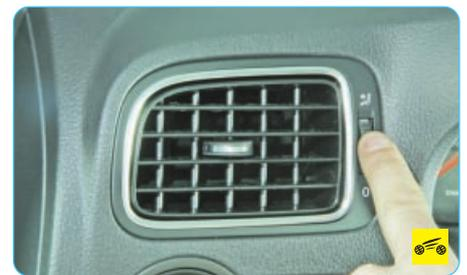
Количество воздуха, подаваемого через сопла, регулируют рукоятками, расположенными рядом с каждым соплом. При повороте рукоятки до упора вверх заслонка полностью открывается (максимальный поток воздуха),
