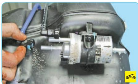
4. Аналогично отсоедините от топливного фильтра подводящий и обратный топливопроводы.
