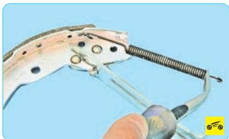
23. ...и снимите пружину.
