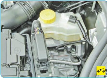
Бачок установлен непосредственно на главном тормозном цилиндре с левой стороны моторного отсека у щита передка.
