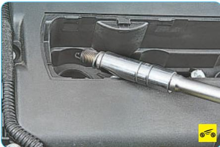
5. Выверните свечи зажигания (см. «Замена и обслуживание свечей зажигания», с. 194), внимательно осмотрите свечи и сравните их внешний вид с фотографиями, приведенными в следующем подразделе «Диагностика состояния двигателя по внешнему виду свечей зажигания», с. 45. Если свеча черная и влажная, ее можно выбросить.
