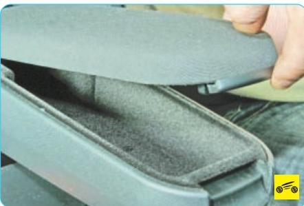
...и откройте крышку. Нажатием на крышку закройте ее.
