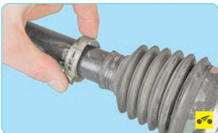
17. ...и снимите хомут с вала привода.
