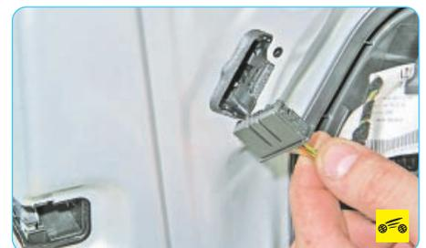
15. ...отсоедините колодку жгута проводов от замка двери и снимите обивку.
