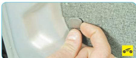
2. При необходимости, сожмите половинки шляпок десяти пистонов крепления шумоизоляции капота...
