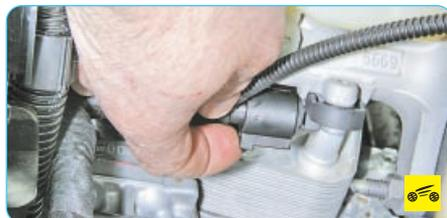
2. Отожмите фиксатор колодки жгута проводов выключателя стоп-сигнала...
