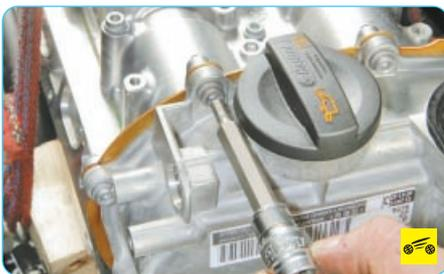
18. Выверните болт крепления крышки цепи привода газораспределительного механизма и извлеките болт из отверстия. Аналогично выверните и извлеките остальные шестнадцать болтов крепления крышки цепи привода газораспределительного механизма...
