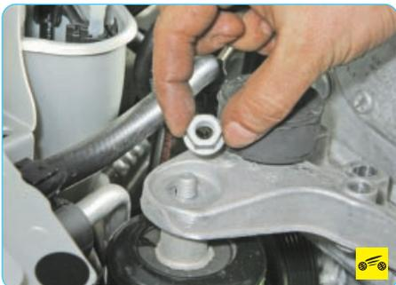
6. Отверните гайку крепления кронштейна правой опоры подвески силового агрегата и снимите гайку.
