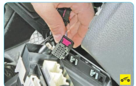
31. ...отсоедините от блока колодку жгута проводов выключателя режима рециркуляции и снимите блок управления.
