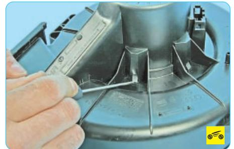
5. Отожмите четыре фиксатора электродвигателя воздуходувателя...
