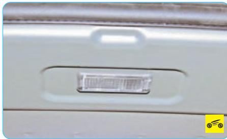
Для освещения багажного отделения в гнезде полки под задним стеклом установлен плафон, который загорается при открывании крышки багажника и гаснет при ее закрывании.
