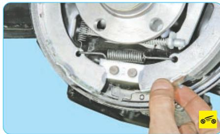
12. Аналогично выведите из-за ограничительной пластины нижний носок задней колодки, ослабив тем самым натяжение нижней стяжной пружины.
