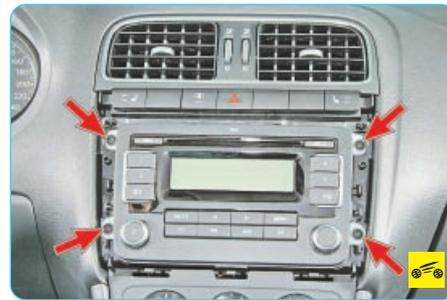
4. Выверните четыре болта крепления головного устройства аудиосистемы к кронштейнам панели приборов.
