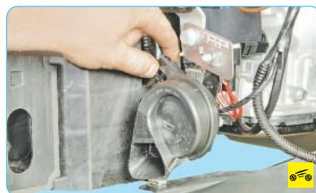
3. Отожмите фиксатор колодки жгута проводов звукового сигнала...
