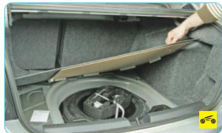
1. Откройте багажник (в нем находится все необходимое для замены колеса) и приподнимите крышку ниши для запасного колеса.
