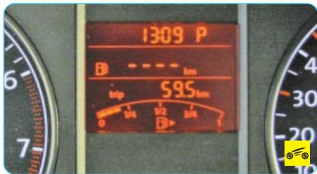
**7 – информационный дисплей.** На дисплей выводятся показания электронного счетчика суммарного пробега (одометр) в километрах. После пробега 1 000 000 км начинается новый цикл отсчета одометра. На этом же дисплее последовательным нажатием клавиши **Б** переключения режимов на рычаге 9 (см. рис. 1.7) включают индикацию счетчика суточного пробега или выводят информацию с маршрутного компьютера, а последовательным нажатием кнопок 20 (см. рис. 1.8) и 21 устанавливают время в режиме индикации часов.
