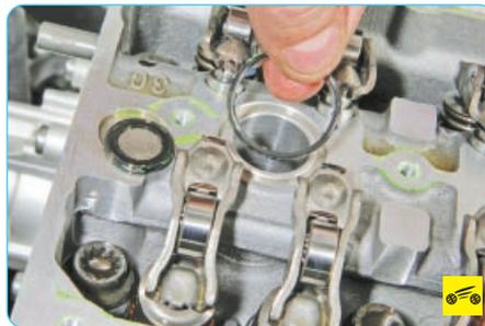
19. Поддев отверткой, снимите резиновое уплотнительное кольцо свечного колодца. Аналогично снимите остальные уплотнительные кольца и замените их.
