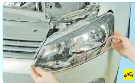
8. ...выдвиньте блок-фару вперед, преодолевая сопротивление фиксаторов, и снимите ее с автомобиля.
