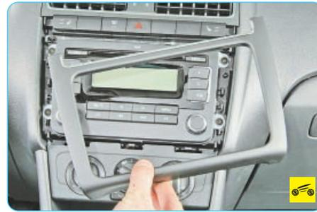
3. ...и, преодолевая сопротивление фиксаторов, снимите ее.
