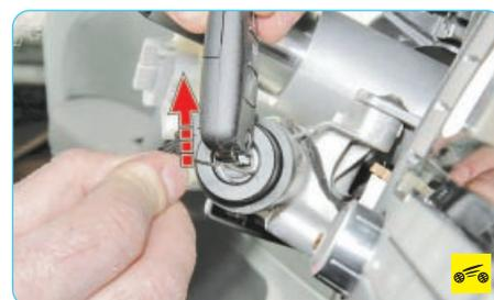
7. Вставьте ключ в замок зажигания и поверните его в положение II. Вставьте стальную проволоку в отверстие рядом с прорезью для ключа зажигания и попадите проволокой в отверстие стопорного рычага внутри замка, а затем, прилагая усилие в направлении, показанном стрелкой, разблокируйте проволокой стопорный рычаг..
