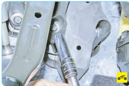
5. В салоне автомобиля, под панелью приборов отверните четыре гайки крепления вакуумного усилителя к щиту передка...
