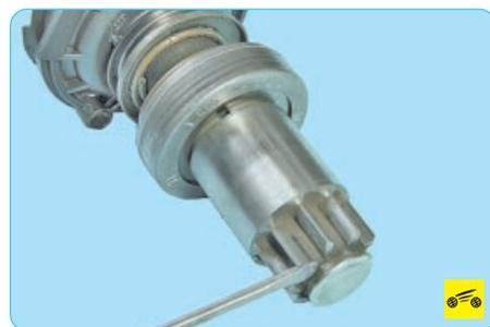
29. Подденьте отверткой и снимите защитную крышку.
