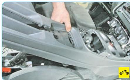
2. Снимите облицовку консоли панели приборов (см. «Снятие и установка облицовок тоннеля пола и консоли панели приборов», с. 238).
