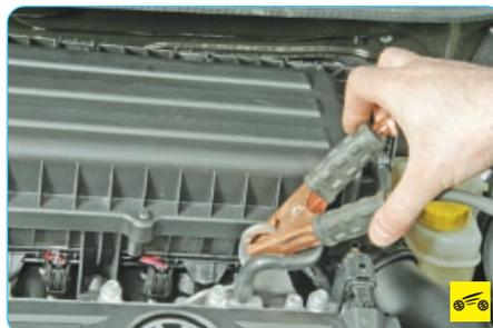
8. ...а второй зажим кабеля с черными рукоятками – к «массе» автомобиля с разряженной батареей в месте, расположенном на максимально возможном расстоянии от аккумуляторной батареи.
