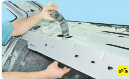
7. ...и снимите ремень, продев его замок в проем задней полки.
