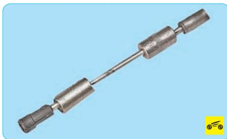
**...или инерционный съемник маслосъемных колпачков.** При отсутствии такого съемника потребуются пассатижи для снятия колпачков и оправка подходящего диаметра для их напрессовки на направляющие втулки клапанов.
