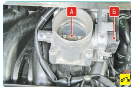
Однако необходимо отметить, что чаще всего эта неисправность бывает вызвана отказом регулятора холостого хода, установленного в крышке **Б** дроссельного узла, загрязнением заслонки **А** или подсосом постороннего воздуха через неплотные соединения шлангов, присоединенных к впускной трубе. Если очисткой дроссельной заслонки или подтяжкой хомутов шлангов восстановить холостой ход не удалось, замените дроссельный узел в сборе (см. «Снятие и установка дроссельного узла», с. 107).
