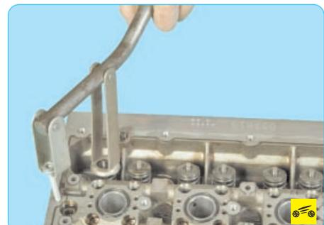
5. Установите приспособление для сжатия пружин клапанов.
