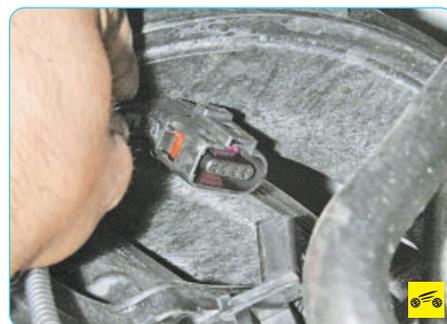
2. ...и отсоедините колодку от датчика абсолютного давления во впускной трубе.
