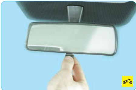
Для предотвращения ослепления светом фар движущегося сзади транспорта в темное время суток можно поворотом рычага изменить положение оптического элемента на его опоре. Для этого поверните рычаг на себя.
