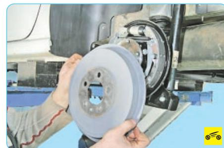
5. Снимите тормозной барабан (см. «Снятие и установка тормозного барабана», с. 173).
