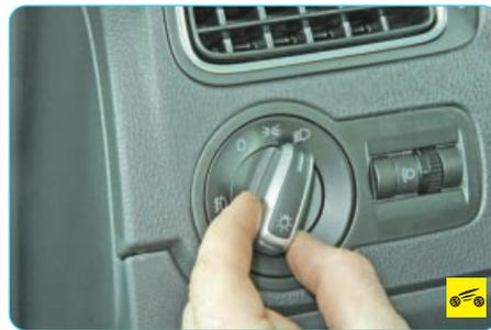
**2** – дополнительно включен ближний или дальний свет фар;
