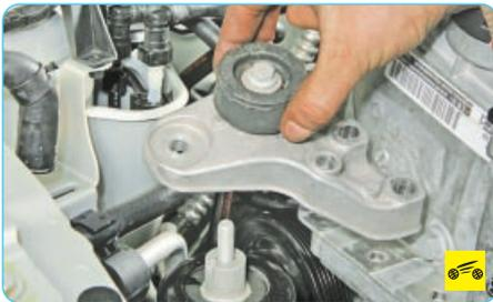
16. Снимите кронштейн правой опоры подвески силового агрегата (см. «Замена правой опоры подвески силового агрегата», с. 72).
