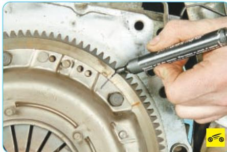
2. Если будете устанавливать прежний нажимной диск, пометьте любым способом (например, фломастером или краской) взаимное расположение кожуха диска и маховика, чтобы установить нажимной диск в прежнее положение (для сохранения балансировки).
