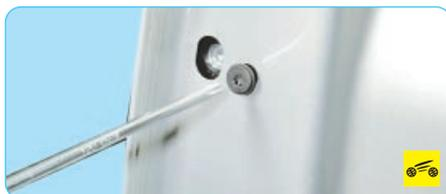
3. Выверните винт крепления выключателя...
