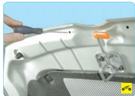
3. Два дренажных отверстия выполнены и в нижней кромке крышки багажника. Их также следует периодически прочищать, как и отверстия в боковых дверях.
