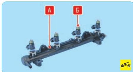
**Топливная рампа А**, представляющая собой пустотелую трубчатую деталь с отверстиями для установки форсунок **Б**, служит для подачи топлива к форсункам и закреплена на впускной трубе. Форсунки уплотнены в гнездах резиновыми кольцами. Рампа с форсунками в сборе вставлена хвостовиками форсунок в отверстия впускной трубы и закреплена двумя болтами.
