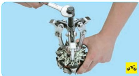
16. Проверьте легкость вращения подшипников. Если при вращении подшипника чувствуется люфт между кольцами, пережат или заклинивание тел качения, повреждены защитные кольца или есть потеки смазки, подшипник следует заменить. Для этого спрессуйте подшипник с вала ротора.
