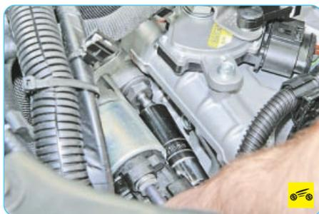
8. Выверните шпильку верхнего крепления стартера к блоку цилиндров.
