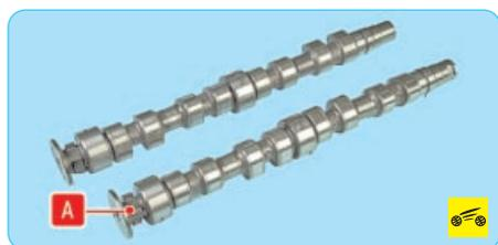
**Распределительные валы** чугунные, литые, установлены в корпусе 17, прикрепленном к головке блока болтами 18. На распределительном валу впускных клапанов установлено задающее кольцо **A** датчика положения распределительного вала.
