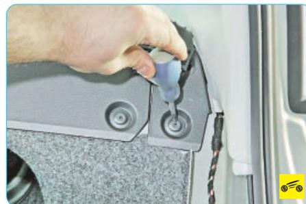
11. Выверните фиксаторы восьми пистонов крепления облицовки задней полки...
