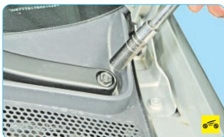
3. Отверните гайку крепления рычага стеклоочистителя...
