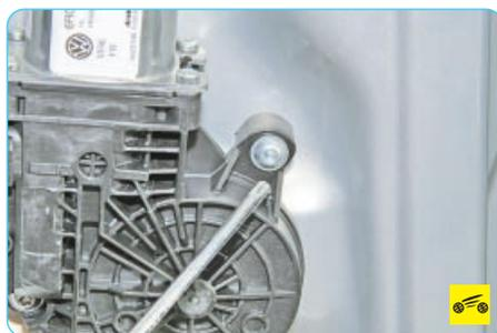
5. Выверните три болта крепления моторе-
