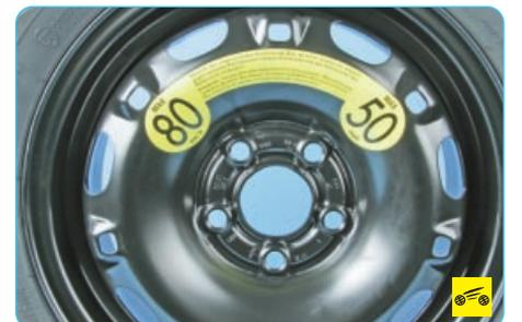
Если на ободе запасного колеса («докатки») приклеена этикетка с указанием максимально допустимой скорости (в данном случае 80 км/ч), то скорость движения автомобиля не должна превышать 80 км/ч, так как размер запасного колеса меньше, чем размер штатных колес. Постоянная эксплуатация автомобиля с таким запасным колесом недопустима. Его следует использовать только для того, чтобы добраться до шиномонтажной мастерской.
