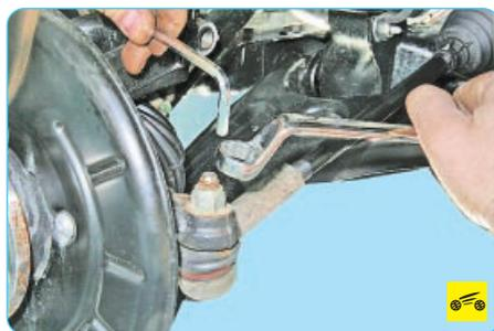
3. Удерживая палец шаровой опоры от проворачивания, отверните гайку крепления шарового пальца наконечника к рычагу поворотного кулака.
