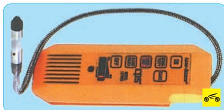
Для обнаружения мест утечки используются высокочувствительные галогеновые течеискатели со звуковой индикацией.
