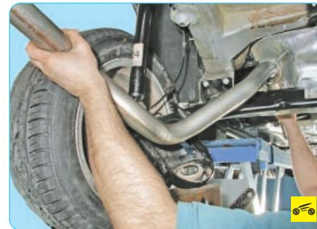
1. Снимите блок основного глушителя и промежуточной трубы (см. «Замена блока основного глушителя и промежуточной трубы», с. 110), а также блок дополнительного глушителя и приемной трубы (см. «Замена блока дополнительного глушителя и приемной трубы», с. 111).
