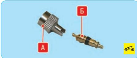
Так выглядят защитный колпачок **А** с ключом для затяжки золотника и золотник **Б** вентиля колеса.
