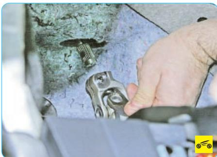
4. ...и снимите промежуточный вал с вала-шестерни рулевого механизма.
