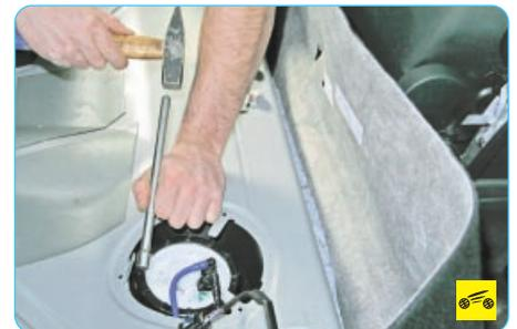
11. Отверните прижимное кольцо топливного модуля к топливному баку...
