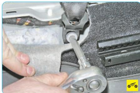
7. Выверните болт нижнего крепления ремня безопасности...
