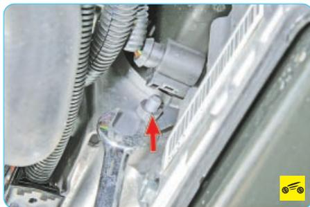
9. Отверните гайку крепления кронштейна держателя жгута проводов...
