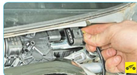
5. ...и отсоедините колодку жгута проводов от моторедуктора стеклоочистителя.
