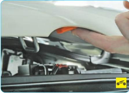
Так расположена лапка предохранительного крючка капота (для наглядности показано при открытом капоте).
