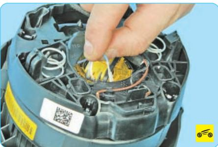
10. При необходимости снимите колодку жгута проводов с модуля подушки безопасности водителя, для этого отсоедините наконечник провода звукового сигнала от клеммы.
