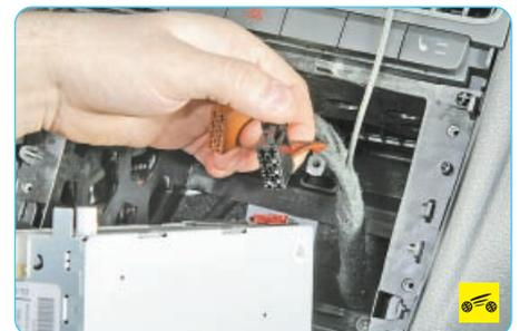
11. ...и отсоедините верхнюю колодку жгута проводов от разъема головного устройства аудиосистемы.
