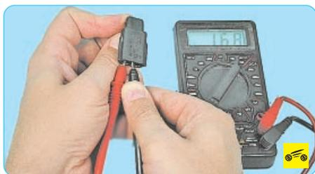
8. Присоедините щупы тестера к выводам датчика «3» и «4» и проверьте техническое состояние датчика (табл. 12.1).
