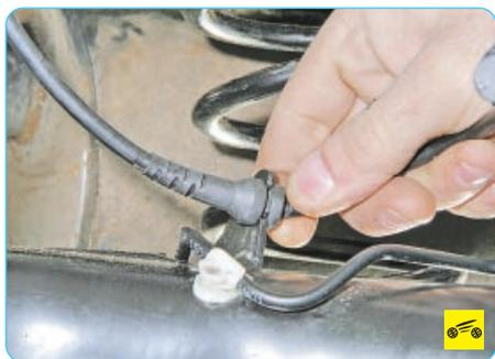
10. Выведите втулку провода датчика из прорези кронштейна продольного рычага.
