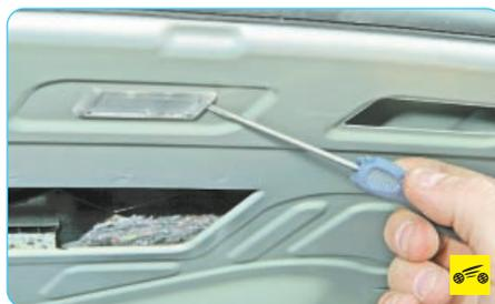
1. Подденьте отверткой плафон освещения багажного отделения...
