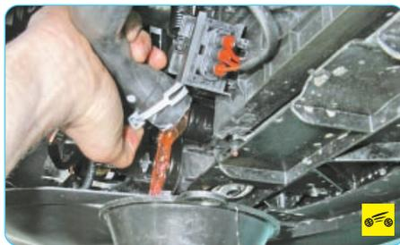
5. ...снимите подводящий шланг с патрубка радиатора и слейте жидкость из системы охлаждения в подготовленную емкость.
