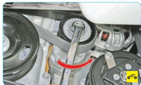
4. Для снятия ремня привода вспомогательных агрегатов ослабьте его натяжение, поворачивая ключом головку болта крепления натяжного ролика против часовой стрелки...
