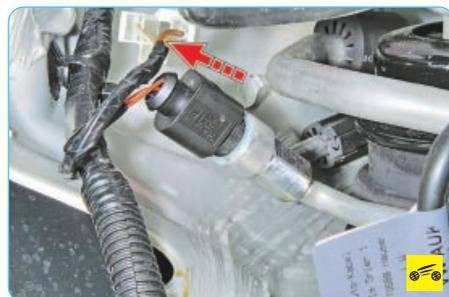
2. Отсоедините колодку жгута проводов от датчика давления, отжав ее фиксатор.
