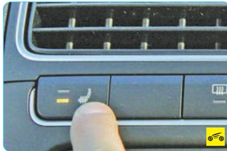
10 – выключатель электрообогрева сиденья водителя. При нажатии на клавишу выключателя включается первая ступень интенсивности электрообогрева и в клавише загорается контрольная лампа. При повторном нажатии на клавишу включается вторая ступень и в клавише загорается вторая контрольная лампа.
