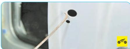
3. Проденьте в отверстие Г-образный крючок и заведите его за защелку крепления крышки ручки. Оттяните крючок назад настолько, чтобы защелка отстегнулась...
