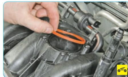
5. Извлеките уплотнительную прокладку дроссельного узла из пазов впускной трубы.
