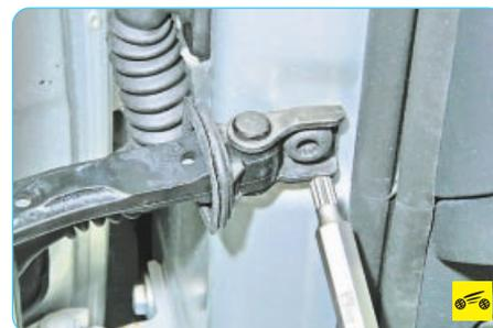
3. Выверните винт крепления ограничителя открывания передней двери к стойке кузова.
