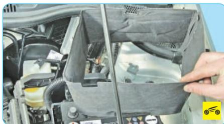
9. Снимите защитный чехол аккумуляторной батареи.
