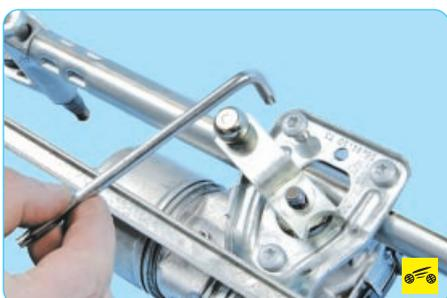
9. Выверните винт крепления моторередуктора к трапеции...
