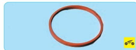
Прокладку дроссельного узла заменяйте новой при каждой разборке соединения.
