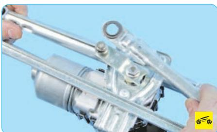
7. ...и снимите рычаг трапеции с кривошипа моторередуктора.
