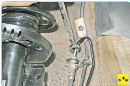
7. Отверните гайку крепления трубки к верхнему наконечнику...
