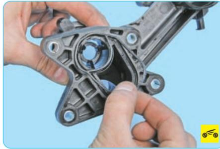
12. Снимите уплотнительную прокладку соединения водораспределителя и головки блока цилиндров, поврежденную прокладку замените новой.
