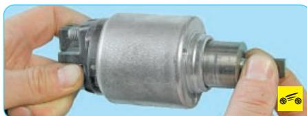
6. Вставьте якорь в корпус тягового реле. Проверьте легкость перемещения якоря.
