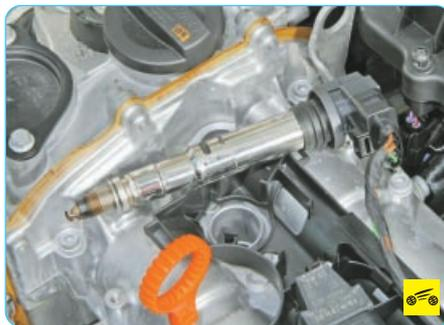
5. Вставьте в наконечник катушки запасную свечу зажигания и присоедините ее корпус к «массе» автомобиля любым удобным способом. Попросите помощника прокрутить стартером коленчатый вал двигателя. Аналогично проверьте другие катушки зажигания.
