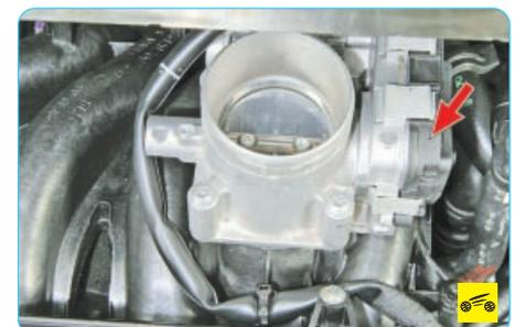
Специфической причиной рывков при установившемся движении автомобиля Volkswagen Polo седан может быть выход из строя датчика положения дроссельной заслонки, встроенного в крышку дроссельного узла. Дополнительными симптомами, подтверждающими неисправность этого датчика, являются:
