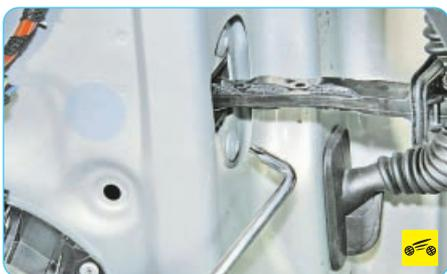
3. ...и два винта его крепления к переднему торцу двери.
