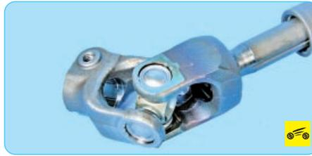
– деформация или повреждение промежуточного вала, люфт в карданных шарнирах, повреждение клеммового соединения нижнего шарнира с валом-шестерней рулевого механизма;
