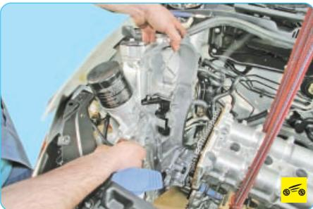
10. Снимите крышку цепи привода газораспределительного механизма (см. «Замена прокладки крышки цепи привода газораспределительного механизма», с. 75).
