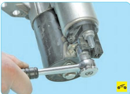
1. Отверните гайку крепления провода щеточного узла к контактному болту тягового реле...
