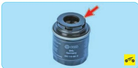
9. Смажьте уплотнительное кольцо нового фильтра чистым моторным маслом и заверните (руками без применения инструмента) фильтр на 4/5 оборота с момента соприкосновения уплотнительного кольца с фланцем блока цилиндров.
