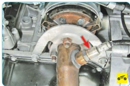
**Диагностический датчик концентрации кислорода** установлен в отверстие приемной трубы после катколлектора, работает по тому же принципу, что и управляющий датчик.
