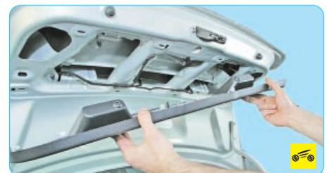
2. ...и, преодолевая сопротивление фиксаторов, снимите обивку.
