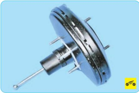
**Вакуумный усилитель 5** (см. рис. 9.2), установленный между механизмом педали и главным тормозным цилиндром, при торможении создает за счет разрежения во впускной трубе двигателя через шток и поршень первой камеры главного цилиндра дополнительное усилие, пропорциональное усилию от педали.
