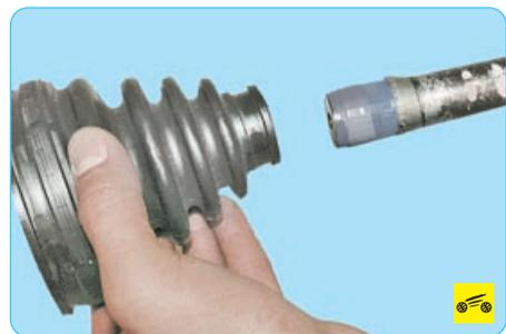
Для того чтобы при сборке не повредить чехол шарнира, оберните шлицевую часть вала изоляционной лентой.
