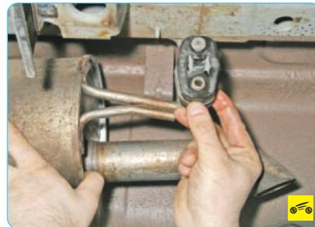
1. Снимите подушку подвески основного глушителя с его кронштейна...
