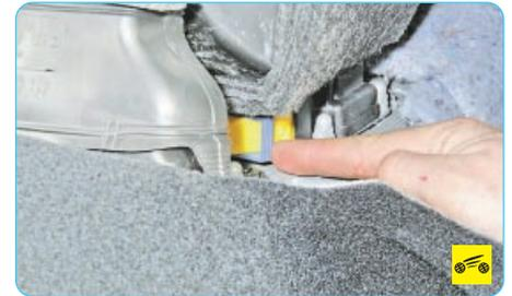
4. Подденьте фиксирующую скобу колдки жгута проводов электронного блока управления дополнительной системой пассивной безопасности...
