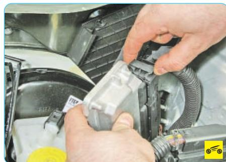
4. Снимите блок управления двигателем (см. «Снятие и установка электронного блока управления двигателем», с. 197).
