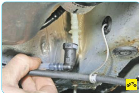
14. ...и отсоедините наконечник от трубки топливного бака.
