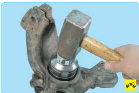
2. С помощью съемника выпрессуйте ступицу из подшипника. При отсутствии съемника можно воспользоваться торцовой головкой подходящего диаметра, которая упирается только на внутреннюю часть ступицы. Вероятнее всего, на ступице останется наружная половина внутреннего кольца подшипника. Воспользуйтесь съемником, чтобы снять ее со ступицы.
