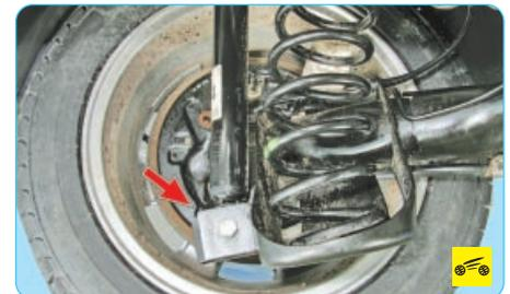
1. Резиновые втулки и затяжку резьбовых соединений нижних и верхних шарниров креплений амортизаторов.
