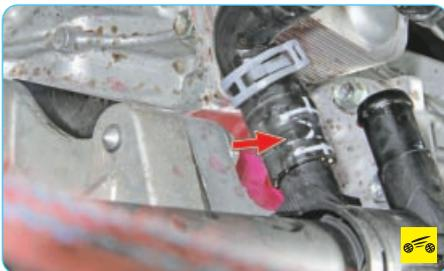
26. ...и отвода охлаждающей жидкости отопителя салона (см. «Снятие и установка водораспределителя», с. 98).
