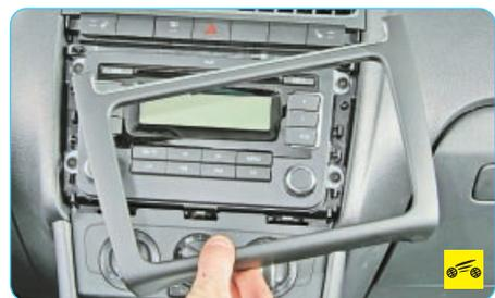
3. ...и, преодолевая сопротивление фиксаторов, снимите ее.
