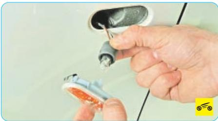
4. Проверните патрон лампы и снимите фонарь бокового указателя поворота.
