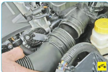
4. ...и снимите воздухоподводящий рукав.
