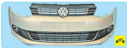
19. Установите передний бампер в порядке, обратном снятию.
