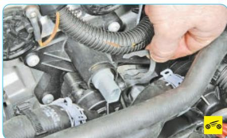
6. Подденьте отверткой и извлеките скобу крепления датчика.
