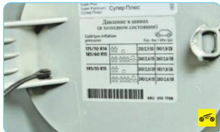
Наклейка со значениями давления воздуха в шинах расположена на внутренней стороне крышки люка наливной горловины топливного бака.
