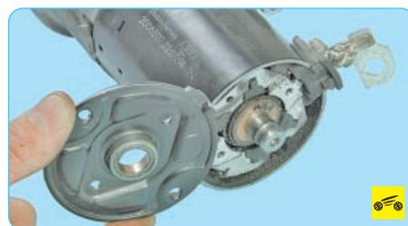
14. ...и снимите крышку стартера.
