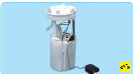
– неисправен топливный насос, расположенный в модуле топливного насоса.
