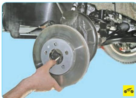
7. Снимите тормозной диск (см. «Замена тормозного диска», с. 172).
