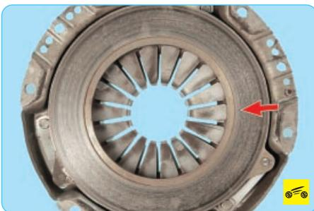
10. ...и нажимного диска, обращая внимание на отсутствие глубоких рисок, задигов, забоин, явных следов износа и перегрева. Замените дефектные узлы.
