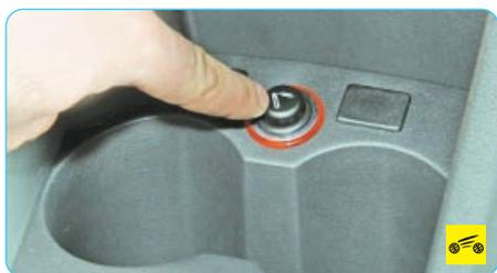
23 – прикуриватель (на рис. 1.7 закрыт рычагом селектора управления коробкой передач). Для пользования прикуривателем нажмите на кнопку его подвижной части. После нагрева спирали в течение 10–20 с подвижная часть автоматически со щелчком вернется в исходное положение.
