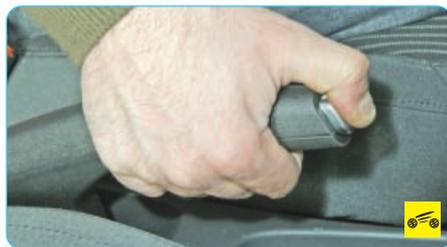
Для того чтобы растормозить автомобиль, потяните рычаг немного вверх, нажмите на кнопку в торце рукоятки рычага...
