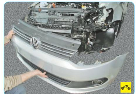
6. Снимите передний бампер (см. «Снятие и установка переднего бампера», с. 222).
