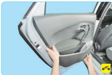
1. Поднимите стекло в крайнее верхнее положение и снимите обивку задней двери (см. «Снятие и установка обивки задней двери», с. 231).
