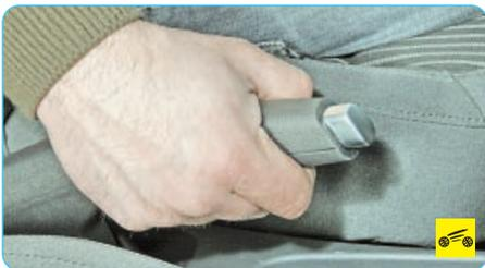
**Стояночный тормоз**, приводимый в действие механически, состоит из рычага, установленного на основании кузова между передними сиденьями, переднего троса с регулировочным устройством и уравнивателем, к которому присоединены два задних троса. Наконечники задних тросов соединены с разжимными рычагами тормозных механизмов задних колес. Разжимные рычаги воздействуют на задние тормозные колодки 7 после упора передних колодок 1 в тормозной барабан через распорную планку 3.
