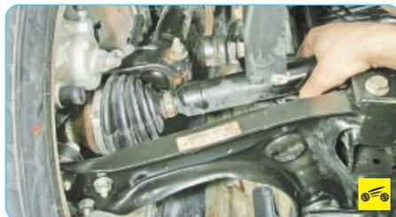
6. Проверьте поперечный люфт вала привода, покачивая его рукой. Ощутимого люфта не должно быть.
