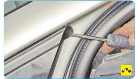
5. Подденьте отверткой край декоративной угловой накладки крыла и, преодолевая сопротивление пластмассовых фиксаторов, снимите ее.
