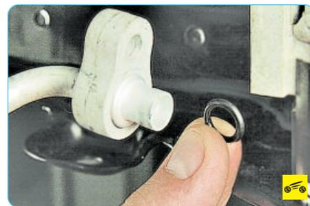
**При установке новые уплотнительные кольца фланцев трубопроводов обязательно смажьте маслом для компрессора кондиционера.**
