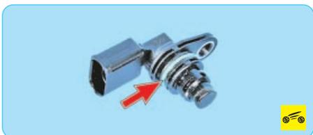
6. Замените уплотнительное кольцо, установите датчик положения распределительного вала двигателя в порядке, обратном снятию.
