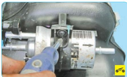
5. Выверните винт хомута крепления топливного фильтра...
