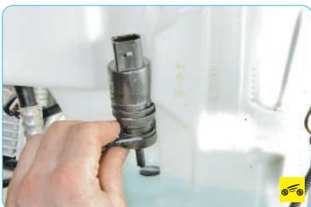
7. Извлеките штуцер электронасоса из втулки бачка стеклоомывателя.
