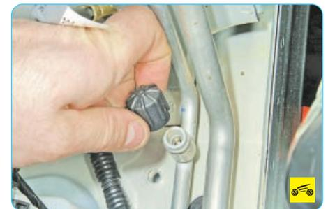
1. Отверните резьбовой колпачок любого из двух сервисных клапанов.
