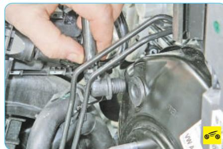
5. Извлеките наконечник вакуумного шланга из корпуса усилителя и снимите шланг в сборе с обратным клапаном.
