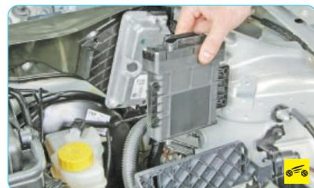
5. ...и снимите блок со щитка полки крепления аккумуляторной батареи.
