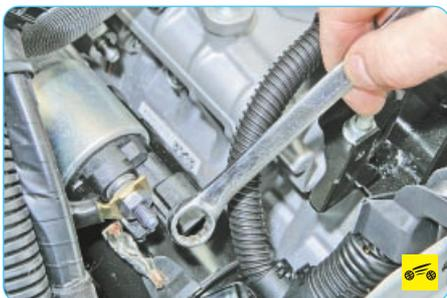
6. Отверните гайку наконечника контактного болта...
