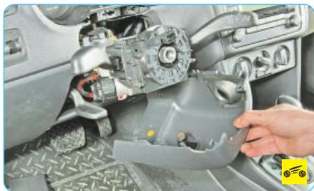
4. Снимите нижнюю и верхнюю части кожухов рулевой колонки (см. «Снятие и установка кожуха рулевой колонки», с. 154).
