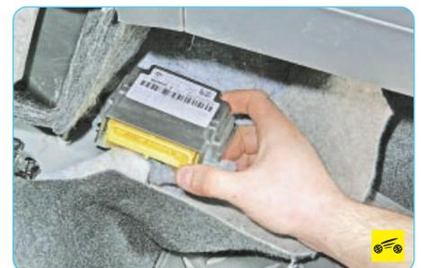
8. Снимите электронный блок управления дополнительной системой пассивной безопасности.
