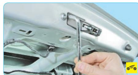
3. Выверите два винта крепления замка крышки багажника.
