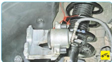
3. ...и закрепите суппорт переднего тормозного механизма проволокой на витках пружины передней подвески, не допуская скручивания или натяжения шланга.
