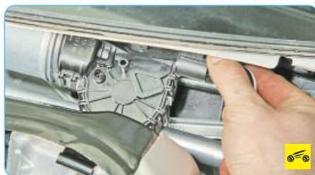
4. Сожмите фиксатор колодки жгута проводов...
