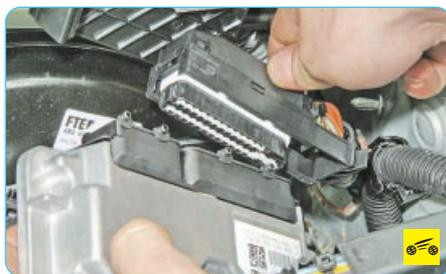
6. Аналогично отсоедините вторую колодку жгута проводов от блока управления двигателем и снимите блок.
