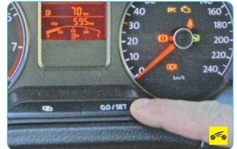
Показания маршрутного компьютера обнуляют нажатием на клавишу 20 (см. рис. 1.8) в комбинации приборов.
