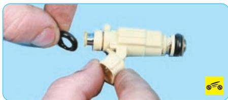
6. Замените уплотнительные кольца форсунок (независимо от их состояния). Установив новые уплотнительные кольца, смажьте их моторным маслом.
