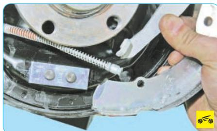
16. ...отсоедините наконечник троса от разжимного рычага...
