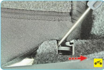
5. Разблокируйте два нижних крепления спинки сиденья, сдвинув фиксаторы назад от верткой (показано стрелкой).
