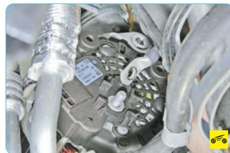
7. ...отсоедините клемму силового провода от шпильки генератора и отведите провод в сторону.
