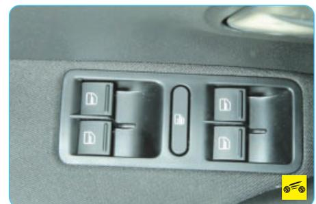
**1 – блок управления стеклоподъемниками** расположен в подлокотнике двери водителя (см. «Стеклоподъемники», с. 26).
