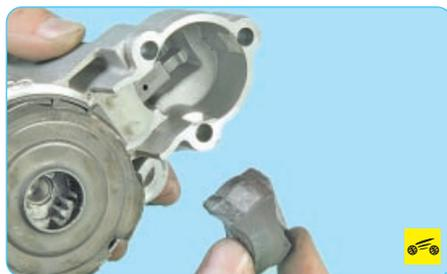
21. Снимите опору рычага привода.
