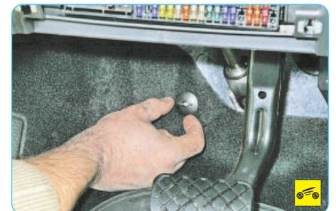
1. Под панелью приборов извлеките пистон крепления покрытия пола...
