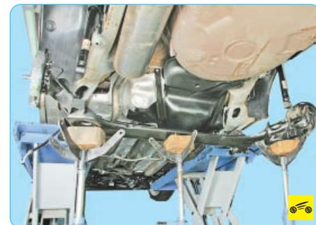
5. Снимите балку задней подвески (см. «Снятие и установка балки задней подвески», с. 149).
