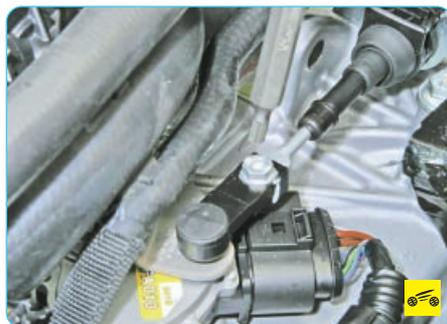
2. Ослабьте регулировочный болт наконечника троса управления коробкой передач.
