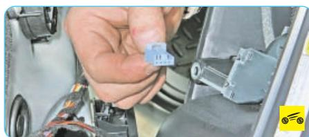
4. ...и отсоедините колодку от выключателя замка крышки багажника.
