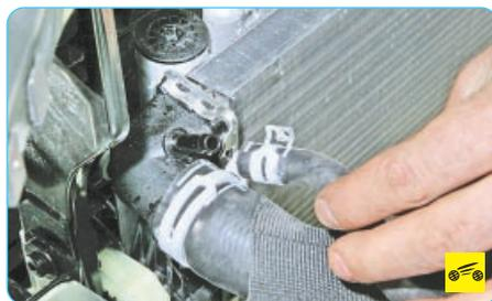
15. ...и отсоедините шланг системы подогрева вентиляции картера двигателя от патрубка радиатора.
