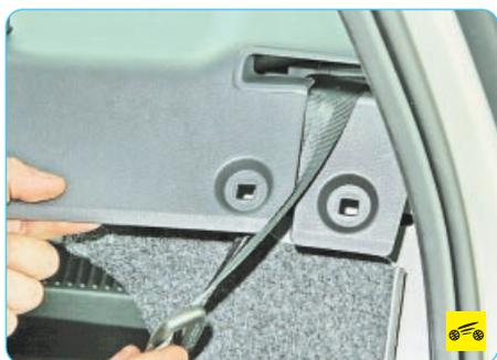
13. Извлеките ремни безопасности из отверстий в облицовке задней полки, продев их через специальные прорези.
