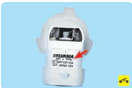
На цоколь противотуманной лампы нанесены информация о производителе, тип и характеристики лампы. Покупайте лампы того же типа.
