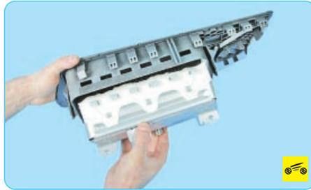
10. Выведите фиксаторы модуля подушки безопасности из пазов накладки панели приборов...
