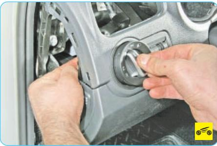
4. В положении «0» нажмите на рукоятку блока управления, немного поверните переключатель за рукоятку по часовой стрелке и выведите блок из отверстия в панели приборов.
