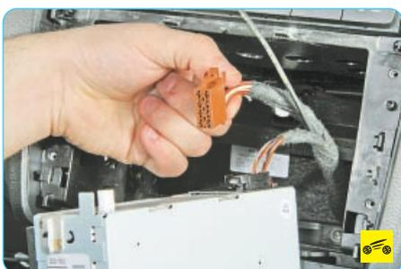
8. Отжав фиксатор, отсоедините нижнюю...
