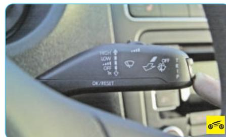
Информация маршрутного компьютера выводится на информационный дисплей 7 (см. рис. 1.8) в комбинации приборов нажатием на клавишу «TRIP», установленную в торце рычага правого подрулевого переключателя. Нажатием на верхний или нижний край клавиши на дисплее выводят различные режимы работы маршрутного компьютера.
