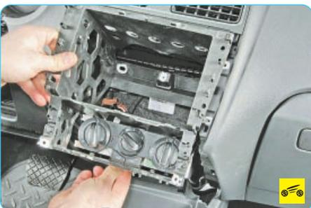
21. Снимите отсек для головного устройства аудиосистемы, извлекая блок управления системой отопления, кондиционирования и вентиляции салона из гнезда отсека.
