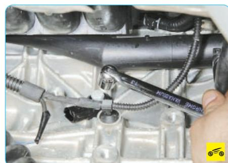
4. Выверните болт крепления датчика...
