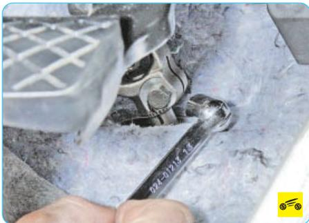
3. Выверните стяжной болт клеммового соединения промежуточного вала с валом-шестерней рулевого механизма...
