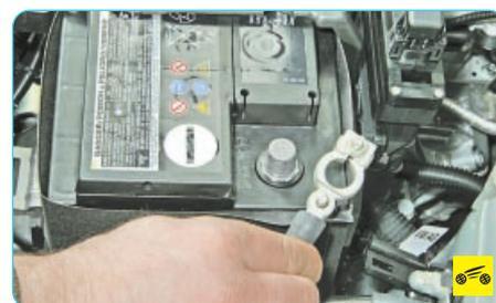
1. Отсоедините провод от клеммы «минус» аккумуляторной батареи.
