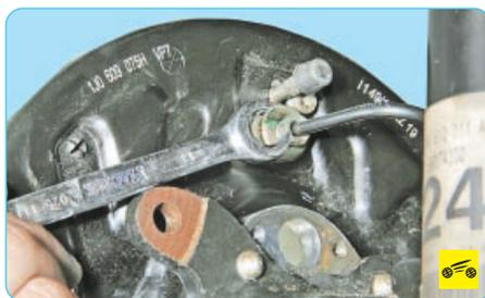
4. Отверните гайку крепления тормозной трубки к рабочему цилиндру...
