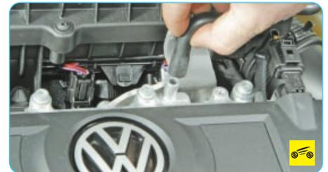
5. Снимите со штуцера корпуса распределительных валов шланг системы вентиляции картера.
