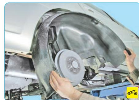
6. Снимите правый задний подкрылок (см. «Снятие и установка подкрылков колес», с. 224).
