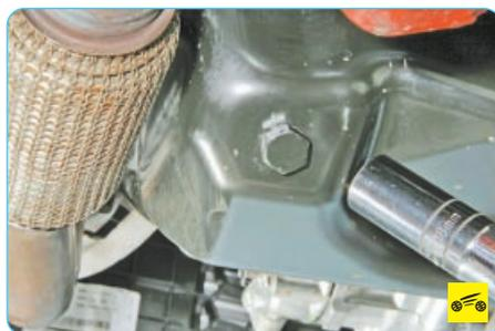
3. Ослабьте затяжку пробки сливного отверстия...
