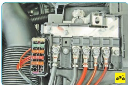
Для доступа к предохранителям и плавким вставкам монтажного блока, расположенного в моторном отсеке, выполните следующее.
