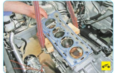
15. Снимите прокладку головки блока цилиндров.
