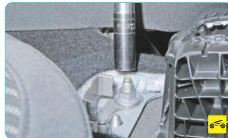
7. Отверните четыре гайки крепления кулисы селектора к основанию кузова...
