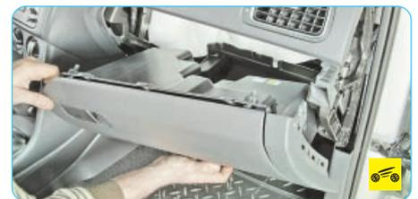
2. Снимите вещевой ящик (см. «Снятие и установка вещевого ящика», с. 240).
