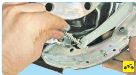
15. Сдвиньте вперед распорную пружину заднего троса привода стояночного тормоза...
