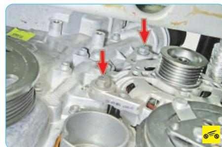
10. Выверните два болта крепления генератора к кронштейну блока цилиндров...
