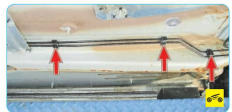
9. Проверьте крепление трубопроводов в держателях на днище кузова. Замените поврежденные держатели, так как их ослабление или поломка приводят к вибрации и, как следствие, к поломке трубопроводов.
