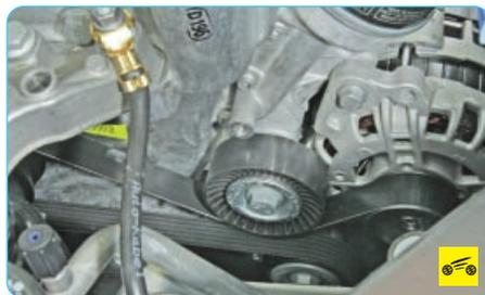
1. Проверьте, не оборван ли ремень привода генератора. Если произошел обрыв, замените ремень (см. «Снятие и установка ремня привода вспомогательных агрегатов», с. 70).
