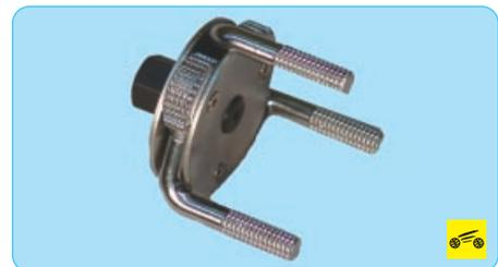
Если нет специального ключа для отворачивания масляного фильтра, можно воспользоваться универсальным ключом или съемником. Если и такого ключа или съемника нет, пробейте корпус фильтра отверткой и, используя ее как рычаг, отверните фильтр. Пробивайте фильтр как можно ближе ко дну, чтобы не повредить штуцер. Можно воспользоваться и свернутой вдвое полоской грубой наждачной бумаги, обернув ею фильтр и стронув его с места руками.
