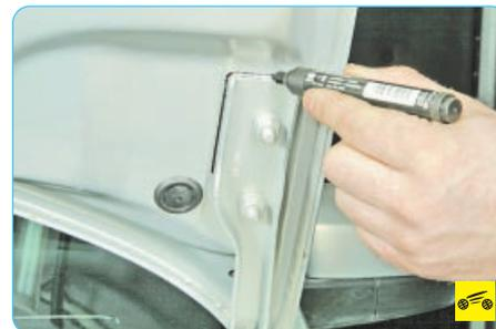
10. Если снимаете капот не для замены, пометьте его положение относительно петель, например, обведя петли по контуру фломастером.
