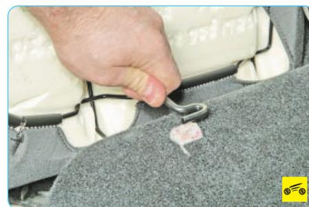
2. ...и, выведя два крюка крепления подушки из кронштейнов на основании кузова...
