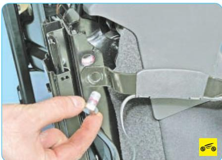
22. ...извлеките болт из отверстия и снимите замок ремня. Обратите внимание: на резьбу болта крепления переднего ремня безопасности нанесен анаэробный фиксатор резьбы. При установке замка ремня безопасности нанесите на резьбу болта новый фиксатор резьбы.
