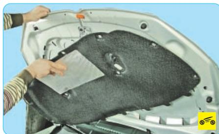
4. ...и снимите шумоизоляцию.
