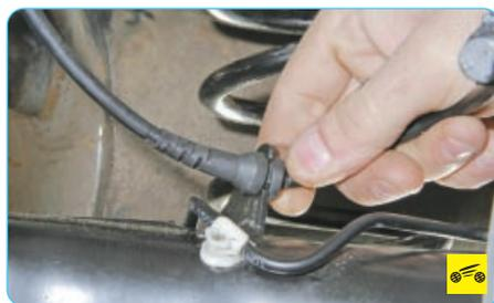
4. Выведите втулку провода датчика частоты вращения заднего колеса из паза кронштейна
