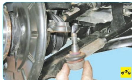
8. Отсоедините от поворотного рычага наконечник рулевой тяги (см. «Замена наружного наконечника рулевой тяги», с. 156).
