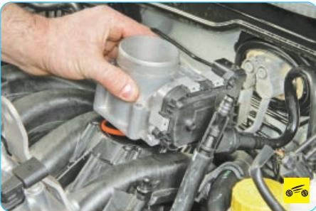
6. Снимите дроссельный узел (см. «Снятие и установка дроссельного узла», с. 107).
