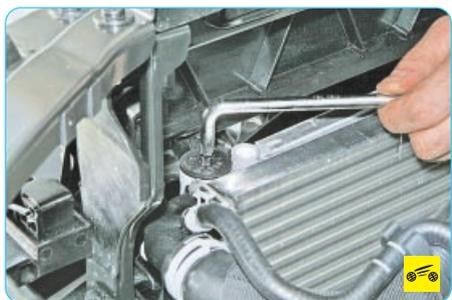
3. Ослабьте затяжку защитной крышки отверстия в верхнем торце ресивера-осушителя...
