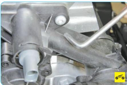
10. Выверните четыре болта крепления водораспределителя...
