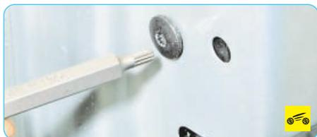
5. Выверните два винта крепления замка двери...
