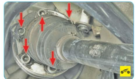
12. ...а на автомобиле с механической коробкой передач выверните шесть болтов (один болт на фото закрыт чехлом шарнира) крепления внутреннего шарнира привода к полуосевому фланцу, снимите три стопорные пластины болтов...
