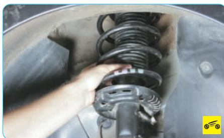
7. Проверьте состояние защитного чехла амортизаторной стойки.
