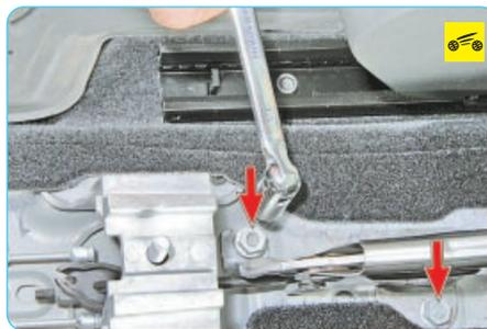
7. Отверните две гайки крепления рычага привода стояночного тормоза к основанию кузова...
