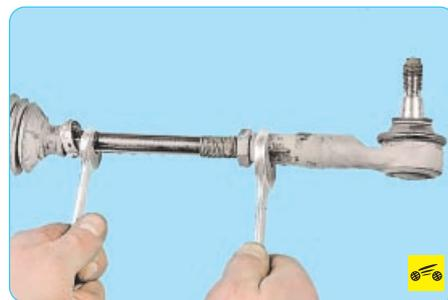
7. Удерживая ключом рулевую тягу, ослабьте затяжку наконечника рулевой тяги.
