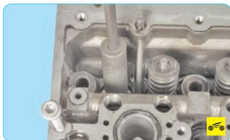
14. Установите съемник или оправку на новый маслоъемный колпачок. При отсутствии специального приспособления можно подобрать цилиндрическую оправку подходящего диаметра и напрессовать через нее колпачок легкими ударами молотка по оправке.
