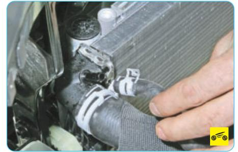
7. ...и отсоедините шланг системы подогрева вентиляции картера двигателя от патрубка радиатора.
