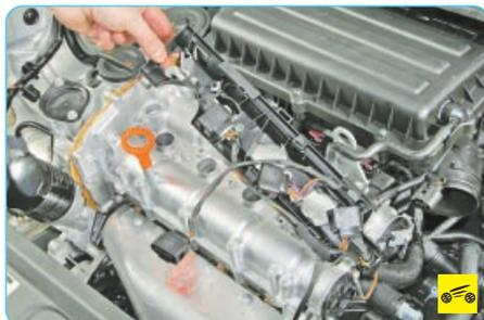
9. Снимите направляющую низковольтных проводов.
