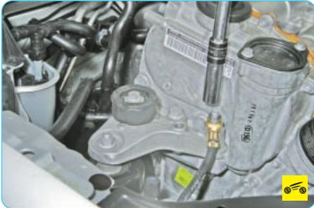
3. Отверните гайку крепления провода «массы» к шпильке крепления кронштейна правой опоры подвески силового агрегата...
