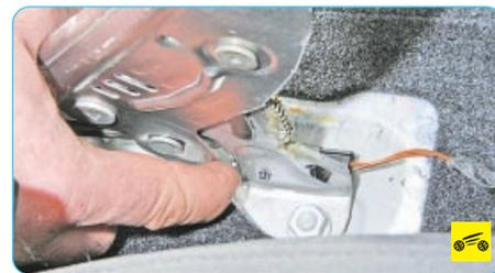
3. Отожмите фиксатор выключателя сигнальной лампы включения стояночного тормоза...
