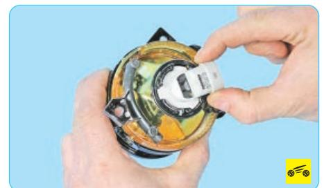
2. Поверните лампу противотуманной фары против часовой стрелки...
