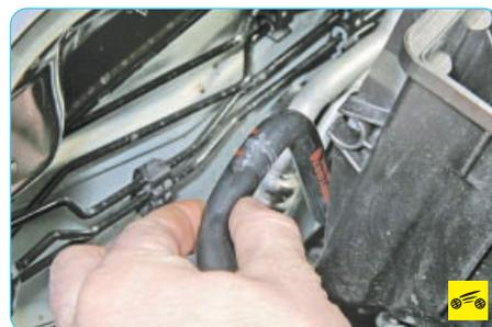
10. Извлеките шланг системы охлаждения из кронштейна на корпусе воздушного фильтра.
