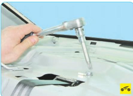
6. Выверните болт крепления инерционной катушки центрального ремня безопасности к кузову...
