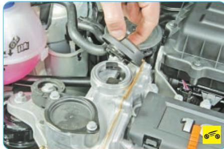
1. Снимите пробку маслоналивной горловины, повернув ее против часовой стрелки.
