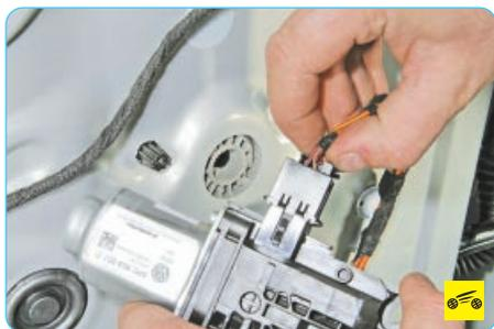
5. Отожмите фиксатор колодки жгута прово-
