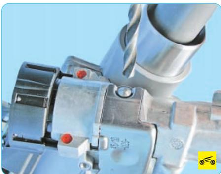
14. ...и нижнего креплений выключателя (замка) зажигания и снимите выключатель.
