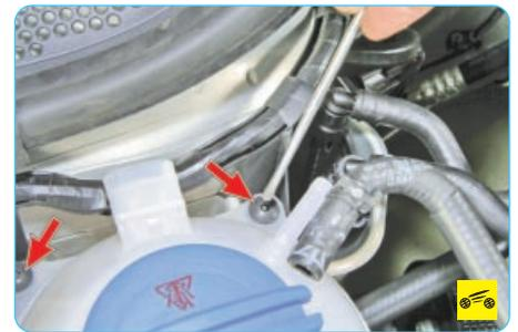
7. Выверните два винта крепления расширительного бачка...
