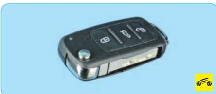
Поскольку автомобиль оснащен центральным замком, к нему приложены два ключа со встроенными пультами управления замками. Для удобства ношения в одежде рабочая часть ключа зажигания складывается внутрь пульта дистанционного управления.
