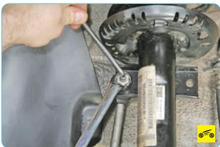
7. Удерживая от проворачивания, отверните гайку крепления пальца шарнира стойки стабилизатора к кронштейну амортизаторной стойки...
