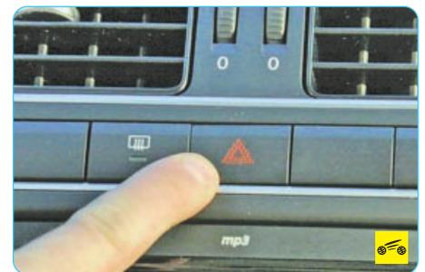
14 – выключатель аварийной сигнализации. При нажатии на клавишу выключателя загораются мигающим светом все указатели поворота и их контрольные лампы, установленные в комбинации приборов. При повторном нажатии на клавишу сигнализация выключается.
