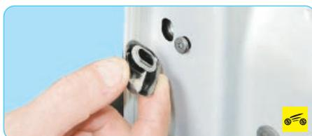
2. Снимите заглушку винта крепления выключателя замка двери.
