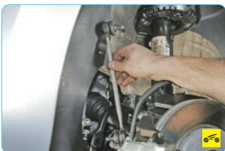
6. Снимите гайку, выведите палец нижнего шарнира из отверстия стабилизатора поперечной устойчивости и снимите стойку.
