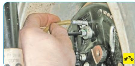
5. После этого наденьте резиновый шланг или прозрачную трубку на клапан выпуска воздуха рабочего цилиндра тормозного механизма правого заднего колеса и погрузите конец шланга в чистый прозрачный сосуд.
