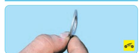
**Под гайкой крепления шкива генератора установлена пружинная шайба, не потеряйте ее.**
