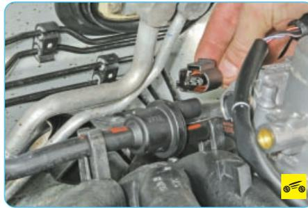
3. Сожмите фиксатор и отсоедините колодку жгута проводов от клапана.
