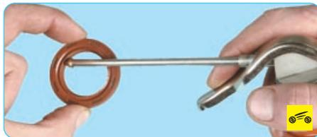
11. Смажьте рабочую кромку нового сальника моторным маслом и установите его в крышку цепи привода газораспределительного механизма, сориентировав рабочей кромкой внутрь двигателя.
