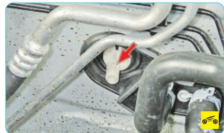
...и выведенную наружу через пластиковый переходник в нижней части правой стороны моторного щита, сливается под днище автомобиля. При высокой влажности окружающего воздуха под автомобилем может образоваться лужа воды, что является косвенным признаком исправности системы кондиционирования.
