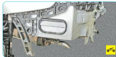
Со стороны улицы отверстия вытяжной вентиляции закрыты дефлекторами с лепестковыми клапанами, которые установлены в задней части кузова, в полости заднего бампера (вид со снятым задним бампером).
