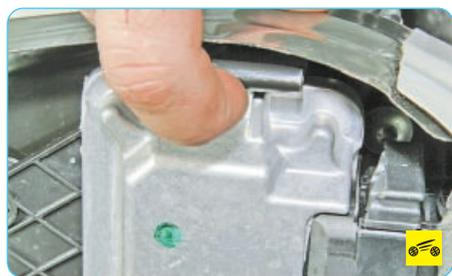
2. Отожмите фиксатор электронного блока управления двигателем...
