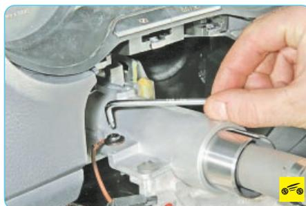
6. Выверните винт крепления провода «массы» и отсоедините провод от рулевой колонки.
