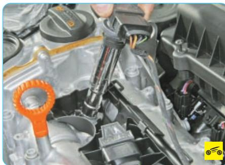
4. Если низковольтная цепь катушки зажигания исправна, проверьте наличие искры на свечах зажигания. Снимите катушку зажигания и опять присоедините к ней колодку жгута проводов.
