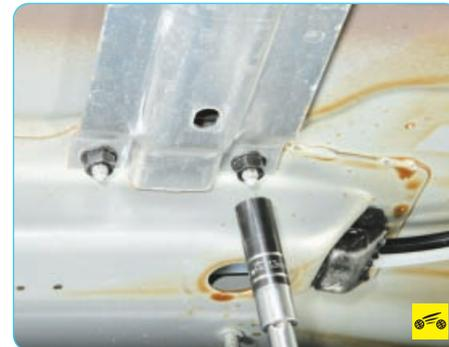
2. Отверните восемь гаек крепления поперечины основания кузова...
