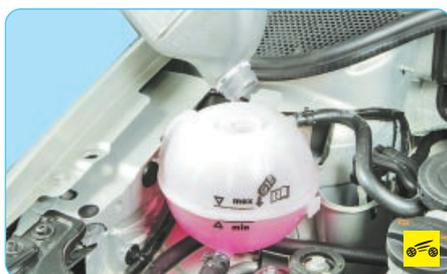
8. Залейте охлаждающую жидкость и удалите из системы охлаждения воздушные пробки (см. «Замена охлаждающей жидкости», с. 94).
