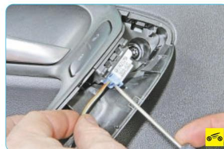
4. Отожмите отверткой фиксатор колодки жгута проводов...
