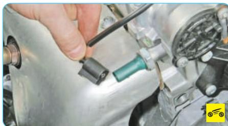
7. Отсоедините колодку жгута проводов от датчика сигнальной лампы аварийного падения давления масла.
