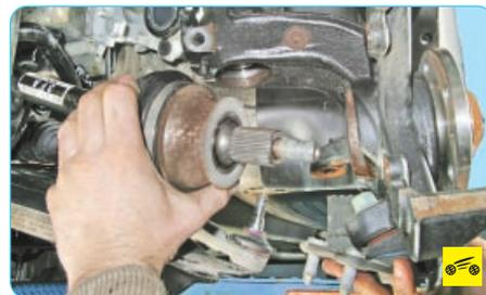
6. Извлеките хвостовик наружного шарнира привода из отверстия ступицы переднего колеса.
