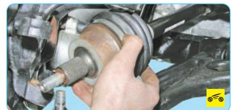
13. ...и снимите привод левого переднего колеса в сборе.
