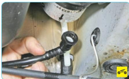
3. ...и отсоедините наконечник от штуцера топливного фильтра.
