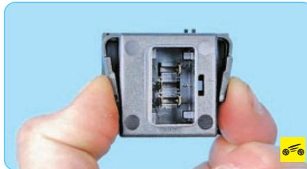
Так расположены фиксаторы блока управления электрокорректором света фар с обратной стороны.
