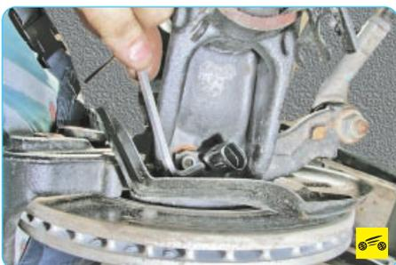
4. Выверните болт крепления датчика к поворотному кулаку...
