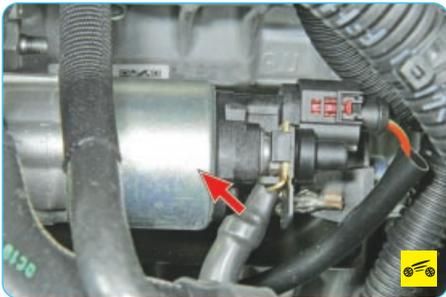
6. Стартер не выключается после пуска двигателя. Причины – неисправность муфты свободного хода стартера, спекание контактов тягового реле. В случае такой неисправности немедленно остановите двигатель!
