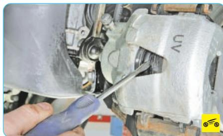
2. Вставив большую отвертку между внутренней тормозной колодкой и поршнем рабочего цилиндра, утопите поршень в цилиндр.
