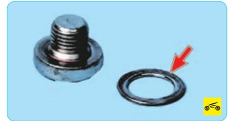
Проверьте состояние уплотнительной прокладки пробки, при необходимости замените ее.
