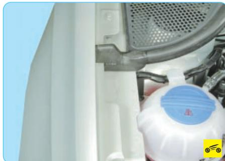
**Идентификационный номер на брызговике моторного отсека частично закрыт уплотнителем капота.**
