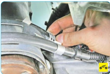
4. Отогните держатель провода управляющего датчика концентрации кислорода...
