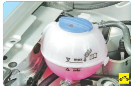
1. Расширительный бачок установлен в правой задней части подкапотного пространства на брызговики моторного отсека. Уровень охлаждающей жидкости должен быть между метками «MAX» и «MIN», нанесенными на стенку расширительного бачка.
