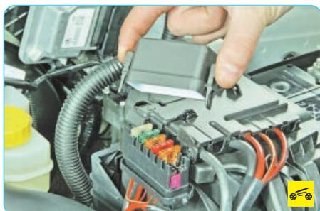
1. Сожмите фиксаторы крышки блока предохранителей и снимите крышку.
