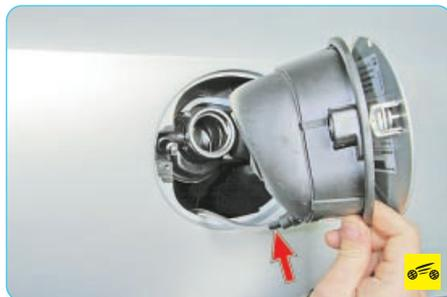
4. Снимите пароотводящую трубку со штуцера облицовки и снимите облицовку.
