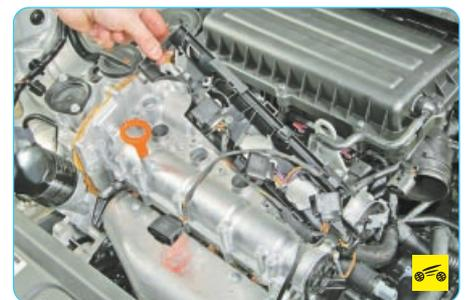
9. Снимите направляющую низковольтных проводов.
