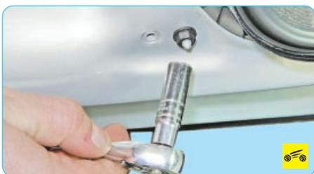
4. Отверните четыре гайки крепления стеклоподъемника к внутренней панели двери.
