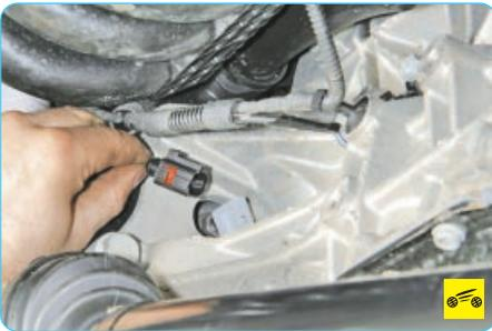
11. ...и датчика положения коленчатого вала.
