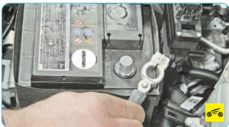
2. Отсоедините провод от клеммы «минус» аккумуляторной батареи.
