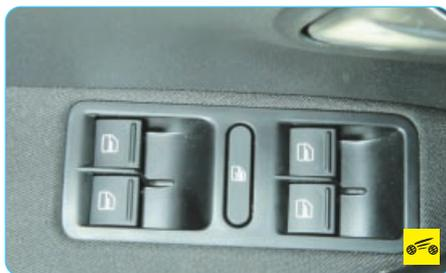
Центральный блок управления электростеклоподъемниками расположен в подлокотнике двери водителя. Блок объединяет выключатели электростеклоподъемников всех дверей.
