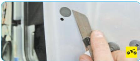
2. Снимите заглушку отверстия на торце двери.
