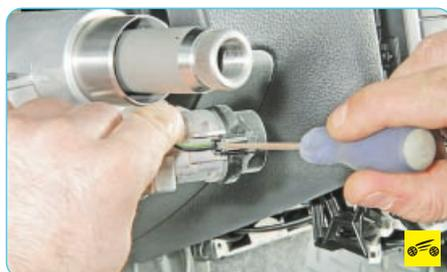
7. Отожмите отверткой фиксатор колодки жгута проводов антенного блока иммобилизатора...
