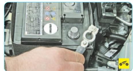
3. ...и отсоедините провод от клеммы «минус» аккумуляторной батареи.
