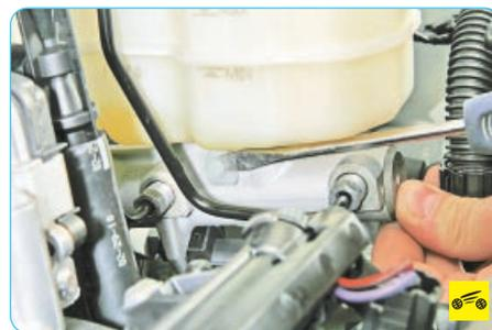
6. Подденьте отверткой шляпку фиксирующего стержня...
