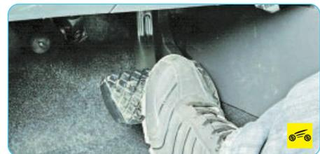
1. Установите правильные зазоры между тормозными колодками и барабанами тормозных механизмов задних колес. Для этого несколько раз сильно нажмите на педаль тормоза при опущенном до упора вниз рычаге привода стояночного тормоза.
