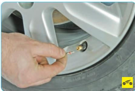
7. Нанесите на вентиль жидкость так, чтобы она заполнила собой полость вентиля. При дальнейшем образовании пузырьков и невозможности повернуть золотник замените его. Если замена не помогла, замените вентиль.
