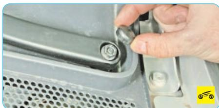
2. Подденьте отверткой край декоративного колпачка гайки крепления рычага и снимите колпачок.
