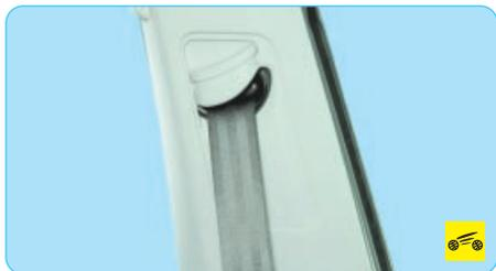
На автомобиле также предусмотрена регулировка передних ремней безопасности по высоте. Для регулировки положения ремня опустите или поднимите крепление ремня таким образом, чтобы ремень не касался шеи и не давил на плечо.
