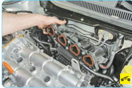
9. Снимите впускную трубу (см. «Замена прокладок впускной трубы», с. 79).
