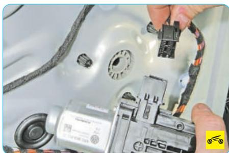
6. ...и, отсоединив колодку, снимите мото-
