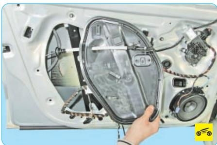
16. Снимите заглушку технологического окна внутренней панели двери.
