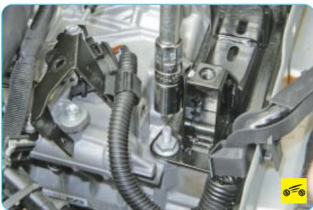
10. Выверните шпильку и три болта крепления кронштейна опоры к коробке передач...
