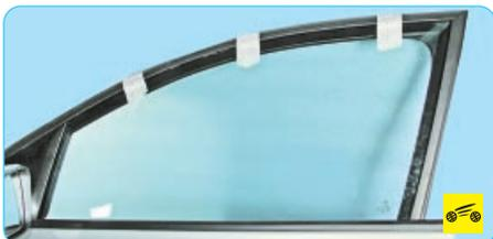
2. Выверните два винта крепления стекла к стеклоподъемнику (см. «Замена стекла передней двери», с. 230) и закрепите стекло в оконном проеме (например, малярным скотчем).
