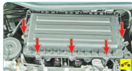
**Так расположены винты крепления крышки корпуса воздушного фильтра.**
