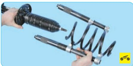
8. Снимите со штока амортизаторной стойки пружину...
