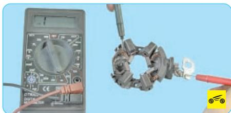
16. Осмотрите щеточный узел. Проверьте высоту щеток в щеткодержателе. Если их высота менее 7 мм, замените щетки или щеточный узел в сборе. Проверьте омметром изолированные держатели на замыкание с корпусом. Сопротивление должно стремиться к бесконечности.
