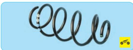
14. Замените пружину, если на ней обнаружены трещины или деформированы ее витки.
