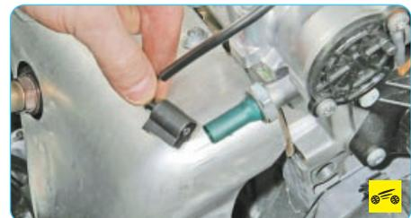
7. Отсоедините колодку жгута проводов от датчика сигнальной лампы аварийного падения давления масла.
