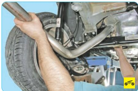
5. Снимите блок основного глушителя и промежуточной трубы, отведя вниз балку задней подвески.
