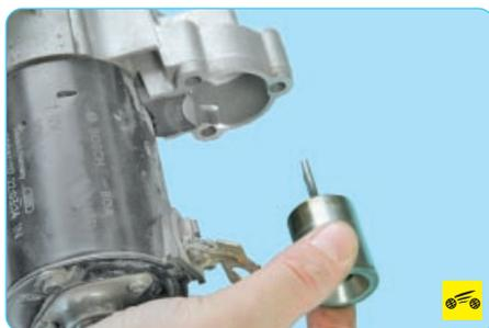
5. Снимите с рычага привода якорь тягового реле.
