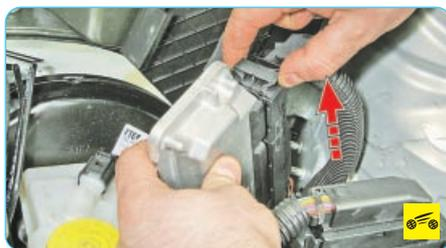
4. Выдвиньте вверх фиксатор колодки жгута проводов...
