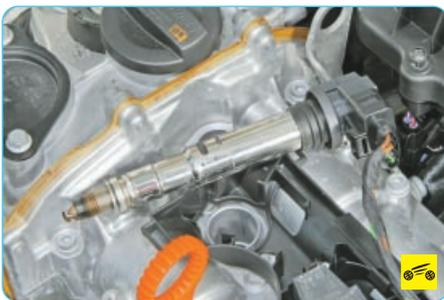
8. Присоедините поочередно корпуса свечей к «массе» автомобиля (например, к корпусу распределительных валов). Попросите помощника проверить стартером коленчатый вал двигателя.
