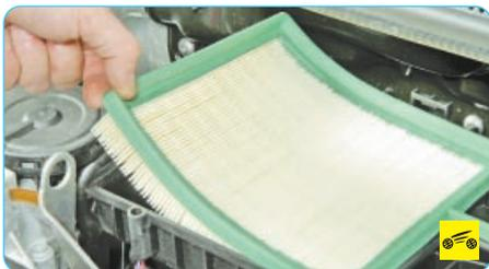
3. ...и извлеките фильтрующий элемент из корпуса воздушного фильтра.
