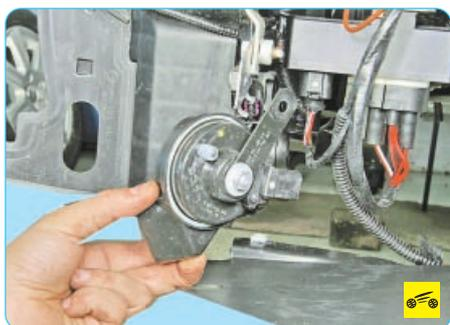
6. ...и снимите звуковой сигнал.
