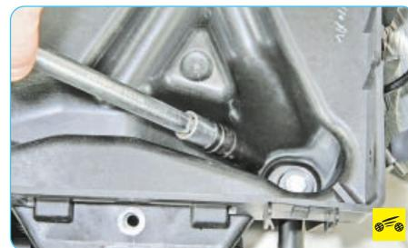
3. Выверните три болта крепления полки к кузову...
