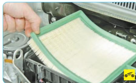
8. ...и извлеките фильтрующий элемент из корпуса воздушного фильтра.
