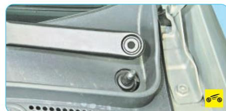
2. Снимите рычаги стеклоочистителя (см. «Снятие и установка рычагов стеклоочистителя ветрового стекла», с. 227).
