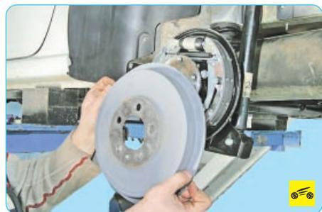
5. Для проверки степени износа тормозных колодок заднего тормозного механизма снимите заднее колесо и тормозной барабан (см. «Снятие и установка тормозного барабана», с. 173).
