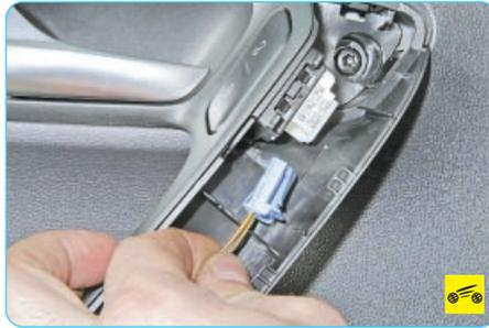
7. ...отсоедините колодку жгута проводов от выключателя центрального замка и снимите накладку.
