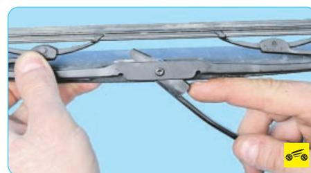
1. Отведите рычаг стеклоочистителя от ветрового окна, нажмите на фиксатор щетки...
