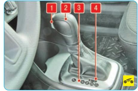
Рис. 1.11. Рычаг селектора управления автоматической коробкой передач: 1 – клавиша блокировки включения передачи; 2 – рукоятка рычага; 3 – шкала автоматического режима управления; 4 – шкала ручного режима управления
