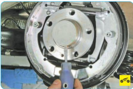
5. Подденьте отверткой крышку гайки ступицы...
