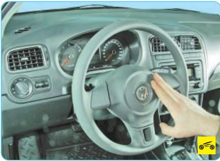
При нажатии на центральную накладку ступицы рулевого колеса включается звуковой сигнал. В ступице рулевого колеса смонтирована надувная подушка безопасности водителя.
