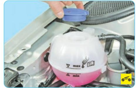
2. Для доливки охлаждающей жидкости отверните пробку расширительного бачка, вращая ее против часовой стрелки...
