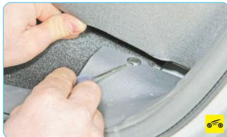
5. Поддев отверткой, извлеките пистон крепления задней облицовки порога...
