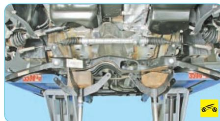
10. Сдвиньте поперечину передней подвески вперед по направлению движения и снимите поперечину, опуская ее вниз.
