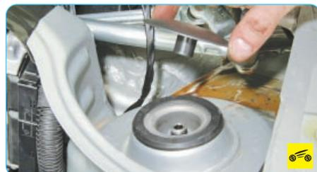
21. Снимите крышку гайки верхнего крепления амортизаторной стойки.
