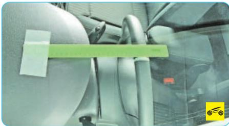
3. Не меняя положения линейки, поверните рулевое колесо вправо до момента поворота передних колес. В этом положении нанесите на обод рулевого колеса метку.
