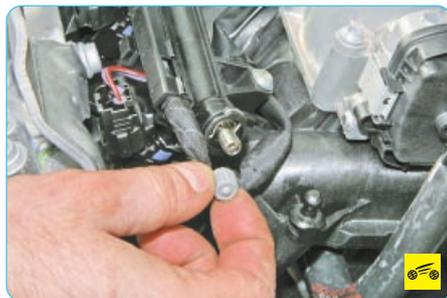
3. Отверните колпачок от сервисного клапана.
