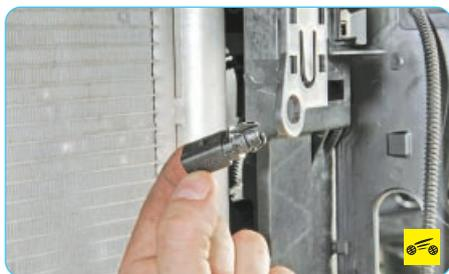
7. ...извлеките фиксатор из отверстия в кронштейне и снимите датчик.
