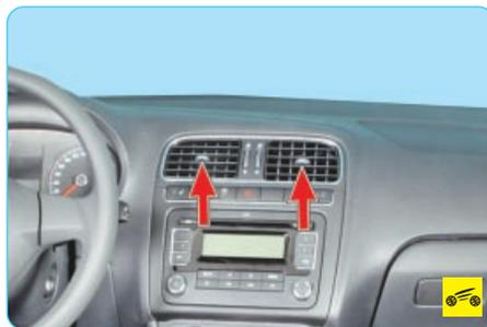
11, 15 – центральные сопла системы вентиляции и отопления салона предназначены для подачи воздуха в центральную часть салона. Соплами регулируют направление и интенсивность потоков воздуха, см. «Отопление (кондиционирование) и вентиляция салона», с. 22.
