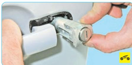
4. ...и снимите выключатель в сборе с тягой.
