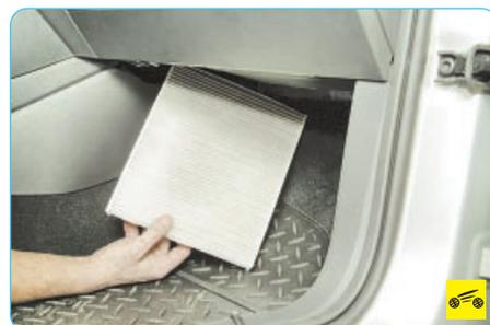
4. Извлеките фильтрующий элемент из гнезда, запомнив его положение в отсеке.
