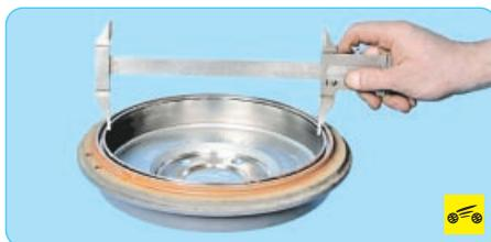
7. Измерьте диаметр рабочей поверхности тормозного барабана. Если он больше допустимого значения (см. табл. 9.1), замените барабан (см. «Снятие и установка тормозного барабана», с. 173).
