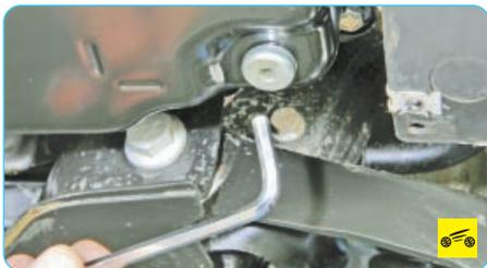
5. Выверните пробку отверстия для контроля уровня рабочей жидкости.
