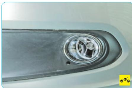
– лампа противотуманной фары, тип лампы HB4 (51 Вт);
