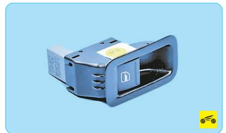
8. Установите выключатель управления стеклоподъемником в порядке, обратном снятию.
