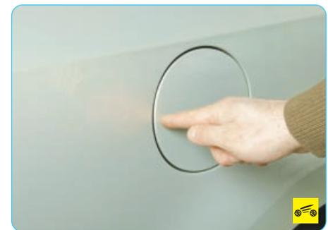
1. Для того чтобы открыть крышку люка наливной трубы топливного бака, нажмите на край крышки...
