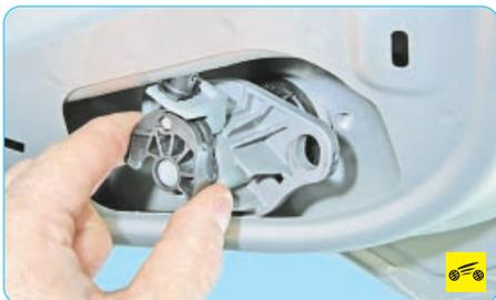
7. ...и снимите выключатель.
