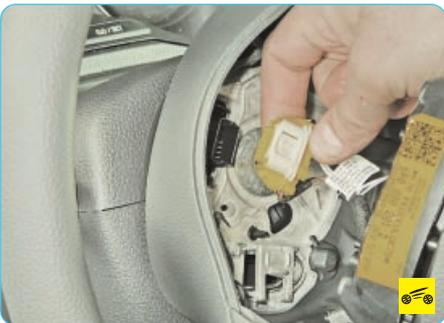
8. Отожмите фиксатор колодки жгута проводов модуля подушки безопасности водителя к разъему контактного кольца подушки безопасности и звукового сигнала.
