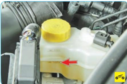
1. Проверьте уровень тормозной жидкости в бачке. Он должен находиться не ниже метки «MIN» (соединительного шва половин бачка).
