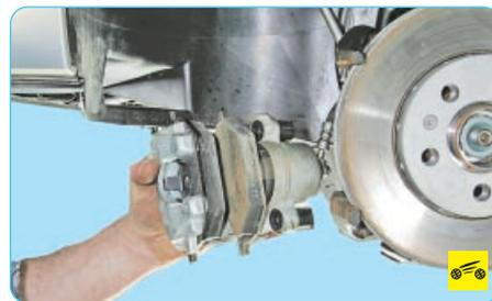
8. Снимите суппорт вместе с тормозными колодками с направляющей колодок, проследив за тем, чтобы не натягивался или не перекручивался тормозной шланг.
