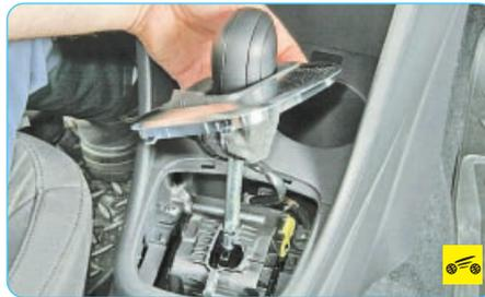
3. Снимите рамку чехла рычага селектора управления коробкой передач, преодолевая упругое сопротивление ее фиксаторов.
