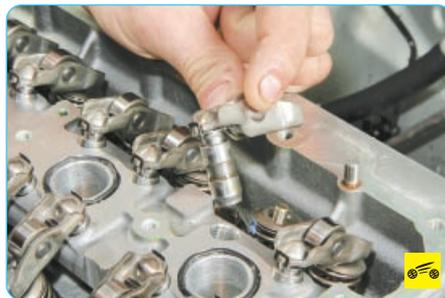
12. Снимите роликовые коромысла и гидрокompенсаторы, положите их на чистую поверхность.
