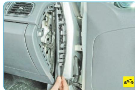
3. Подденьте отверткой боковую накладку панели приборов, возьмитесь за ее край и, преодолевая сопротивление пластмассовых фиксаторов, снимите накладку.
