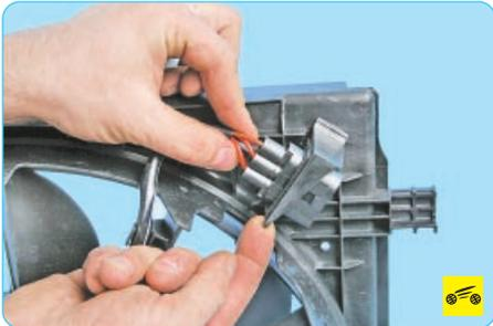
5. Отожмите фиксатор держателя колодки жгута проводов электровентилятора...
