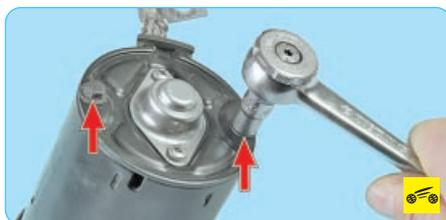
7. Выверните и извлеките два стяжных болта.
