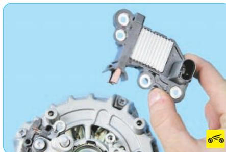
5. ...и снимите регулятор со щеточным узлом.
