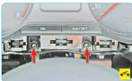
3. Выверните два винта крепления комбинации приборов к усилителю панели приборов.
