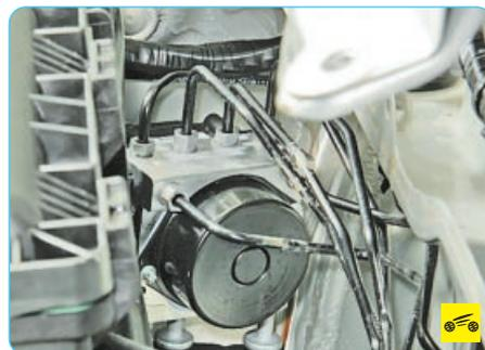
3. ...и гидроэлектронным блоком управления ABS.
