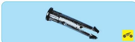
**Осмотрите оси петель крышки вещевого ящика, поврежденные оси замените новыми.**
