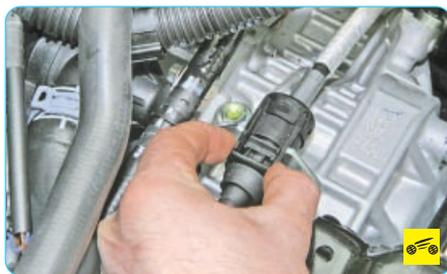
3. Сожмите два фиксатора наконечника оболочки троса управления коробкой передач...
