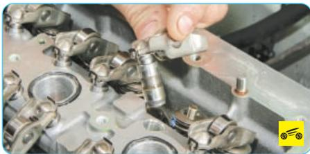
16. Снимите коромысла и гидрокомпенсаторы.
