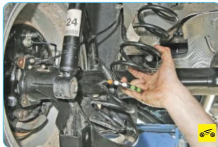
15. Снимите пружины (см. «Замена пружины задней подвески», с. 147).
