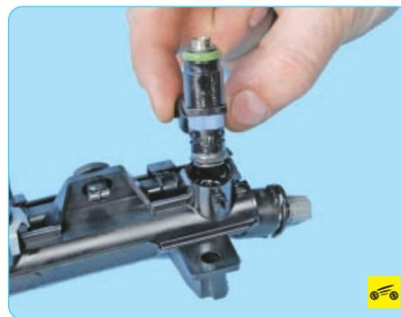
8. При необходимости снимите с рампы форсунки (см. «Снятие, проверка и установка топливных форсунок», с. 106).
