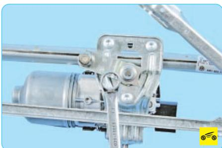
8. Отверните гайку крепления кривошипа моторередуктора.
