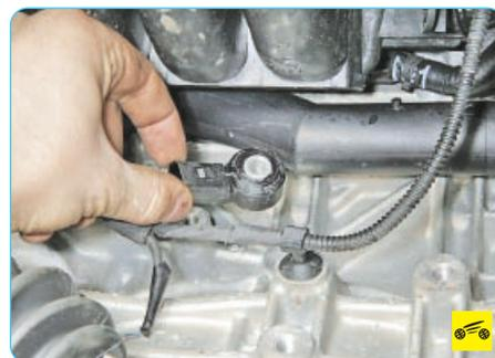
5. ...и снимите датчик.
