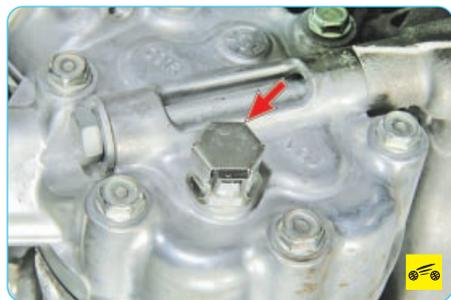
В нижней части задней крышки компрессора установлен клапан сброса аварийного давления. В случае роста давления в системе при отказе датчика давления или иных нештатных ситуациях, при превышении установленного максимума давления мембрана клапана разрушается и часть хладагента выбрасывается на улицу. Как правило, после этого аварийный клапан не обладает достаточной герметичностью. Поэтому после устранения причин, вызвавших рост давления и сброс хладагента, клапан подлежит обязательной замене.
