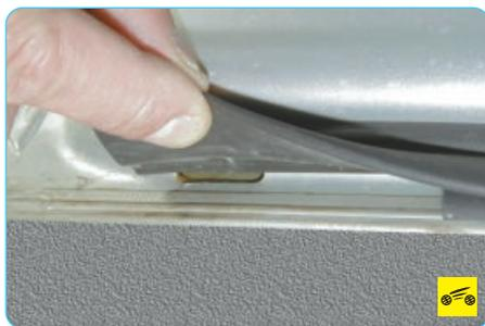
1. Для удаления воды в нижних кромках передних и задних дверей под уплотнителем, а также в порогах выполнены дренажные отверстия.
