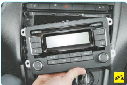
5. Извлеките головное устройство аудиосистемы из ниши панели приборов.
