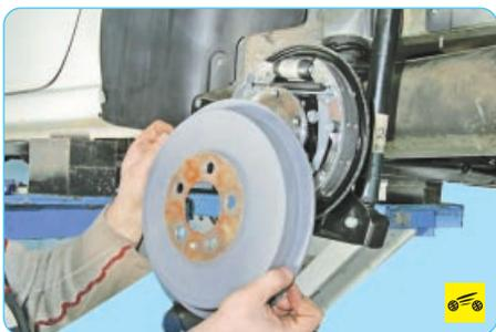
3. Снимите тормозной барабан (см. «Снятие и установка тормозного барабана», с. 173).
