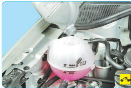
14. Залейте жидкость в систему охлаждения двигателя (см. «Замена охлаждающей жидкости», с. 94).
