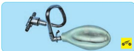
6. Плотно вставьте наконечник резиновой груши в конец шланга, которым он был присоединен к вакуумному усилителю, и сожмите ее. Воздух из груши должен по шлангу выйти через клапан. Отпустите грушу. Если она осталась в сжатом состоянии, значит, клапан исправен. При отсутствии груши можно продуть клапан ртом.
