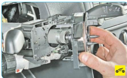
8. ...и снимите контактное кольцо звукового сигнала и подушки безопасности водителя.
