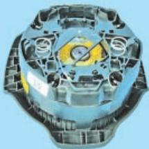
– модуль подушки безопасности водителя, расположенный в ступице рулевого колеса и состоящий из сложной оболочки подушки и газогенератора;
