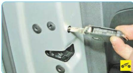
Если на заднем сиденье находятся дети, при открытой левой двери поверните по часовой стрелке ключом выключатель замка, а при открытой правой двери поверните выключатель против часовой стрелки и закройте дверь. В этом случае при ненажатой клавише блокировки можно открыть дверь только снаружи, внутренней ручкой замок отпереть невозможно.
