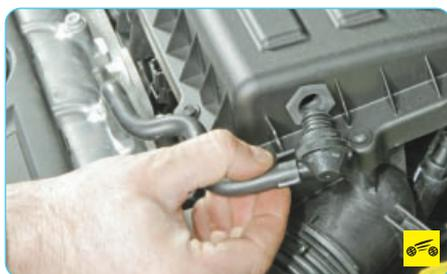
5. Извлеките из крышки корпуса воздушного фильтра клапан системы вентиляции картера.
