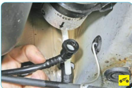
12. ...и отсоедините наконечник от штуцера топливного фильтра.
