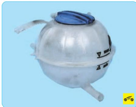
**Расширительный бачок** служит для компенсации изменяющегося объема охлаждающей жидкости в зависимости от ее температуры. Он изготовлен из полупрозрачной пластмассы. На его стенки нанесены метки «MIN» и «MAX» для контроля уровня охлаждающей жидкости, а сверху расположена наливная горловина, закрытая пластмассовой пробкой.
