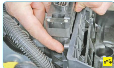
4. Отожмите два фиксатора впереди и сзади блока...
