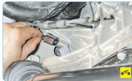
4. ... и отсоедините колодку жгута проводов от датчика положения коленчатого вала.
