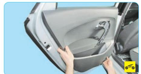
1. Поднимите стекло в крайнее верхнее положение и снимите обивку задней двери (см. «Снятие и установка обивки задней двери», с. 231).
