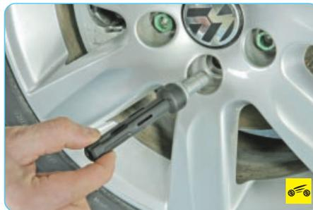
...одновременно является приспособлением для облегчения извлечения болтов крепления колеса из колесного диска и для их обратной установки.
