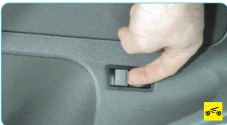
Помимо этого разблокировать замок крышки багажника можно клавишей выключателя на обивке двери водителя. Для разблокирования замка потяните клавишу на себя.
