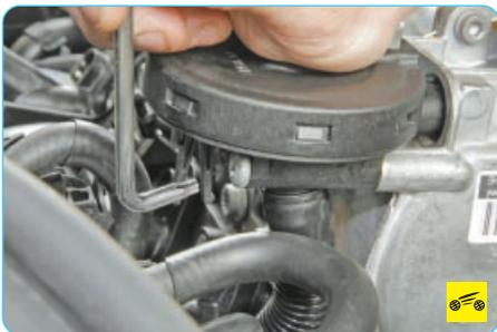
6. Выверните два болта крепления маслоотделителя к головке блока цилиндров и извлеките болты из отверстий.
