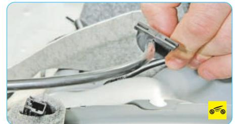
6. Извлеките держатель провода датчика частоты вращения заднего колеса из паза в кронштейне кузова.
