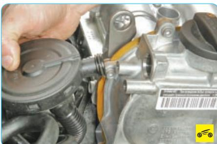
28. Снимите маслоотделитель системы вентиляции картера двигателя (см. «Очистка системы вентиляции картера», с. 67).
