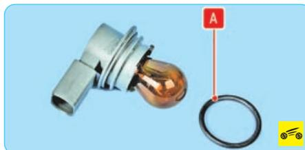
4. Установите новую лампу в патрон, а патрон в блок-фару. При необходимости замените резиновую уплотнительную прокладку **A**. Для замены лампы габаритного огня выполните следующее.
