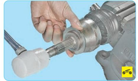
15. Установите чехол наружного шарнира и шарнир в порядке, обратном снятию. При установке шарнира на вал напрессовывайте шарнир ударами молотка по хвостовику шарнира через выколотку из мягкого металла или с помощью резинового молотка до момента фиксации обоймы шарнира стопорным кольцом, установленным на валу привода.
