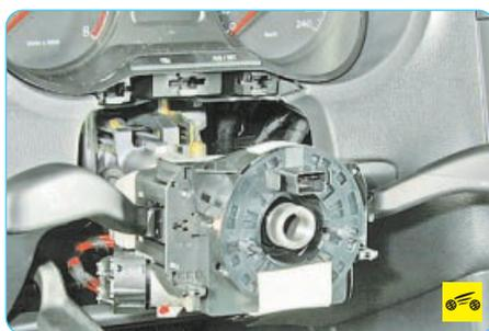
5. Зафиксируйте скотчем или изоляционной лентой от проворачивания контактное кольцо звукового сигнала и подушки безопасности водителя.
