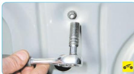
4. Отверните две гайки крепления стеклоподъемника к внутренней панели двери.
