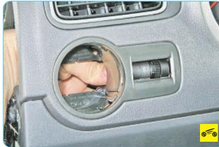
3. Просунув руку в проем торца панели приборов, сожмите фиксаторы блока управления электрокорректором света фар...
