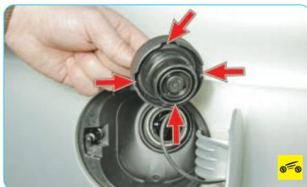
В отбортовке пробки выполнены четыре выреза для ее установки на крышку люка топливного бака.
