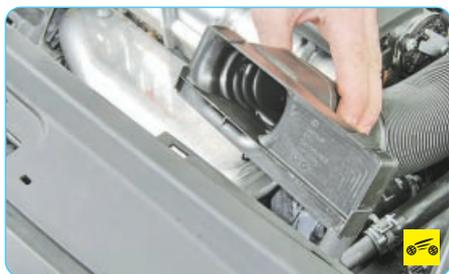
3. Снимите воздухоподводящий рукав (см. «Снятие и установка воздушного фильтра и воздухозаборника», с. 102).
