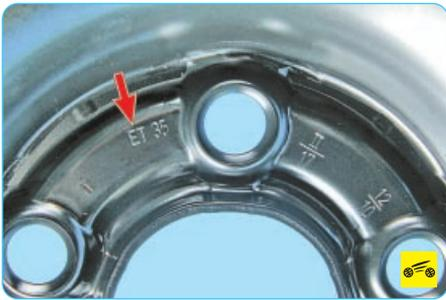
На автомобиль Volkswagen Polo седан устанавливают стальные диски с вылетом колеса ET, равным 35 мм...
