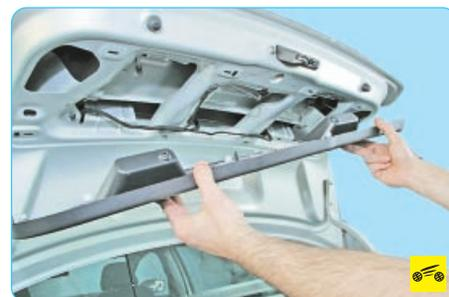
2. Снимите обивку крышки багажника (см. «Снятие и установка обивки крышки багажника», с. 234).
