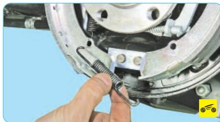
13. Снимите нижнюю стяжную пружину, выведя ее отогнутые концы из отверстий в ребрах колодок.
