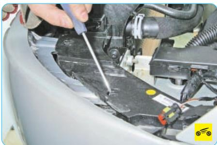
14. Сожмите по два фиксатора крепления бампера в нишах блок-фар и четыре фиксатора крепления облицовки радиатора.
