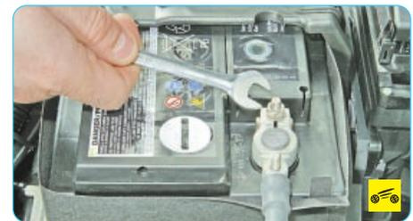
2. Ослабьте затяжку гайки стяжного болта наконечника...
