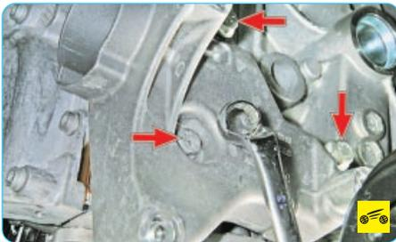
10. При необходимости (например, при повреждении резьбовых отверстий для крепления компрессора) выверните три болта крепления кронштейна компрессора к блоку цилиндров двигателя...
