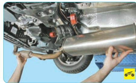
11. ...и снимите блок дополнительного глушителя и приемной трубы.
