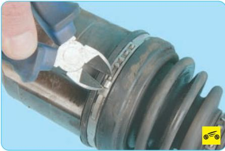
28. Для разборки и замены **внутреннего шарнира типа Трипод** привода автомобиля с **автоматической коробкой передач** снимите хомут крепления чехла шарнира к его корпусу, для чего отсоедините отверткой или перекрутите бокорезами замок хомута.
