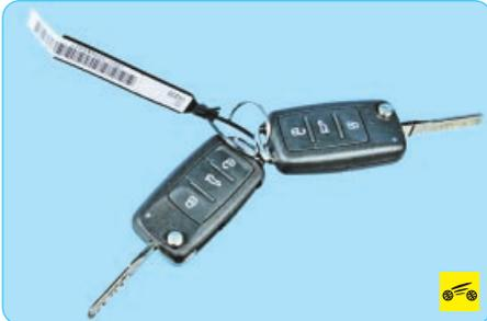
К автомобилю прикладывают два ключа, каждым из которых можно отпереть и запереть замки дверей (крышки багажника) и включить зажигание, а также бирку с номером серии ключей.
