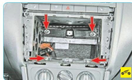
Так расположены верхние винты крепления отсека для головного устройства аудиосистемы.
