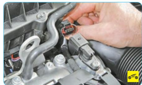
6. Отсоедините колодку жгута проводов от датчика положения распределительного вала.
