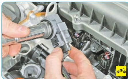
6. Нажмите на фиксатор колодки жгута проводов...
