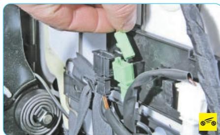
8. ...и отсоедините колодку жгута проводов от выключателя сигнальной лампы непристегнутого ремня безопасности.
