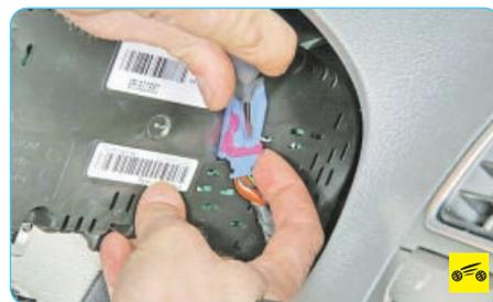
6. Отожмите фиксатор запорной скобы колдки жгута проводов комбинации приборов...
