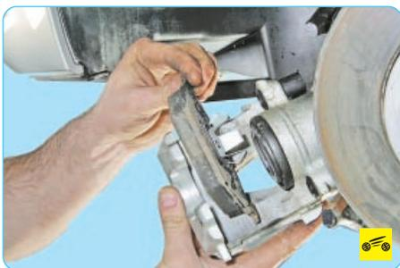
10. ...и внутреннюю колодку, извлекая ее пружинный фиксатор из полости поршня.
