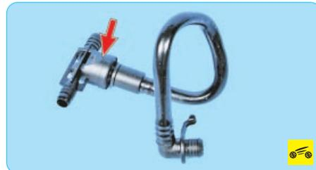
**К шлангу вакуумного усилителя присоединен обратный клапан.**
