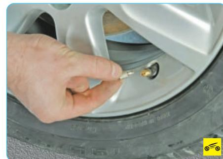
6. Если вы заметили, что давление воздуха в шинах постоянно падает, попробуйте потуже завернуть золотник с помощью колпачка с ключом.
