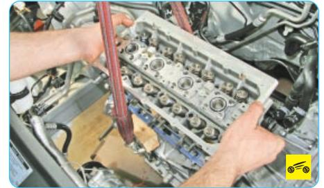
14. Снимите головку с блока цилиндров.
