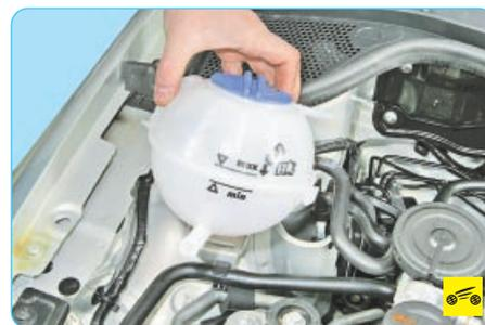
3. Снимите расширительный бачок (см. «Снятие и установка расширительного бачка», с. 96).
