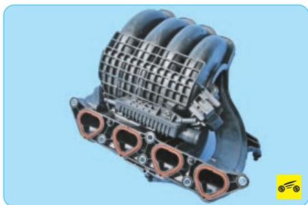
**Впускная труба** по своим каналам обеспечивает поступление необходимого количества воздуха непосредственно в камеры сгорания каждого из четырех цилиндров.
