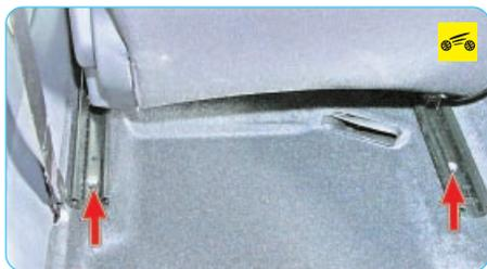
3. Сдвиньте сиденье до упора вперед и выверните два задних винта крепления направляющих салазок сиденья к основанию кузова.
