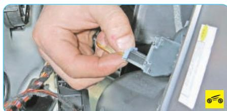
3. Нажмите на фиксатор колодки жгута проводов...
