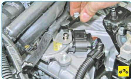
2. В моторном отсеке снимите наконечник троса управления коробкой передач с рычага блока управления, преодолевая упругое сопротивление пружинного фиксатора.
