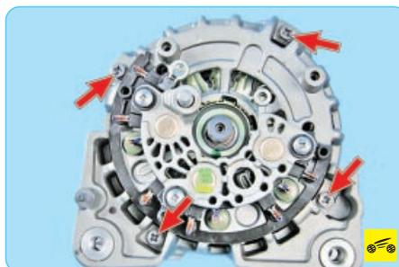
7. Выверните четыре стяжных болта крышек генератора.
