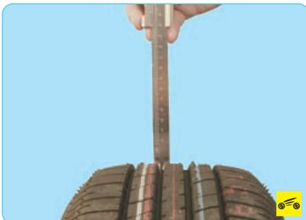
8. Измерьте штангенциркулем остаточную глубину протектора. Если глубина протектора 1,6 мм или меньше, замените шину.
