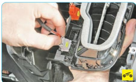
6. Отожмите фиксатор колодки жгута проводов выключателя обогрева переднего сиденья...
