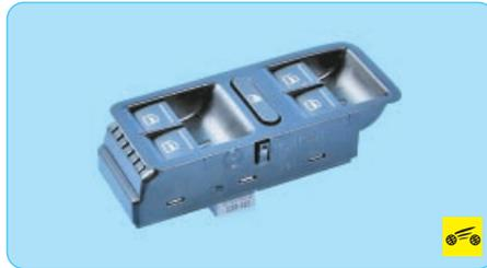
8. Установите блок управления стеклоподъемниками в порядке, обратном снятию.
