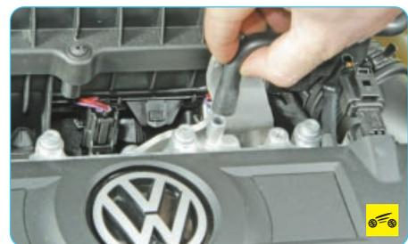
5. Снимите со штуцера корпуса распределительных валов шланг системы вентиляции картера.
