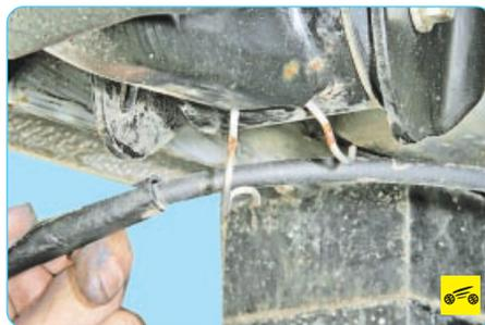
11. Снимите трос с поддерживающих крючков на кронштейне рычага балки задней подвески...
