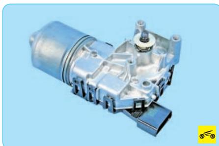
13. Установите моторередуктор и все детали в порядке, обратном снятию.
