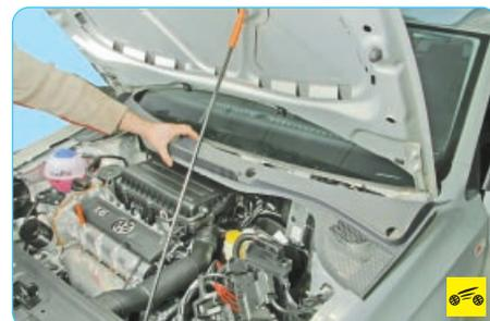
6. Снимите рычаги стеклоочистителя и решетку короба воздухопритока (см. «Снятие и установка решетки короба воздухопритока», с. 226).
