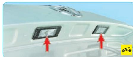
Для замены лампы в фонарях освещения номерного знака выполните следующие операции.
