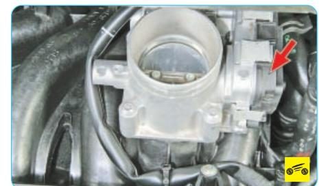
– датчика положения дроссельной заслонки – потеря мощности, рывки и провалы при разгоне, неустойчивая работа в режиме холостого хода;
