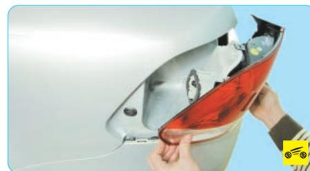
6. Преодолевая сопротивление фиксаторов, сдвиньте задний фонарь назад и снимите его с автомобиля.
