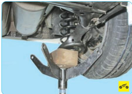
5. Если вы заменяете амортизатор на подъемнике, установите под балку задней подвески опоры и опустите автомобиль, слегка нагрузив подвеску. При работе на смотровой канаве эта операция не требуется.
