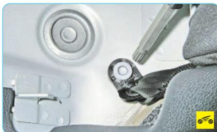
2. Выверните болт нижнего крепления заднего ремня безопасности к кузову...
