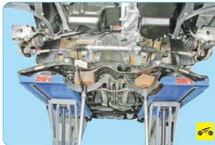
44. Снимите поперечину передней подвески (см. «Снятие и установка поперечины передней подвески», с. 144).
