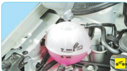
10. Отверните пробку расширительного бачка и заполняйте систему до тех пор, пока охлаждающая жидкость не достигнет метки «MAX», затем установите крышку на место.
