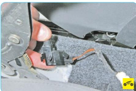
3. ...и отсоедините выключатель от рычага привода стояночного тормоза.
