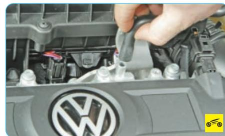
1. Снимите со штуцера корпуса распределительных валов шланг большой ветви системы вентиляции картера.
