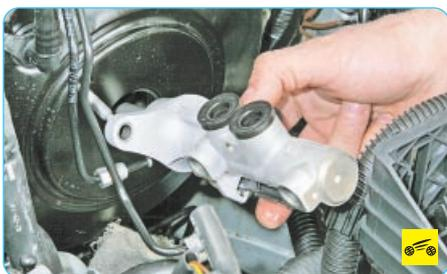
2. Снимите главный тормозной цилиндр (см. «Замена главного тормозного цилиндра», с. 167).
