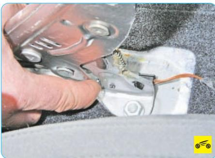
2. Отожмите фиксатор выключателя сигнальной лампы включения стояночного тормоза...
