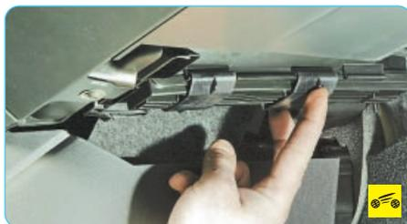
1. Сдвиньте передний фиксатор крышки до упора назад...
