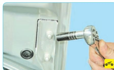
11. Отверните по две гайки крепления капота к обеим петлям и снимите капот.
