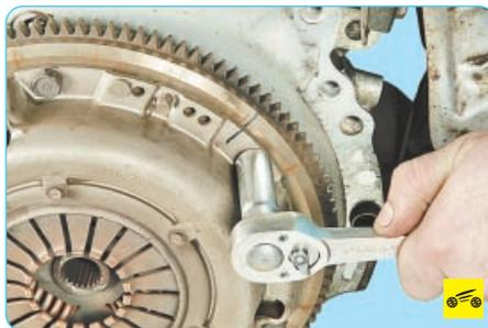
3. Удерживая маховик монтажной лопаткой (или большой отверткой) от проворачивания, выверните шесть болтов крепления кожуха нажимного диска сцепления к маховику (для наглядности разборка показана на снятом двигателе). Затяжку болтов ослабляйте равномерно: каждый болт по два оборота ключа, переходя от болта к болту по диаметру.
