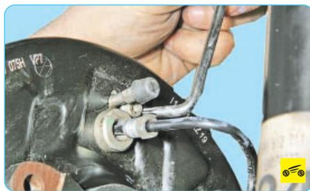
8. Выверните болт крепления рабочего цилиндра к тормозному щиту, придерживая цилиндр с другой стороны...
