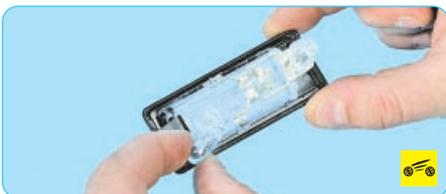
5. ...и извлеките бесцокольную лампу (для наглядности показано на снятом фонаре освещения номерного знака).
