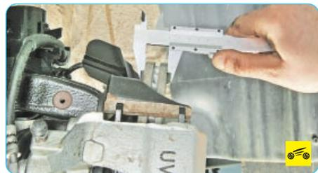
4. Измерьте толщину тормозного диска. Если его толщина менее допустимого значения (см. табл. 9.1), замените тормозной диск (см. «Замена тормозного диска», с. 172).
