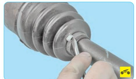
16. Для замены внутреннего шарнира типа Лебро привода автомобилей с механической коробкой передач отсоедините отверткой или перекусите бокорезами замок малого хомута крепления внутреннего чехла шарнира...
