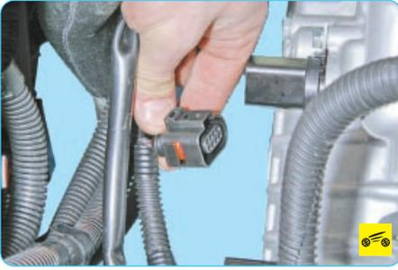
9. ...от датчика частоты вращения гидро- трансформатора...
