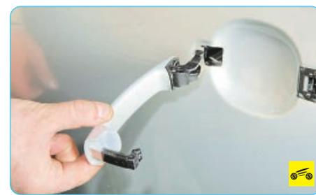
3. Снимите наружную ручку, выведя ее передний конец из кронштейна.
