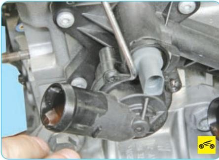
4. Выверните три винта крепления крышки термостата к корпусу водораспределителя...
