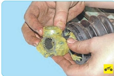
32. Снимите со шлицев вала ступицу с роликами...
