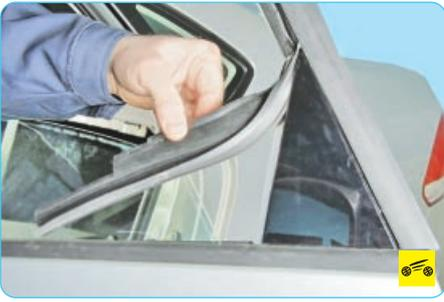
4. Снимите уплотнитель с края оконного проема.
