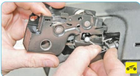
4. Отсоедините от замка наконечник и оболочку троса его привода и снимите замок.
