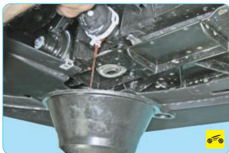
12. Слейте охлаждающую жидкость из системы охлаждения (см. «Замена охлаждающей жидкости», с. 94).
