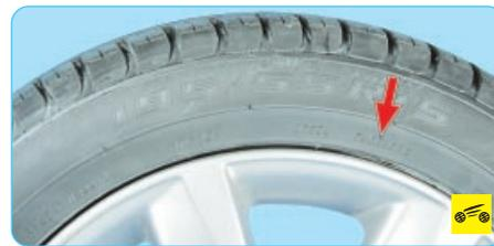
**Tubeless** – бескамерная конструкция шины;
