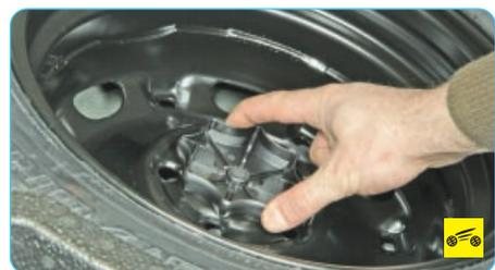
**Запасное колесо прикреплено к основанию пола специальным фиксатором.**
