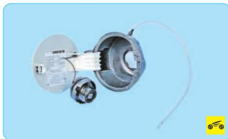
5. Установите облицовку люка наливной трубы топливного бака в порядке, обратном снятию.
