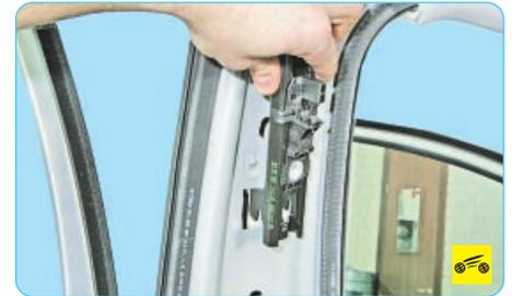
16. ...и снимите механизм, поднимая его вверх и выводя фиксаторы из проемов стойки.
