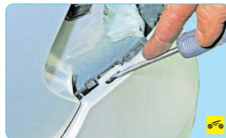
10. Отожмите по два фиксатора крепления бампера в нишах задних фонарей.
