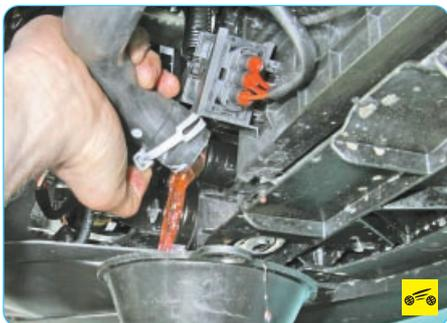
1. Слейте жидкость из системы охлаждения двигателя (см. «Замена охлаждающей жидкости», с. 94).
