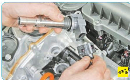
7. ... и отсоедините колодку от катушки зажигания.
