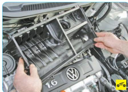
2. Снимите корпус воздушного фильтра (см. «Снятие и установка воздушного фильтра и воздухозаборника», с. 102).
