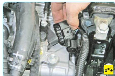
8. Нажмите на фиксаторы колодок жгутов проводов и отсоедините колодки от механизма управления коробкой передач...
