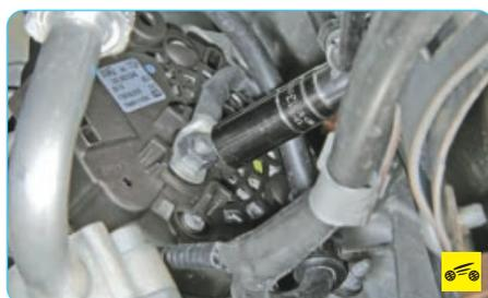
5. ...и генератору. Провода могут быть оборваны, обломаны внутри изоляции либо с окисленными или ненадежными контактами. Устраните неисправность и пустите двигатель. Если появился ток зарядки, можно продолжать движение.
