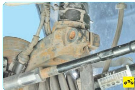
11. Извлеките стойку из клеммового соединения поворотного кулака, предварительно разжав монтажной лопаткой клемму, и снимите кулак в сборе со ступицей и щитом тормозного механизма.
