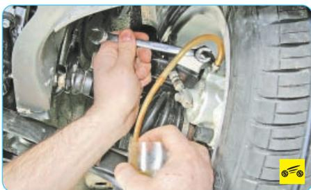
8. Таким же способом замените тормозную жидкость в рабочем цилиндре тормозного механизма левого переднего колеса.
