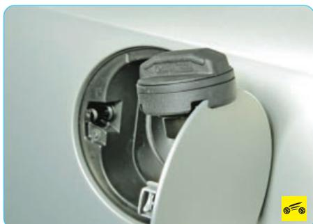
5. Закрепите пробку на крышке, зацепив отбортовку края пробки за крышку.
