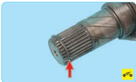
**Заменяйте новым стопорное кольцо хвостовика внутреннего шарнира привода автомобиля с автоматической коробкой передач при каждом снятии привода с автомобиля, иначе привод может самопроизвольно выскочить из полуосевой шестерни во время движения.**
