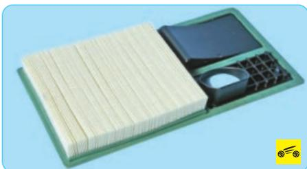
4. Осмотрите фильтрующий элемент. Пройдите его сжатым воздухом. Сильно загрязненный фильтрующий элемент замените.
