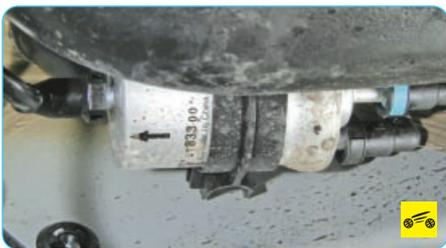
– засорен топливный фильтр, установленный на основании кузова;
