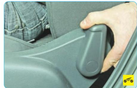
Для регулировки наклона спинки поверните назад блокирующий рычаг, установите спинку в желаемое положение...
