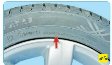
Иногда дополнительно к индексу грузоподъемности или вместо него на шине бывает указана допустимая нагрузка – «MAX LOAD 515 KG».
