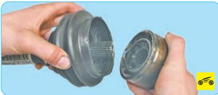
7. Снимите наружный шарнир со шлицев вала.
