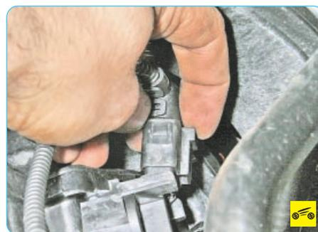
1. Отожмите фиксатор колодки жгута проводов...
