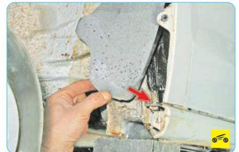
8. Выверните болт нижнего крепления крыла, расположенный в колесной арке, под накладкой.
