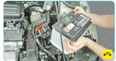
3. Снимите аккумуляторную батарею (см. «Снятие и установка аккумуляторной батареи», с. 183).
