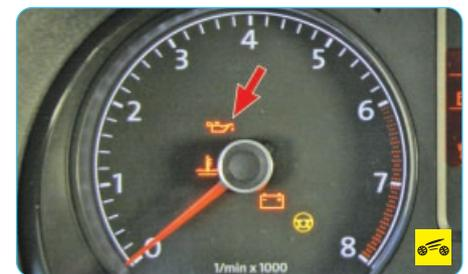
В комбинации приборов вашего автомобиля установлена сигнальная лампа аварийного падения давления масла в двигателе. Для надежной работы двигателя необходимо, чтобы в системе смазки двигателя постоянно обеспечивалось достаточно высокое давление.
