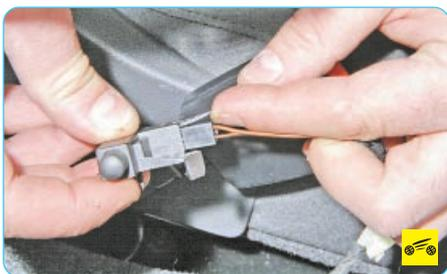
5. Отожмите фиксатор колодки жгута проводов выключателя...
