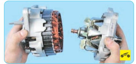
8. Разъедините крышку в сборе с ротором и крышку со статором.
