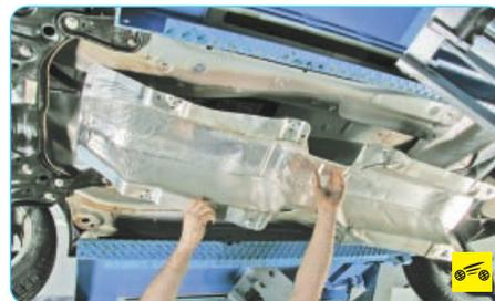
12. Снимите термозэкран блока дополнительного глушителя и приемной трубы (см. «Снятие и установка термозэкранов», с. 112).
