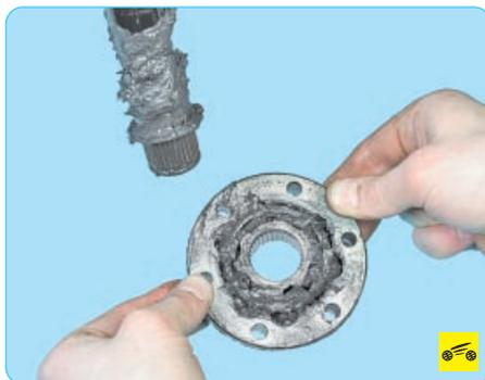
22. ...и снимите внутренний шарнир со шлицев вала.
