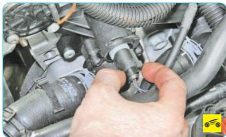
4. Отожмите фиксатор колодки жгута проводов датчика температуры охлаждающей жидкости...
