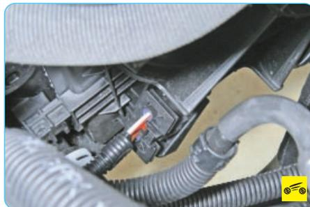
7. ...окисленные контакты в колодке жгута проводов, перегоревшее дополнительное сопротивление вентилятора или сгоревший электродвигатель.
