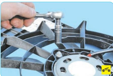
8. Отверните три гайки крепления электровентилятора к кожуху...
