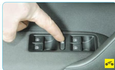
В центральном блоке управления находится кнопка блокировки дверных клавиш управления задними стеклоподъемниками. Возможность управления задними стеклоподъемниками с центрального блока управления при нажатии на эту кнопку сохраняется.
