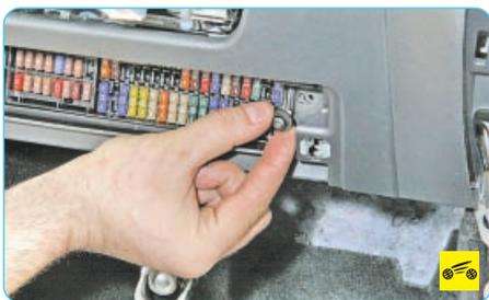
12. Выверните два винта крепления монтажного блока...
