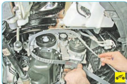
5. Снимите ремень привода кондиционера (см. «Снятие и установка ремня привода вспомогательных агрегатов», с. 70).
