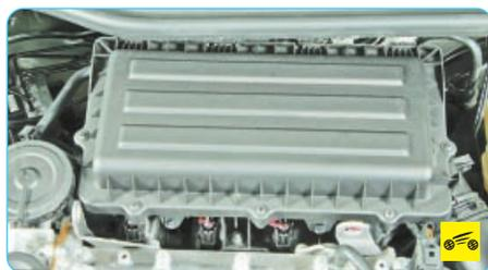
**Воздушный фильтр** установлен на двигателе. Фильтрующий элемент бумажный, плоский, с большой площадью фильтрующей поверхности. Воздушный фильтр соединен воздухоподводящим рукавом с дроссельным узлом.
