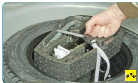
5. Поднимите пряжку фиксатора ремня кассеты с инструментом...
