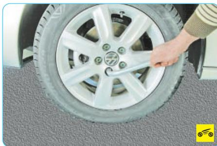
Болты крепления колес затягивайте постепенно, через один.
