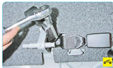
10. Для замены замков задних ремней безопасности выверните болт крепления...
