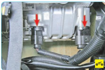
19. Отожмите фиксатор и отсоедините колодку жгута проводов от разъема коробки передач. Аналогично отсоедините вторую колодку от разъема коробки.
