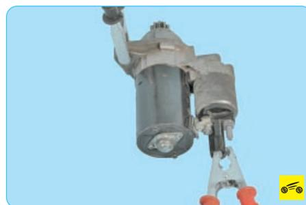
2. Соедините проводами для «прикуривания» клемму «минус» снятой с автомобиля аккумуляторной батареи с корпусом стартера. Второй провод подсоедините одним концом к клемме «плюс» аккумуляторной батареи, а другой – к выводу управляющего провода тягового реле.
