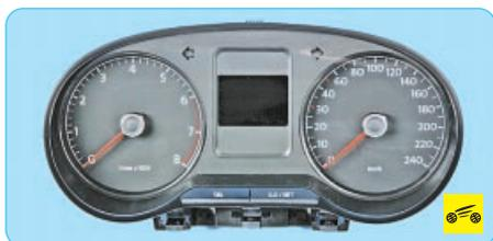
Все контрольно-измерительные приборы автомобиля объединены в комбинацию приборов. Она включает в себя спидометр, тахометр, счетчик общего и суточного пробега (одометр), указатель уровня топлива и температуры охлаждающей жидкости, сигнализаторы. В комбинации приборов установлен также дисплей бортового компьютера.
