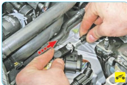
4. Переместите рычаг штока выбора передач в положение «Р», для чего отожмите рычаг до упора назад относительно направления движения автомобиля.
