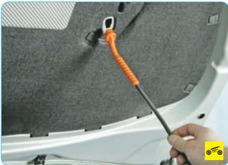
...и установите его в специальное гнездо на внутренней панели капота.
