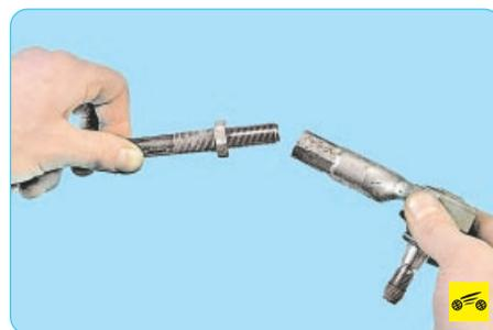
8. Отверните наконечник от рулевой тяги, подсчитывая количество оборотов, чтобы при установке нового наконечника по возможности не изменилось схождение колес.
