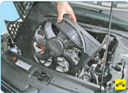
5. ...и снимите вентилятор в сборе с кожухом.
