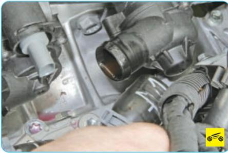
24. ...и отвода охлаждающей жидкости от радиатора системы охлаждения двигателя (см. «Снятие и установка водораспределителя», с. 98).
