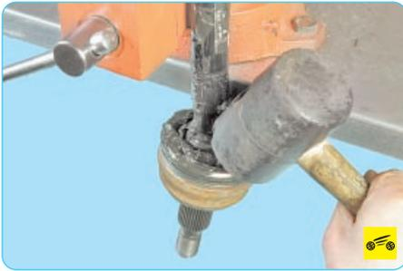
6. ...и сбейте с вала молотком через бородок обойму шарнира, преодолевая усилие стопорного кольца.
