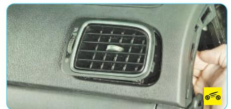
3. Через проем в торце панели приборов отожмите фиксаторы бокового сопла системы
