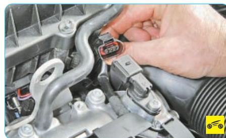
3. ...и отсоедините колодку от датчика положения распределительного вала.
