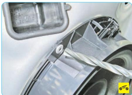
5. Высверлите заклепки крепления динамика к панели двери и снимите динамик.
