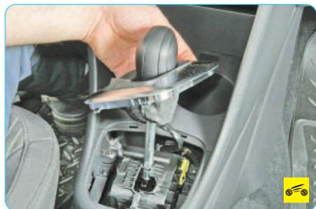
4. Снимите рамку чехла рычага управления коробкой передач (см. «Снятие и установка облицовок тоннеля пола и консоли панели приборов», с. 238).
