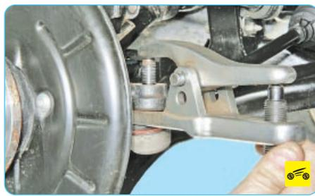
4. Установите съемник шаровых шарниров, выпрессуйте палец из бобышки поворотного кулака...
