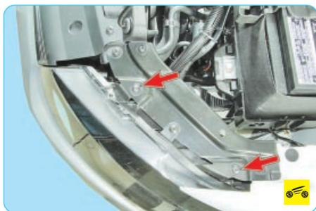
8. Выверните два винта крепления блок-фары...
