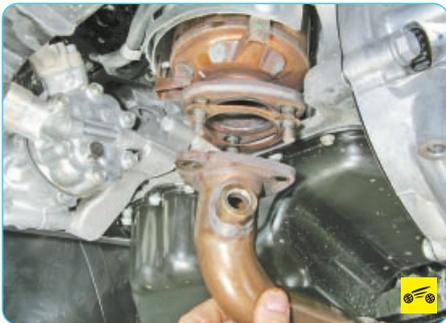
3. Отсоедините от катколлектора приемную трубу (см. «Замена блока дополнительного глушителя и приемной трубы», с. 111)...
