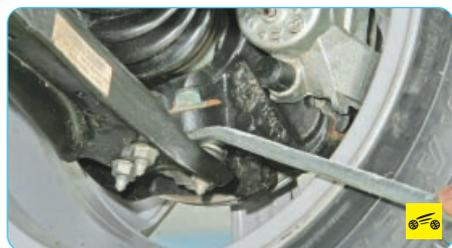
2. Проверьте шаровые опоры на наличие люфтов. Для этого вставьте монтажную лопатку между поворотным кулаком и рычагом подвески и, опираясь на рычаг, попытайтесь покачать поворотный кулак. Если есть люфт шарового пальца, замените шаровую опору.
