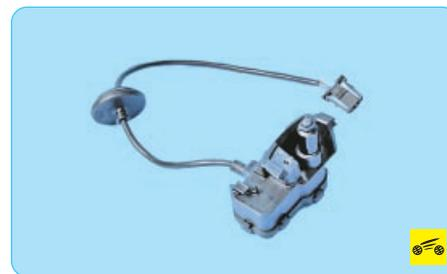
5. Установите замок крышки люка наливной трубы топливного бака в порядке, обратном снятию.
