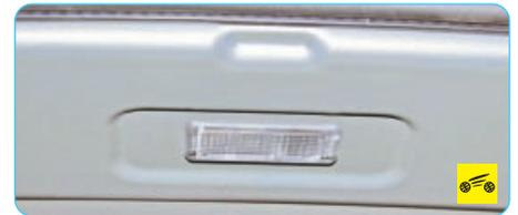
В багажнике установлен плафон освещения, который включается автоматически при открывании крышки багажника.
