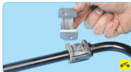
14. Снимите с подушки стабилизатора скобы крепления.
