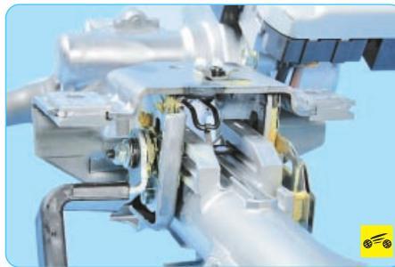
– повреждение механизма регулировки положения рулевой колонки.
