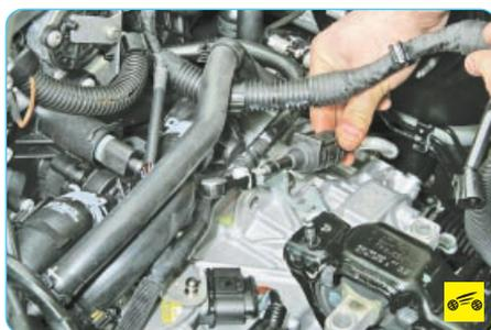
18. Отсоедините наконечник троса от рычага блока управления коробкой передач и выведите наконечник оболочки троса управления коробкой передач из паза кронштейна коробки передач (см. «Замена тросов управления коробкой передач», с. 127).
