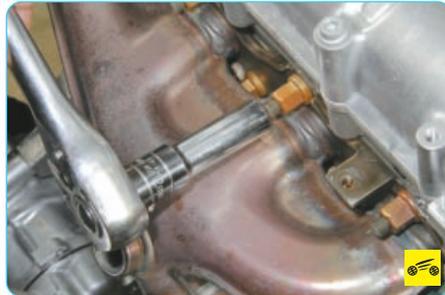
5. Отверните девять гаек крепления катколлектора к головке блока цилиндров...
