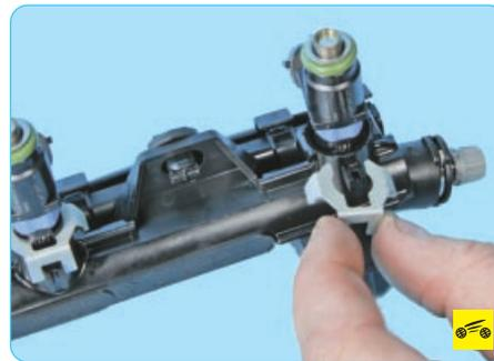
2. Снимите фиксирующую пластину форсунки...
