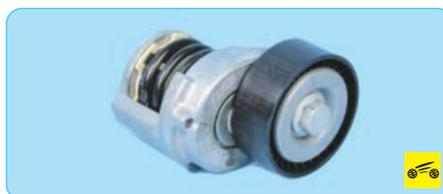
8. Установите автоматический натяжитель ремня привода вспомогательных агрегатов и все детали в порядке, обратном снятию.
