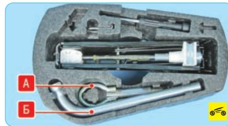
2. Извлеките из cassette ключ Б для болтов колес и буксирную проушину А.
