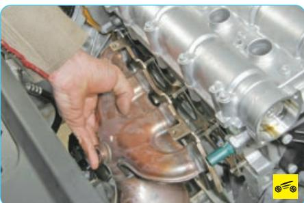
8. Снимите катколлектор (см. «Снятие и установка катколлектора и замена его прокладки», с. 111).
