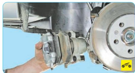
2. Снимите суппорт, не отсоединяя от него тормозной шланг (см. «Замена суппорта тормозного механизма переднего колеса», с. 172)...
