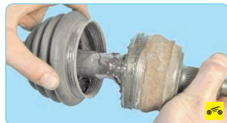
5. Сдвиньте защитный чехол с корпуса шарнира...
