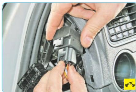
5. Отожмите фиксаторы колодки проводов...
