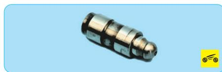
27. Установите гидрокомпенсаторы и все снятые детали в порядке, обратном снятию.
