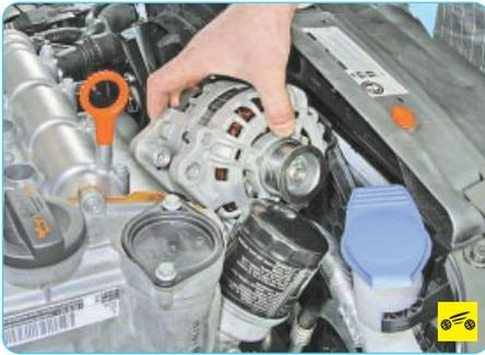
12. ...и снимите генератор с автомобиля.
