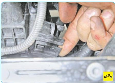
3. Отожмите фиксаторы датчика...
