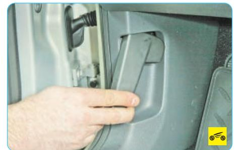
Для доступа в моторный отсек потяните на себя рукоятку привода замка капота.
