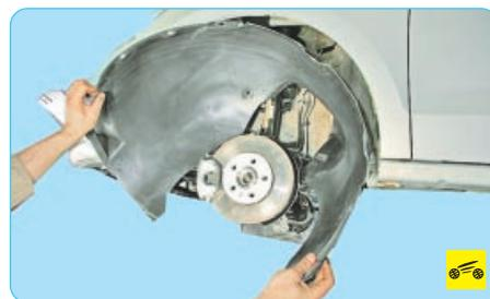
2. Снимите подкрылок левого переднего колеса (см. «Снятие и установка подкрылков колес», с. 224).
