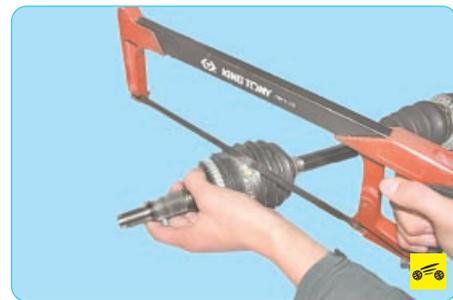
**Для облегчения снятия хомута можно распилить ножовкой по металлу. При распиливании хомута будьте осторожны – не повредите края паза под чехол на корпусе шарнира.**
