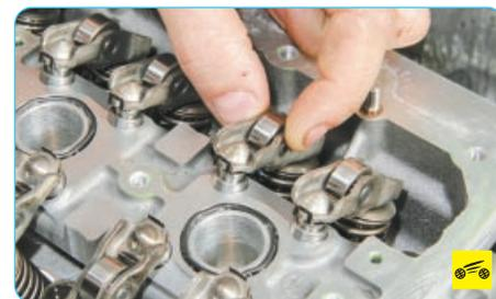
14. Для проверки работоспособности гидрокомпенсаторов нажмите на плечо коромысла, опирающегося на гидрокомпенсатор. Если рычаг удаётся переместить практически без усилия, гидрокомпенсатор неисправен.
