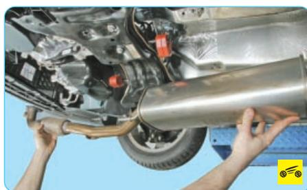
8. Снимите дополнительный глушитель (см. «Замена блока дополнительного глушителя и приемной трубы», с. 111).
