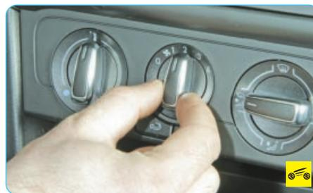
Для увеличения интенсивности подачи воздуха в салон во время движения и обеспечения подачи воздуха в неподвижный автомобиль включите рукояткой переключателя 3 один из четырех режимов работы вентилятора воздухонагнетателя.
