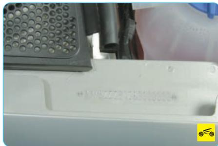
Кроме того, идентификационный номер автомобиля продублирован клеймением на специальной площадке правого брызговика моторного отсека...
