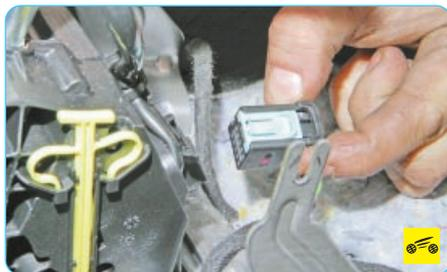
6. Отсоедините от кулисы селектора колодку жгута проводов, нажав на ее фиксатор.
