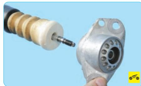
12. ...и снимите верхнюю опору 4 амортизатора 1.
