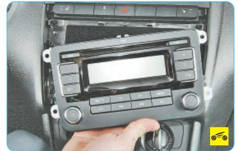
2. Снимите головное устройство аудиосистемы (см. «Снятие и установка головного устройства аудиосистемы», с. 218).
