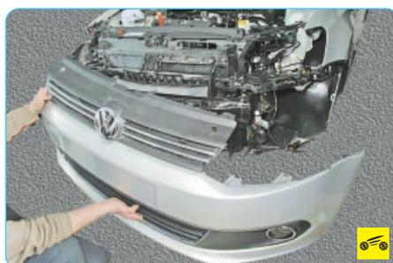
3. Снимите передний бампер (см. «Снятие и установка переднего бампера», с. 222).
