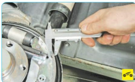
6. Измерьте толщину фрикционной накладки. Если толщина менее допустимого значения (см. табл. 9.1), замените колодки (см. «Замена тормозных колодок тормозного механизма заднего колеса», с. 173).
