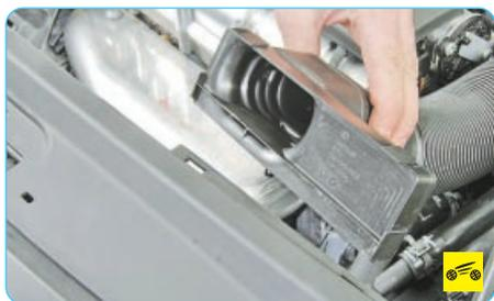
8. ...и снимите воздухоподводящий рукав с воздухозаборника.
