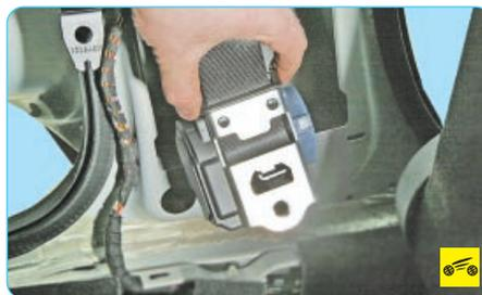
14. ...и извлеките катушку из полости стойки. Снимите ремень безопасности.
