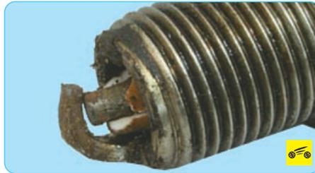
8. Механические повреждения электродов и изолятора свечи.
