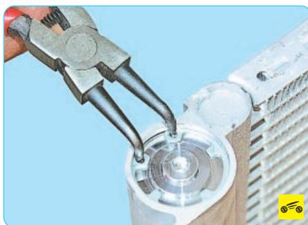
5. С помощью съемника снимите стопорное кольцо заглушки отверстия для замены фильтрующего элемента.
