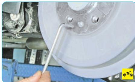
3. Выверните винт крепления барабана к задней ступице...
