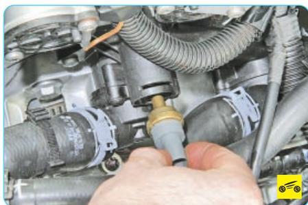
7. Снимите датчик температуры охлаждающей жидкости.
