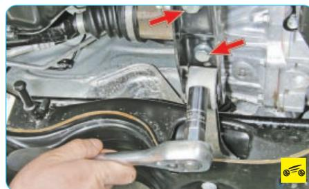
4. Выверните два болта крепления кронштейна задней опоры к коробке передач...
