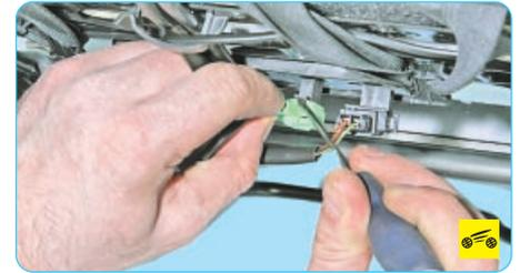
17. Для снятия замка ремня безопасности водителя снимите переднее сиденье (см. «Снятие и установка переднего сиденья», с. 236), отожмите отверткой фиксатор колодки жгута проводов...
