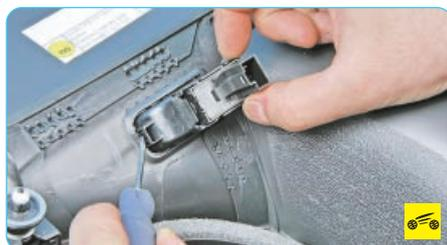
5. Отожмите фиксатор выключателя замка крышки багажника...
