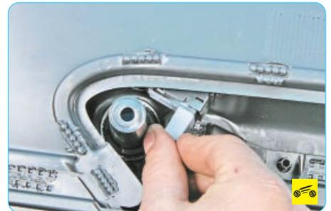
6. ...вытолкните переднюю часть выключателя из проема обивки задней двери...
