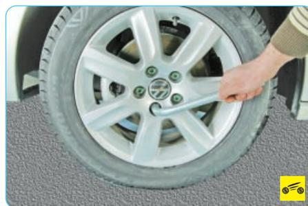
10. Проверьте затяжку болтов крепления колес и при необходимости затяните их моментом 120 Н·м.
