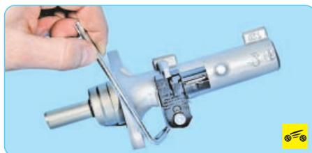
4. Выверните болт крепления выключателя стоп-сигнала (для наглядности показано на снятом главном тормозном цилиндре)...
