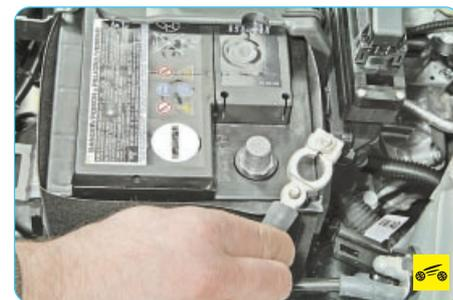
2. Отсоедините провод от клеммы «минус» аккумуляторной батареи.
