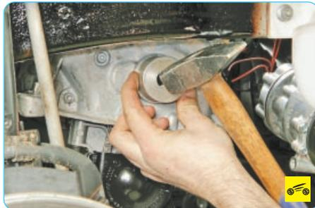
12. Запрессуйте сальник в переднюю крышку блока цилиндров до упора с помощью оправки.
