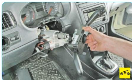
6. Снимите контактное кольцо подушки безопасности водителя (см. «Снятие и установка рулевой колонки», с. 155).
