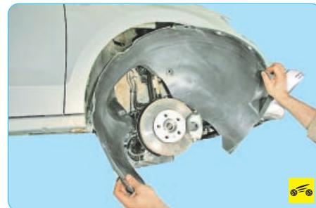
2. Снимите подкрылок правого переднего колеса (см. «Снятие и установка подкрылков колес», с. 224).
