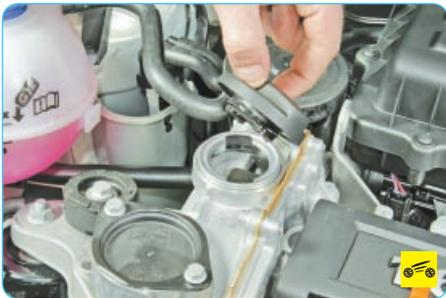
3. Для доливки масла, повернув пробку маслоналивной горловины против часовой стрелки, извлеките ее из маслоналивной горловины.
