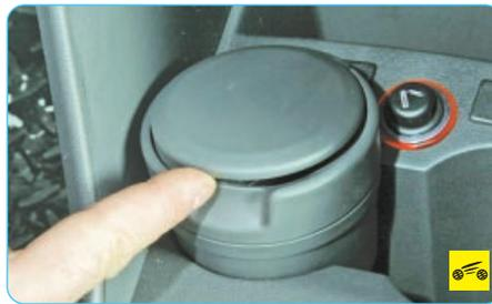
В одном из двух гнезд в облицовке тоннеля пола установлена съемная пепельница. Для пользования пепельницей подденьте край ее крышки...
