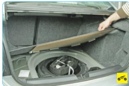
4. ...и поднимите настил пола в багажнике.
