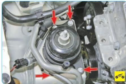
8. Выверните четыре (один болт на фото не виден) болта крепления правой опоры подвески силового агрегата к лонжерону кузова...
