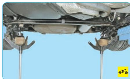
4. Если вы заменяете амортизатор на подъемнике, установите под балку задней подвески опоры и опустите автомобиль, слегка нагрузив подвеску.
