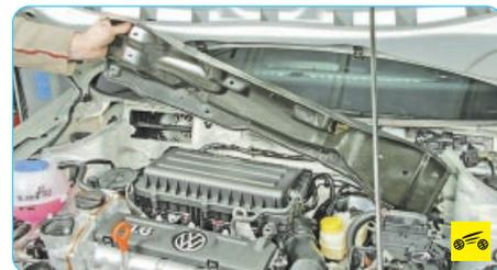
4. ...и водоотводящий щиток (см. «Снятие и установка решетки короба воздухопритока», с. 226).
