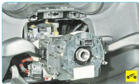
Перед снятием обязательно зафиксируйте скотчем или изоляционной лентой от проворачивания контактное кольцо звукового сигнала и подушки безопасности водителя. Если кольцо повернется относительно исходного положения, то после его установки система SRS будет работать некорректно.
