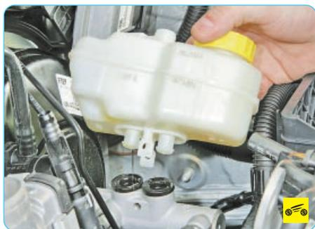
3. Для удобства работы снимите бачок главного тормозного цилиндра (см. «Замена бачка главного тормозного цилиндра», с. 166).
