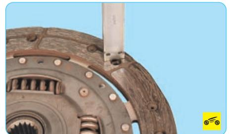
6. Проверьте степень износа фрикционных накладок. Если головки заклепок утоплены менее чем на 0,3 мм, поверхность фрикционных накладок замаслена или ослаблены заклепочные соединения, то ведомый диск необходимо заменить.
