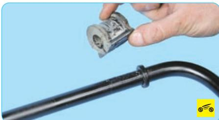
16. ...затем снимите ее со стабилизатора. Аналогично снимите вторую подушку.
