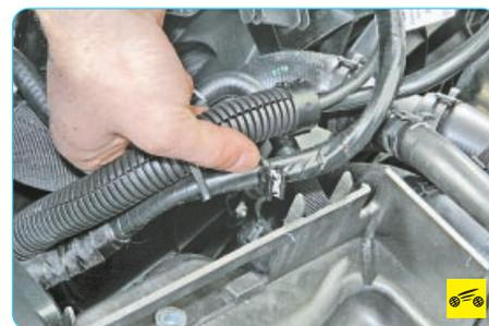
2. Извлеките держатели жгутов проводов из щитка полки крепления аккумуляторной батареи и отведите жгут проводов в сторону.
