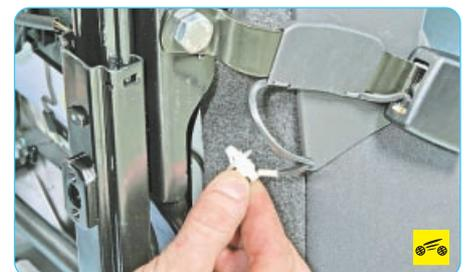
20. Аналогично извлеките второй фиксатор провода сигнальной лампы непристегнутого ремня безопасности.
