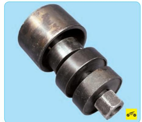
– приспособление для выпрессовки и запрессовки подшипников ступиц передних и задних колес;
