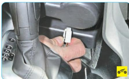
19. С внутренней стороны облицовки сожмите фиксатор колодки жгута проводов и отсоедините колодку от прикуривателя.
