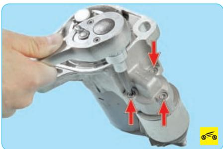
3. Выверните три винта крепления тягового реле к передней крышке...
