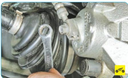
2. Ослабьте затяжку болта-штуцера крепления нижнего наконечника тормозного шланга к суппорту...
