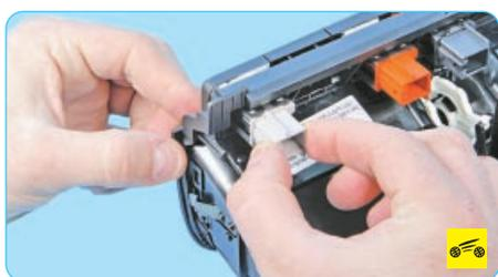
8. Преодолевая сопротивление фиксаторов, извлеките выключатель обогрева переднего сиденья из блока выключателей и центральных сопел системы отопления кондиционирования и вентиляции салона...
