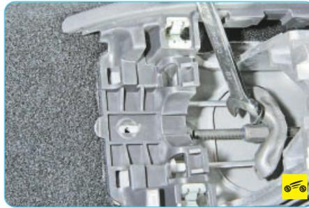
4. Отверните регулировочную гайку до конца резьбовой части тяги рычага привода стояночного тормоза, чтобы полностью ослабить натяжение задних тросов.
