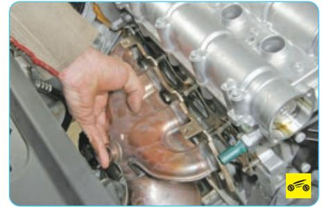
33. Снимите катколлектор (см. «Снятие и установка катколлектора и замена его прокладки», с. 111).
