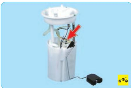
Топливный насос расположен в топливном модуле, в его нижнем стакане.
