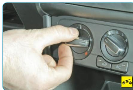
Для изменения температуры поступающего в салон воздуха вращайте рукоятку регулятора 1 температуры. Левая (синяя) часть шкалы соответствует подаче максимально охлажденного воздуха, правая (красная) – максимально подогретого. При среднем положении рукоятки в салон подается воздух при температуре окружающей среды.
