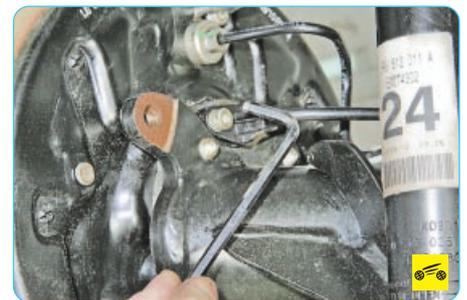
8. Выверните болт крепления датчика частоты вращения к фланцу рычага задней подвески...
