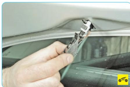
5. Преодолевав сопротивление фиксаторов, извлеките форсунки омывателя ветрового стекла из отверстий в капоте.
