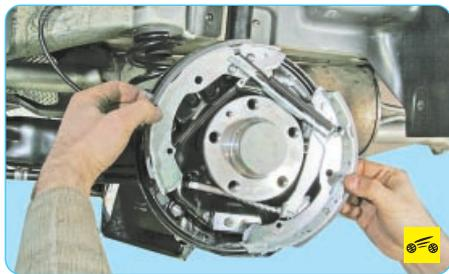
5. Снимите тормозные колодки заднего колеса (см. «Замена тормозных колодок тормозного механизма заднего колеса», с. 173).
