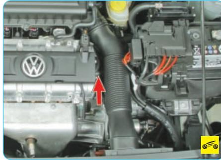
5. Двигатель может перегреться в случае выхода из строя термостата, который регулирует прохождение потока жидкости в системе охлаждения через радиатор или мимо него (для ускорения прогрева холодного двигателя).
