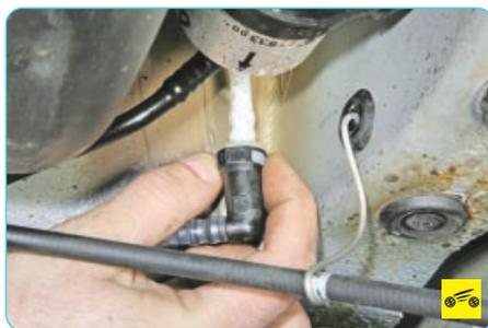
13. Сожмите фиксатор наконечника трубопровода отвода паров топлива...
