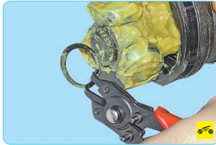
31. Снимите стопорное кольцо ступицы шарнира, разжав его съемником стопорных колец и выведя кольцо из проточки вала.
