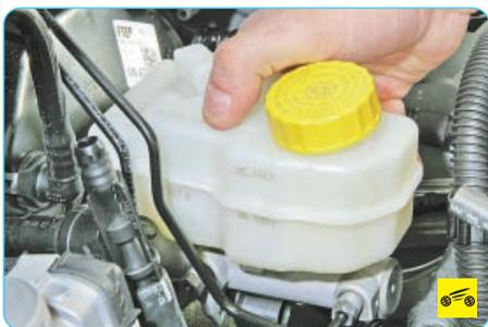
10. Перед установкой бачка вставьте в отверстие главного тормозного цилиндра соединительные втулки. Затем установите бачок, вставив его патрубки в соединительные втулки усилием руки до упора, и закрепите фиксирующим стержнем.
