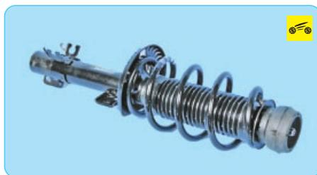
1. Снимите амортизаторную стойку с автомобиля (см. «Снятие и установка амортизаторной стойки передней подвески», с. 137).
