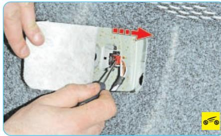
4. Подденьте отверткой фиксатор колодки жгута проводов, сдвиньте его в направлении стрелки...
