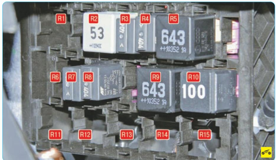
Рис. 10.3. Монтажный блок реле в панели приборов: R1, R6, R11–R15 – резервные; R2 – реле обогрева ветрового стекла (в зависимости от комплектации); R3 – реле блокировки стартера; R4 – реле подачи топлива по напорной магистрали; R5 – реле электропитания; R7 – реле передних габаритных огней; R8 – реле топливного насоса; R9 – реле климатической установки; R10 – реле контакта «Х»
