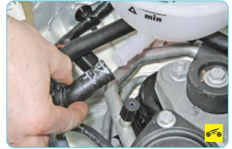
6. ...и снимите шланг со штуцера расширительного бачка. Слейте жидкость из бачка и шланга в подходящую емкость.
