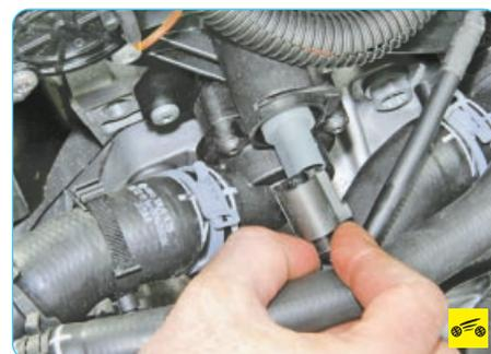
22. Отсоедините колодку жгута проводов от датчика температуры охлаждающей жидкости.
