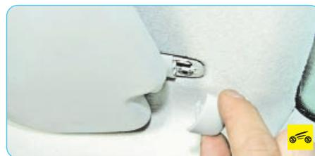
2. Поддев отверткой, снимите фиксатор...
