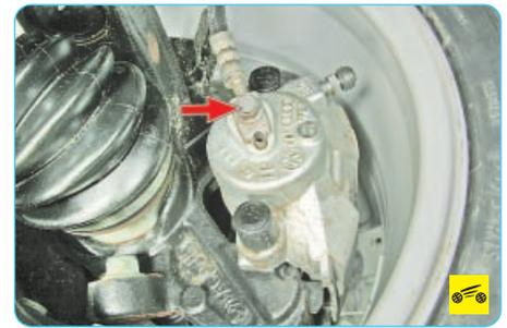
6. Осмотрите соединения шлангов с рабочими цилиндрами тормозных механизмов.
