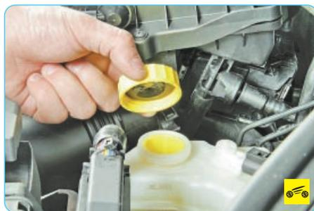
2. Отверните пробку бачка главного тормозного цилиндра.
