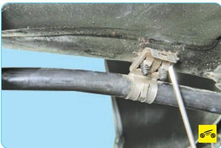
6. Отожмите отверткой фиксаторы держателя троса на кузове...
