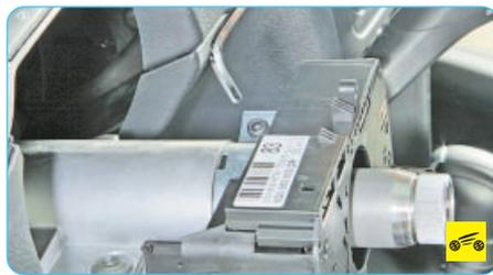
8. Выверните винт хомута крепления соединителя подрулевых переключателей.
