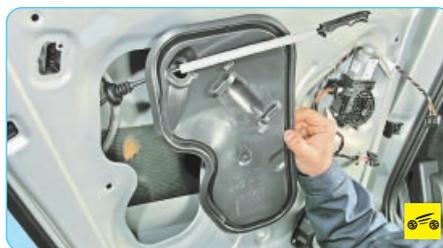
11. Снимите заглушку технологического окна внутренней панели двери.
