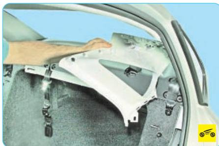
6. ...и верхнюю облицовки задней стойки кузова. Аналогично снимите облицовки задней стойки с другой стороны (см. «Снятие и установка облицовок салона», с. 242).
