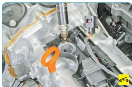
4. Выверните свечи зажигания (см. «Замена и обслуживание свечей зажигания», с. 194).
