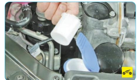
Если сетчатый фильтр, установленный в горловине бачка, засорен, извлеките его из горловины и промойте проточной водой.
