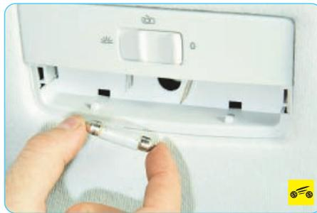
3. Извлеките лампу из пружинных контактов.
