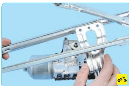
12. Снимите трапецию и кронштейн с моторередуктора.
