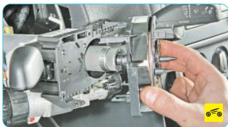
5. Снимите контактное кольцо звукового сигнала и подушки безопасности водителя (см. «Снятие и установка контактного кольца звукового сигнала и подушки безопасности», с. 209).
