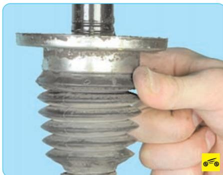
24. Снимите с вала защитный чехол.
