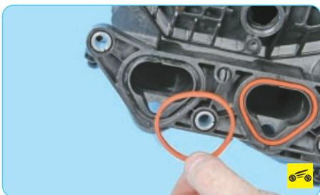
8. Извлеките уплотнительную прокладку из паза впускной трубы. Аналогично извлеките из пазов впускной трубы остальные уплотнительные прокладки.
