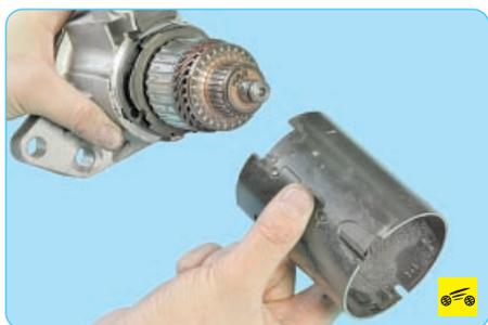
17. Разъедините статор и крышку со стороны привода.
