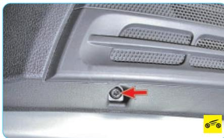
9. ...и один винт нижнего крепления обивки двери.
