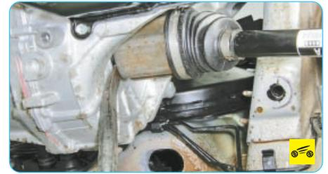
11. На автомобиле с автоматической коробкой передач с помощью монтажной лопатки выпрессуйте хвостовик внутреннего шарнира привода из шестерни полуоси дифференциала...
