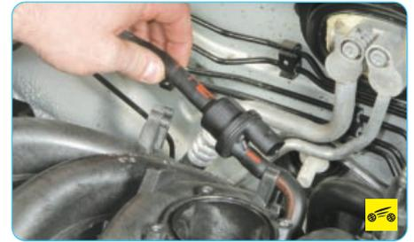
4. Извлеките шланги, идущие к клапану адсорбера, из кронштейнов на впускной трубе.
