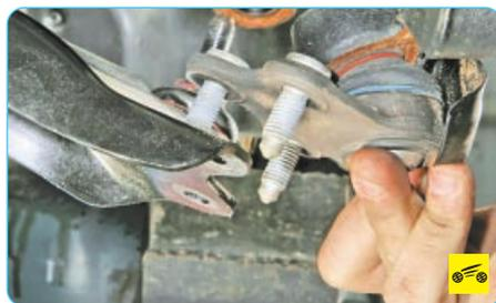
5. Отверните гайки болтов крепления шаровых опор к рычагам передней подвески и выведите болты опоры из отверстий рычага. Аналогично отсоедините шаровую опору от рычага с другой стороны (см. пп. 4 и 5 «Замена шаровой опоры», с. 140).
