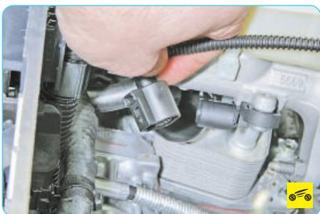
2. Нажмите на фиксатор колодки жгута проводов выключателя стоп-сигнала и отсоедините колодку от выключателя.
