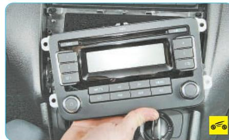
5. Извлеките головное устройство аудиосистемы из ниши панели приборов.
