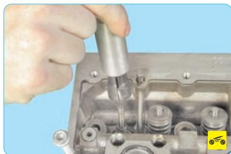
10. Установите цангу инерционного съемника на маслоъемный колпачок.
