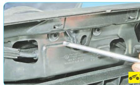
2. Выверните два винта крепления замка капота...
