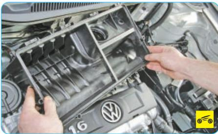
1. Снимите корпус воздушного фильтра (см. «Снятие и установка воздушного фильтра и воздухозаборника», с. 102).
