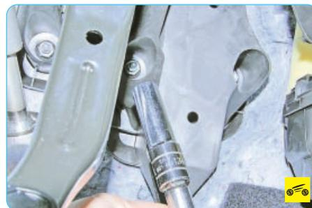
3. В салоне автомобиля, под панелью приборов отверните шесть гаек крепления кронштейна педали тормоза к щиту передка...
