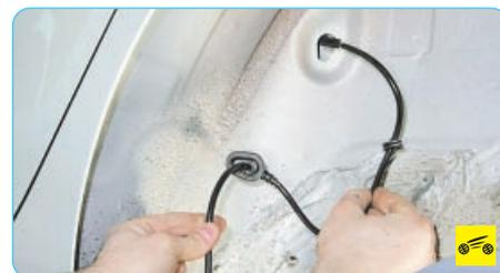
12. ...и снимите датчик, выводя колодку провода датчика из отверстия кузова.
