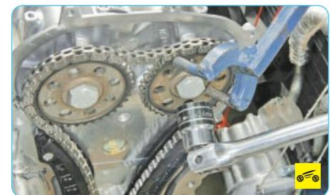
11. Удерживая от проворачивания стопором 6 (рис. 5.4) звездочку распределительного вала впускных клапанов; 2 – болт крепления звездочки распределительного вала впускных клапанов; 3 – цепь привода газораспределительного механизма; 4 – болт крепления звездочки распределительного вала выпускных клапанов; 5 – звездочка распределительного вала выпускных клапанов; 6 – стопор
