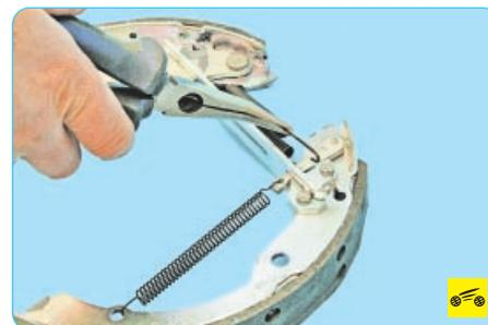
18. Выведите отогнутый конец верхней стяжной пружины из отверстия в ребре передней колодки...
