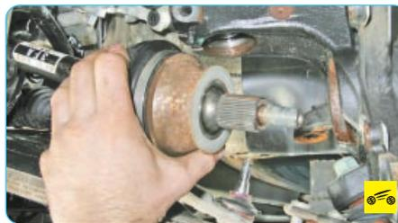
18. Снимите приводы передних колес (см. «Снятие и установка приводов передних колес», с. 130).
