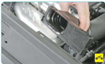
2. ...и снимите воздухоподводящий рукав с воздухозаборника.
