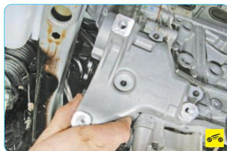
8. Снимите кронштейн крепления кондиционера (см. «Снятие и установка компрессора кондиционера», с. 257).
