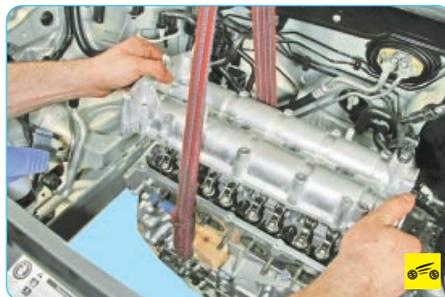
11. Снимите корпус распределительных валов (см. «Замена прокладок корпуса распределительных валов», с. 76).
