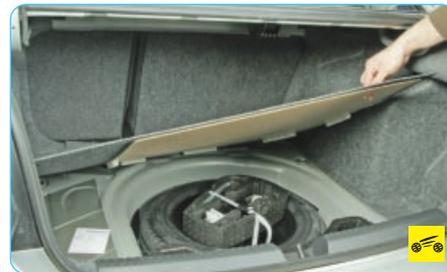
1. Откройте багажник и поднимите настил пола в багажнике. Ослабьте натяжку ремня крепления cassette с инструментом и сдвиньте его в сторону (см. пп. 5 и 6 «Пользование домкратом», с. 39).
