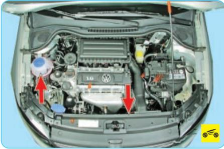
2. Откройте капот и осмотрите подкапотное пространство. Определите, откуда вырывается пар. При осмотре двигателя обратите внимание на наличие охлаждающей жидкости в расширительном бачке, на целостность резиновых шлангов, радиатора, термостата.
