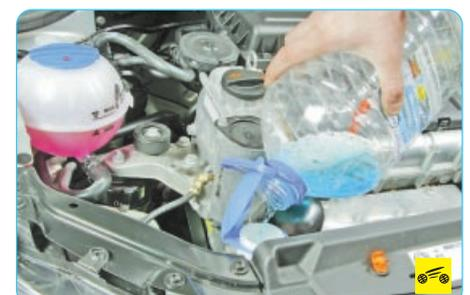
2. ...и долейте жидкость в бачок до нижней кромки горловины.
