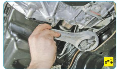
7. ...и снимите заднюю опору подвески силового агрегата.
