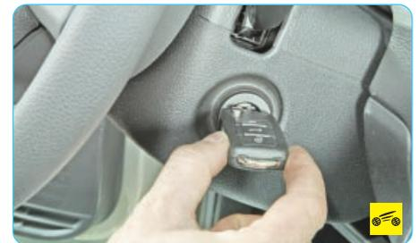
2. Вставьте ключ в замок зажигания и заблокируйте рулевую колонку. Опустите рулевую колонку в крайнее нижнее положение (см. «Регулировка положения рулевого колеса», с. 31).
