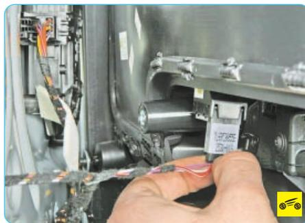
3. Нажмите на фиксатор колодки жгута проводов...
