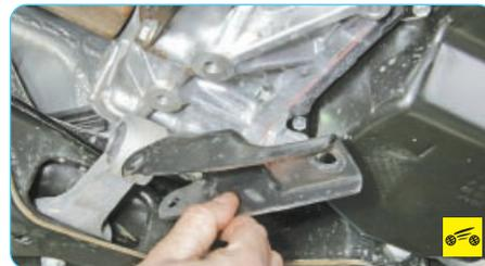
9. Снимите кронштейн задней опоры силового агрегата (см. «Замена задней опоры подвески силового агрегата и кронштейна ее крепления», с. 72).
