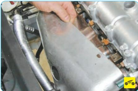
2. Снимите термозэкран катколлектора (см. «Снятие и установка термозэкранов», с. 112).
