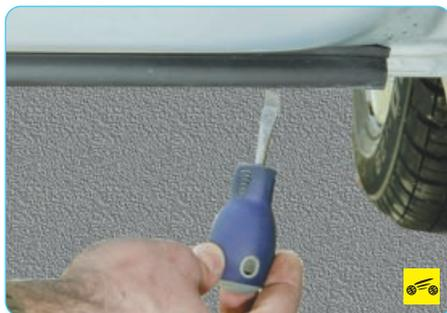
2. Дренажные отверстия со временем забиваются дорожной грязью, поэтому периодически (желательно при каждой мойке автомобиля) прочищайте эти отверстия тонкой деревянной палочкой или отверткой.
