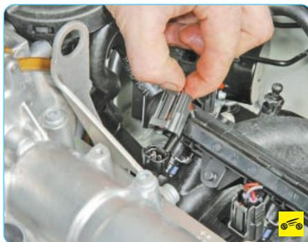
5. Нажимая на фиксаторы колодок моторного жгута проводов, отсоедините колодки от разъемов форсунок.
