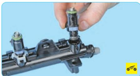
3. ...и извлеките хвостовик форсунки из отверстия рампы.
