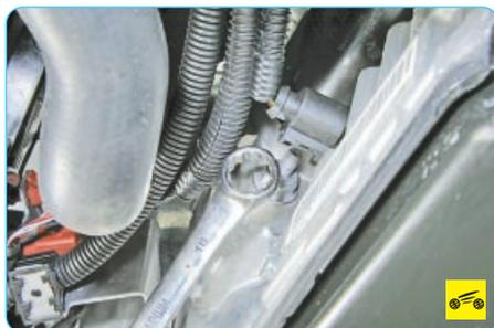
11. Выверните шпильку нижнего крепления стартера к блоку цилиндров...
