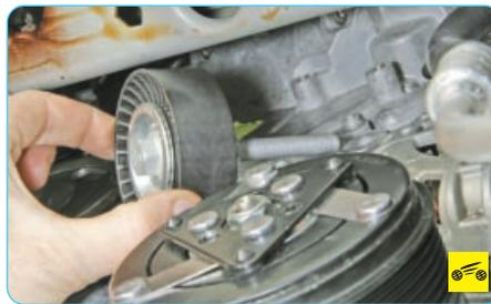
7. ...и снимите ролик.
