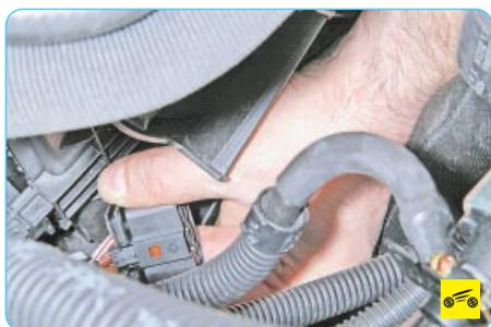
11. Сожмите фиксатор колодки жгута проводов электродвигателя вентилятора и отсоедините колодку.
