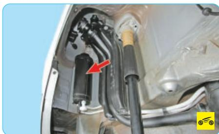
Угольный **адсорбер** установлен в нише правого заднего колеса и соединен топливопроводами с топливным баком и электромагнитным клапаном продувки адсорбера.
