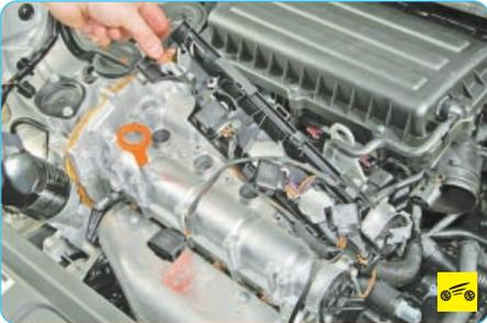
9. Снимите направляющую низковольтных проводов.
