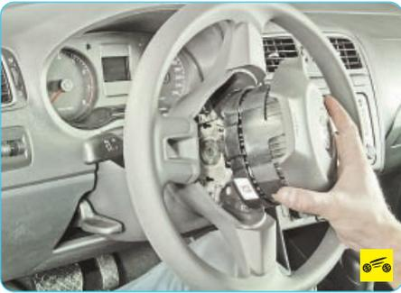
6. Поверните рулевое колесо вправо на 180°, через отверстие в кожухе отожмите фиксатор модуля подушки безопасности водителя с другой стороны и отсоедините подушку от рулевого колеса.
