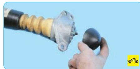
10. Снимите крышку 6 (рис. 7.4) гайки штока амортизатора 1.
