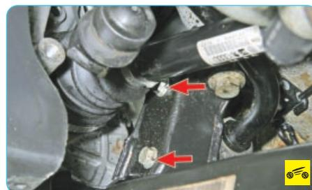
12. Выверните четыре болта (по два с каждой стороны) крепления скобы стабилизатора к поперечине передней подвески...
