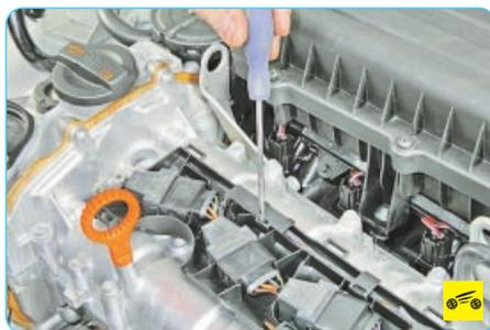
3. Отожмите отверткой фиксатор...
