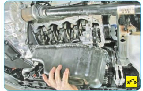
4. Снимите масляный картер двигателя (см. «Замена уплотнения масляного картера двигателя», с. 74).
