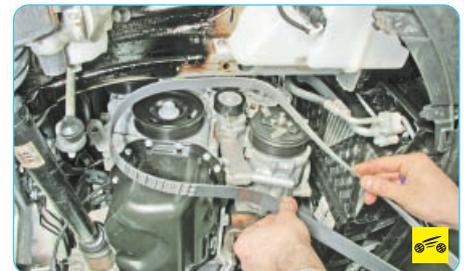
35. Снимите ремень привода вспомогательных агрегатов (см. «Снятие и установка ремня привода вспомогательных агрегатов», с. 71).
