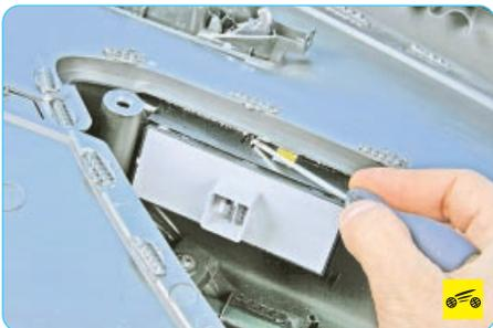
5. Отожмите боковой фиксатор блока управления стеклоподъемниками...
