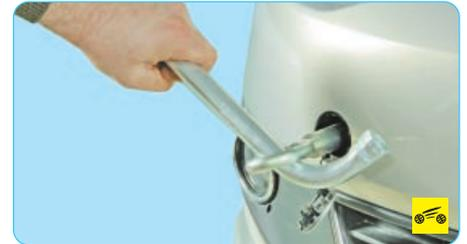
6. ...и затяните ее, используя ключ для болтов колес в качестве воротка.
