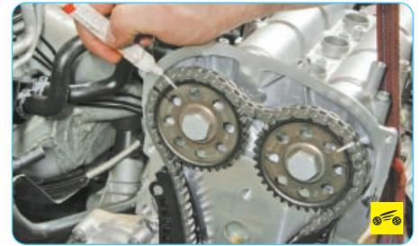
3. Если цепь привода газораспределительного механизма снимаете не для замены, пометьте взаимное расположение цепи, звездочек распределительных валов...
