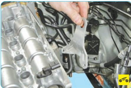
14. ...и снимите проушину. Аналогично выверните болты крепления второй монтажной проушины и снимите ее.
