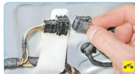
5. Разъедините колодку жгута проводов зеркала.
