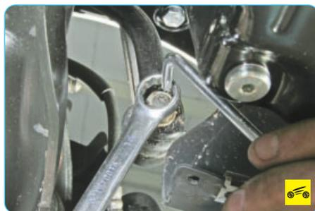
4. Удерживая палец нижнего шарнира стойки стабилизатора поперечной устойчивости от проворачивания, отверните и снимите гайку, затем выведите палец нижнего шарнира стойки из отверстия стабилизатора поперечной устойчивости. Аналогично отсоедините стойку от стабилизатора поперечной устойчивости с другой стороны.
