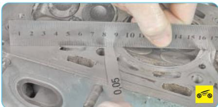
19. ...затем по диагонали и щупом измерьте зазор между поверхностью головки и линейкой. Замените головку блока цилиндров, если зазор больше 0,05 мм.
