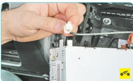
7. ...отсоедините наконечник провода антенны от головного устройства аудиосистемы.
