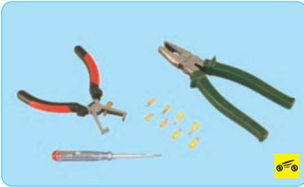
– при проведении работ с системой электрооборудования необходимы специальные пассатижи для обжимания клемм и штекеров, приспособление для зачистки проводов, индикаторная отвертка и набор клемм различных типоразмеров;
