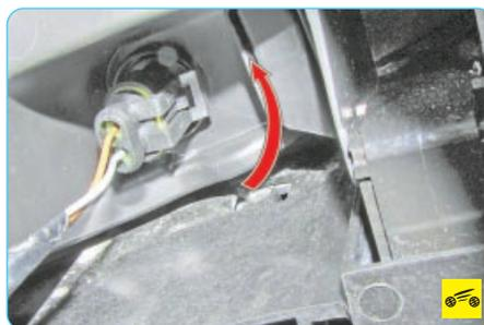
1. Поверните патрон лампы габаритного огня против часовой стрелки...
