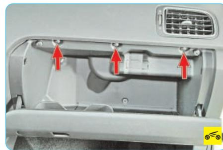
2. Выверните три винта крепления вещевого ящика к панели приборов.
