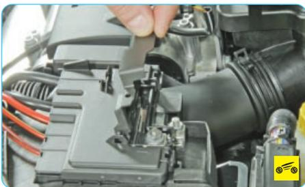
4. Откиньте защитный колпачок клеммы «плюс» разряженной батареи...
