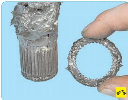
23. Снимите упорную шайбу.
