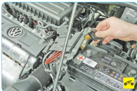
6. ...отсоедините провод от клеммы «плюс» и отведите монтажный блок предохранителей и плавких вставок от аккумуляторной батареи.
