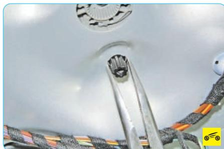
5. Сожмите три фиксатора крепления стеклоподъемника к внутренней панели двери, протолкните фиксаторы внутрь двери...
