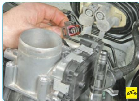
3. Сожмите фиксатор колодки жгута проводов и отсоедините колодку от дроссельного узла.
