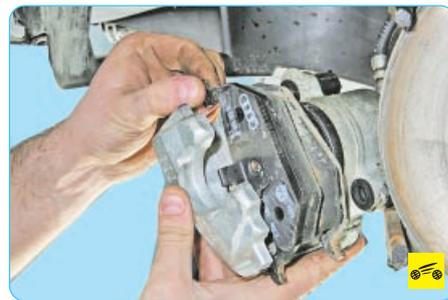
9. Снимите наружную тормозную колодку...
