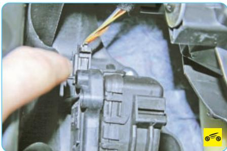
2. Сожмите фиксаторы колодки жгута проводов...
