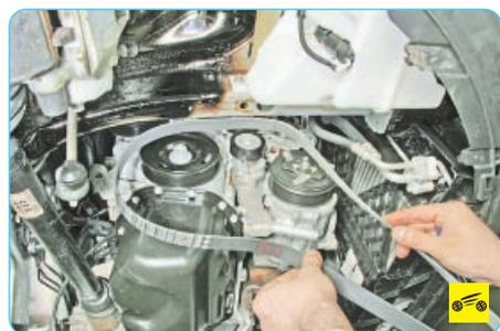
2. Снимите ремень привода вспомогательных агрегатов (см. «Снятие и установка ремня привода вспомогательных агрегатов», с. 70).
