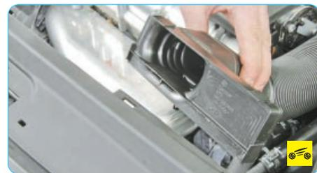
1. Для удобства работы снимите воздухозаборник воздушного фильтра (см. «Снятие и установка воздушного фильтра и воздухозаборника», с. 102).
