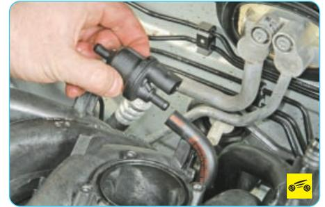
5. Снимите клапан, сняв с его штуцеров оба шланга.
