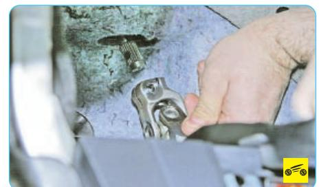
11. ...и снимите промежуточный вал с вала-шестерни рулевого механизма.
