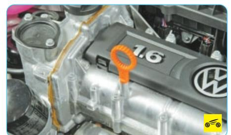
Указатель уровня масла (маслоизмерительный щуп) расположен в передней части моторного отсека на корпусе распределительных валов.
