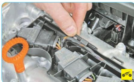
4. ...и откиньте крышку крепления жгута низковольтного провода катушки зажигания.
