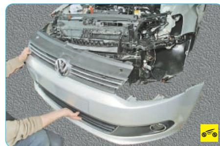
1. Снимите передний бампер (см. «Снятие и установка переднего бампера», с. 222).
