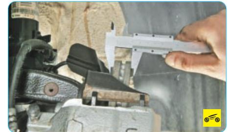
3. Установив автомобиль на домкрат, поочередно снимите передние колеса и осмотрите тормозные диски. Толщина тормозного диска должна быть не менее 19,0 мм, поверхность диска – ровной и гладкой с обеих сторон. Если поверхность диска местами покрыта ржавчиной, что обычно бывает после продолжительной стоянки автомобиля с непросушенными тормозами, попробуйте зачистить рабочую поверхность мелким наждачным полотном. Если эта процедура не поможет, придется отдать диски в шлифовку или заменить новыми.
