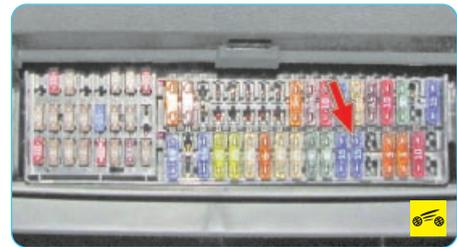
6. Если искры нет ни на одной катушке зажигания, проверьте, не перегорели ли предохранители катушек в монтажном блоке, расположенном в монтажном блоке предохранителей в панели приборов. Если предохранители перегорели, замените их и пустите двигатель.
