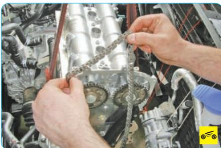
9. Снимите цепь привода газораспределительного механизма сначала со звездочки коленчатого вала, затем со звездочек распределительных валов.
