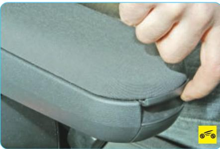
Для доступа к вещевому ящику, расположенному в переднем подлокотнике, нажмите на фиксатор крышки...
