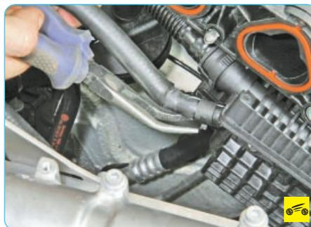
30. Сожмите пассатижами ушки хомута крепления шланга системы охлаждения двигателя для подогрева системы вентиляции картера, сдвиньте хомут по шлангу...
