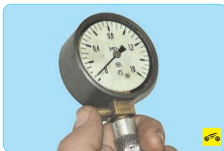
8. Записав показания компрессометра, установите его стрелку на ноль, нажав на клапан выпуска воздуха.
