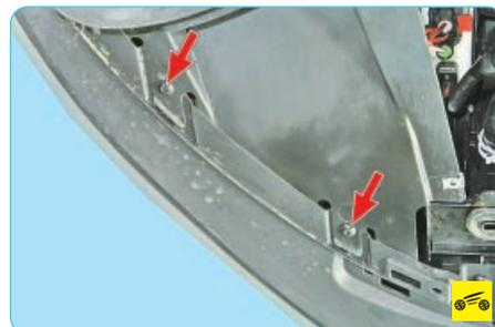
12. Выверните по два винта нижнего бокового крепления бампера с обеих сторон.
