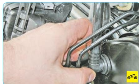
3. ...и в отверстии корпуса вакуумного усилителя.
