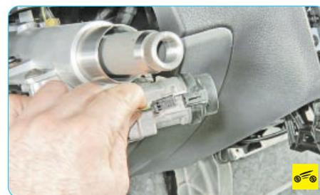
6. ...и отсоедините колодку проводов антенного блока иммобилизатора (для наглядности показано со снятым блоком подрулевых переключателей).
