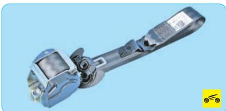
23. Установите ремень безопасности и все ранее снятые детали в порядке, обратном снятию.
