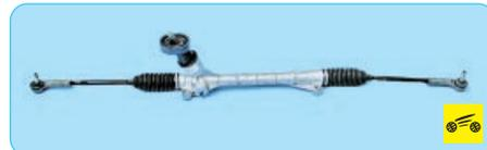
8. Снимите рулевой механизм.
