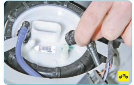
9. ...и отсоедините наконечники топливопроводов от штуцеров топливного модуля.
