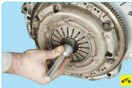
17. При монтаже сцепления сначала с помощью оправки установите ведомый диск, а затем кожух нажимного диска, совместив нанесенные перед снятием метки...
