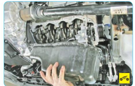
7. Отделите масляный картер, слегка обстукивая его по периметру резиновым молотком (для наглядности показано со снятой приемной трубой системы выпуска отработавших газов).
