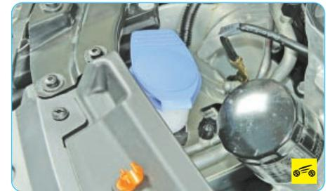
Наливная горловина бачка омывателя расположена в моторном отсеке справа у рамки радиатора.
