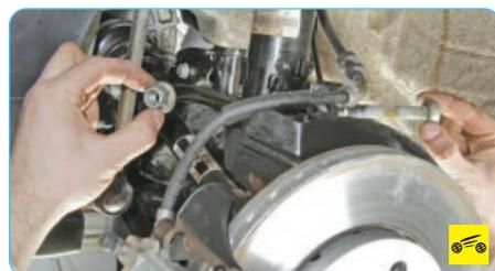
20. ...отверните гайку болта крепления поворотного кулака к амортизаторной стойке и извлеките болт.
