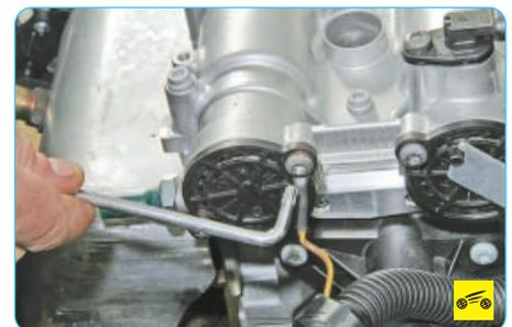
7. Выверните болт крепления крышки выпускного распределительного вала и извлеките болт из отверстия. Аналогично выверните и извлеките 2-й болт крепления крышки распределительного вала...
