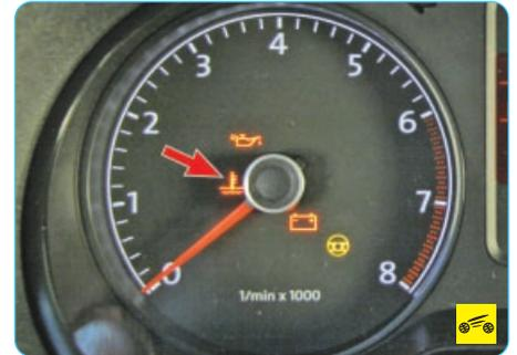
В комбинации приборов вашего автомобиля установлена сигнальная лампа перегрева жидкости в системе охлаждения двигателя (со светофильтром красного цвета). При загорании лампы следует остановиться, дать двигателю остыть и устранить причину перегрева.
