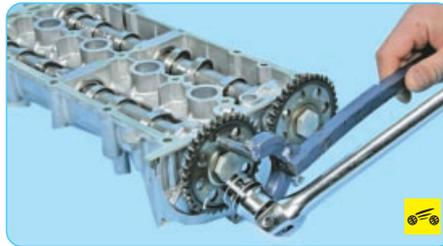
14. Ослабьте затяжку болтов крепления звездочек распределительных валов и снимите звездочки.
