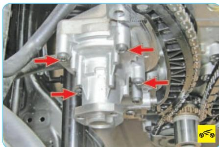
5. Выверните четыре винта крепления водяного насоса и снимите его (для наглядности крышка цепи привода газораспределительного механизма снята).
