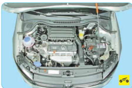
1. Откройте капот и осмотрите подкапотное пространство. При осмотре двигателя обратите внимание на наличие охлаждающей жидкости в расширительном бачке, на целостность резиновых шлангов. Следует также проверить соединения шлангов с патрубками радиатора, термостата, расширительного бачка.
