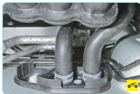
5. Осмотрите соединения шлангов системы охлаждения с патрубками радиатора отопителя.
