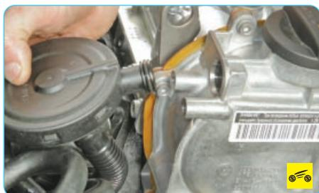
5. Отсоедините маслоотделитель от крышки цепи привода газораспределительного механизма (см. «Очистка системы вентиляции картера», с. 67).
