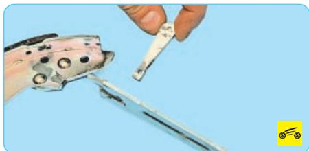
24. Отсоедините от передней колодки распорную планку и клин механизма регулировки зазоров.
