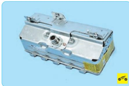
11. ...и снимите модуль подушки безопасности.
