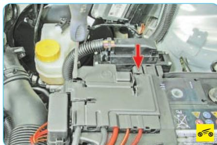
3. Отожмите отверткой два фиксатора крышки плавких вставок монтажного блока...
