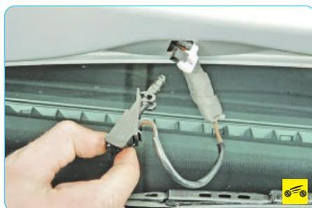
7. ...и отсоедините от форсунок трубки подачи омывающей жидкости.
