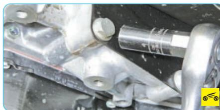
21. Выверните два болта крепления щитка картера гидротрансформатора...
