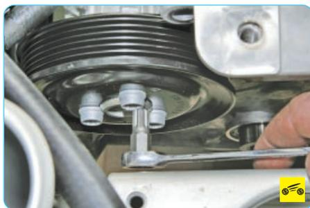
3. Выверните три винта крепления шкива водяного насоса...
