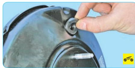
8. Извлеките из отверстия в корпусе усилителя резиновую уплотнительную втулку. Сильно обжатую или затвердевшую втулку замените.
