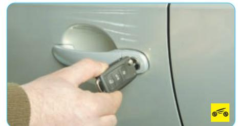
Двери можно заблокировать снаружи ключом, повернув по часовой стрелке цилиндр выключателя замка двери водителя...
