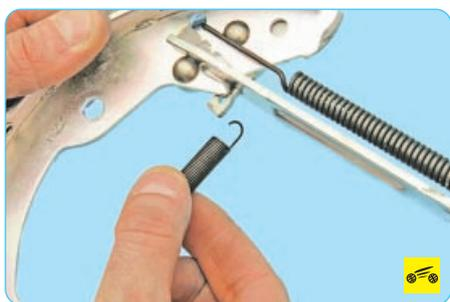
21. ...и снимите пружину, извлекая ее силой отогнутый конец из отверстия клина.
