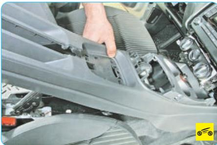
1. В салоне автомобиля снимите облицовку тоннеля пола (см. «Снятие и установка облицовок тоннеля пола и консоли панели приборов», с. 238).
