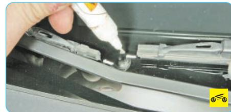
Перед снятием рычагов нанесите метки исходного положения правой и левой щеток стеклоочистителя на ветровом стекле. Это необходимо для того, чтобы после установки обеспечить работу щеток в требуемой зоне ветрового стекла.
