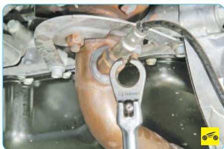
2. Выверните диагностический датчик концентрации кислорода и извлеките его из приемной трубы.
