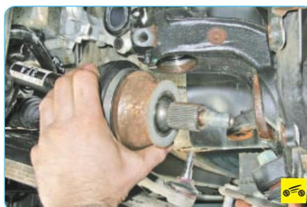
10. Выведите шлицевый хвостовик наружного шарнира равных угловых скоростей привода переднего колеса из ступицы.
