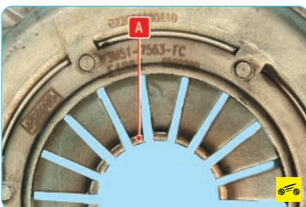
12. Внешним осмотром оцените состояние диафрагменной пружины нажимного диска. Наличие трещин на диафрагменной пружине не допускается. Места **A** контакта лепестков пружины с подшипником выключения сцепления должны находиться в одной плоскости и не иметь явных следов износа (не более 0,8 мм). В противном случае замените нажимной диск в сборе.
