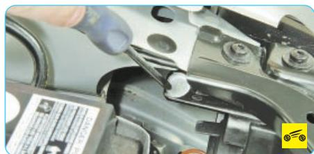
7. Откройте капот и, вращая регулировочные винты, отрегулируйте (если расположение световых пятен не соответствует рисунку) положение на экране светового пятна для каждой фары по вертикали...
