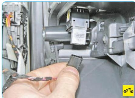
4. ...и отсоедините колодку от выключателя управления стеклоподъемником.
