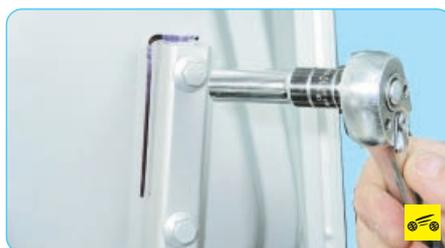
8. Выверните четыре болта крепления петель к крышке багажника (по два на левой и правой петлях) и снимите крышку.
