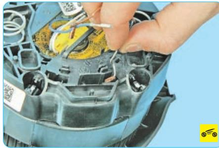
13. Извлеките провод «массы» из держателя на модуле подушки безопасности...
