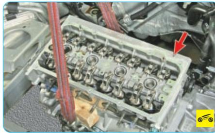
17. Очистите привалочные поверхности головки блока цилиндров...
