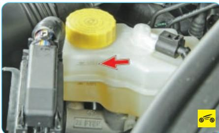
**Регулярно проверяйте уровень тормозной жидкости в бачке главного тормозного цилиндра. Уровень тормозной жидкости должен быть около метки «MAX» на корпусе бачка.**
