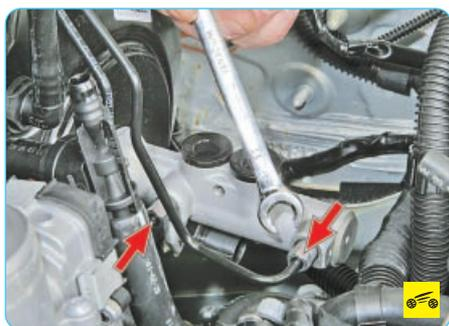
4. Отверните гайки крепления двух трубопроводов к главному тормозному цилиндру и отведите трубопроводы в сторону.
