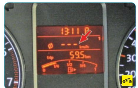
В режиме отображения **средней скорости** показывается значение средней скорости с момента ее последнего обнуления. Значения средней скорости движения выводятся только через 100 м пути с момента начала движения. До этого на дисплее отображается лишь прочерки. Показания обновляются примерно каждые 5 с.
