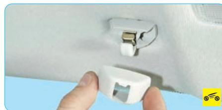
4. Поддев отверткой, снимите фиксатор держателя козырька...
