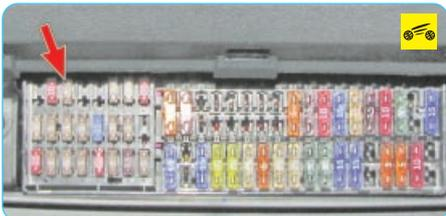
Электробензонасос может не работать из-за перегорания предохранителя «F/PUMP» в монтажном блоке в панели проборов...
