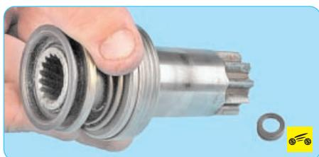
33. Снимите муфту с вала привода и извлеките из муфты ограничительное кольцо.
