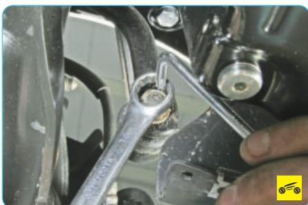
5. Аналогично отверните гайку нижнего крепления шарнира стойки к стабилизатору поперечной устойчивости.
