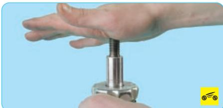
13. Установите амортизаторную стойку в вертикальное положение и несколько раз до упора опустите и поднимите шток амортизатора. Перемещая шток, убедитесь в том, что он перемещается без провалов, заеданий и стуков. В противном случае замените стойку. Кроме того, замените амортизаторную стойку при обнаружении потеков жидкости.
