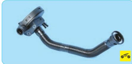
10. Промойте бензином или керосином внутреннюю полость маслоотделителя и шланги. Установите маслоотделитель на место, заменив уплотнительную прокладку новой. Промойте обратный клапан и шланг системы вентиляции картера, соединяющий корпус распределительных валов и воздушный фильтр.
