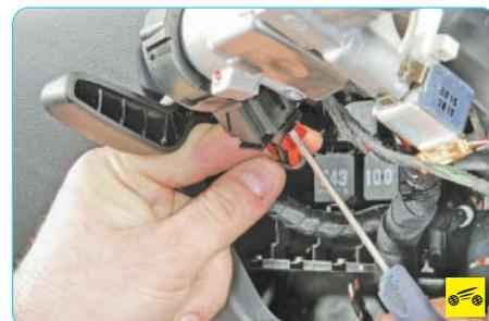
11. Подденьте отверткой и сдвиньте вниз стопор колодки жгута проводов контактной группы выключателя (замка) зажигания...
