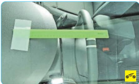
5. ...и в таком положении нанесите на обод рулевого колеса вторую метку.
