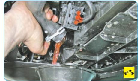
2. Слейте жидкость из системы охлаждения двигателя (см. «Замена охлаждающей жидкости», с. 94).
