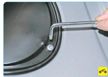
7. Выверните три винта крепления крышки люка над топливным модулем...
