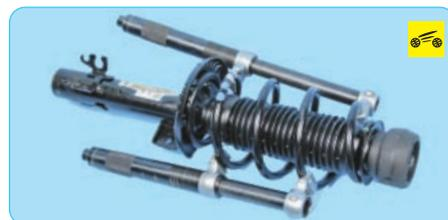
2. Установите приспособление для сжатия пружины и сожмите пружину.
