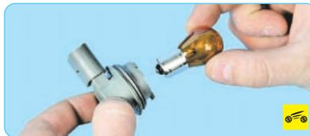
3. Нажмите на лампу, поверните ее против часовой стрелки и извлеките из патрона (для наглядности показано на снятом патроне лампы указателя поворота).
