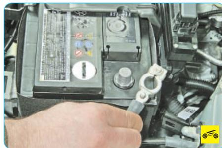
1. Отсоедините провод от клеммы «минус» аккумуляторной батареи.
