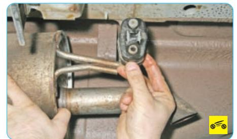
3. Снимите подушку подвески основного глушителя с кронштейна глушителя.
