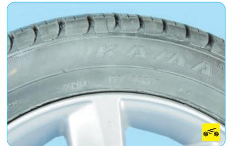
Обозначение шины нанесено на ее боковину.
