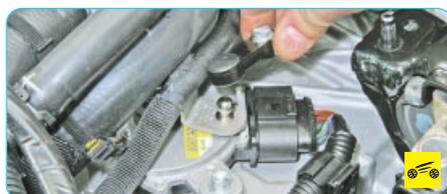
4. Отсоедините наконечник троса управления коробкой передач от рычага механизма управления, преодолевая упругое сопротивление его фиксаторов.
