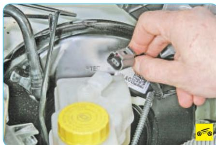
5. Нажмите на фиксатор колодки жгута проводов датчика уровня тормозной жидкости и отсоедините колодку от датчика.
