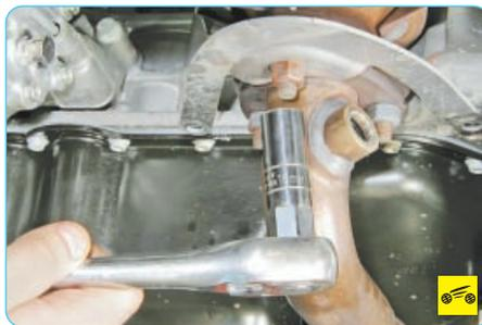
5. Отверните гайку крепления приемной трубы к катколлектору, которой одновременно прикреплен кронштейн...
