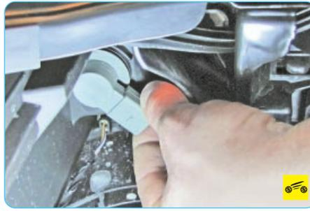
1. Поверните патрон лампы указателя поворота против часовой стрелки на 45°...
