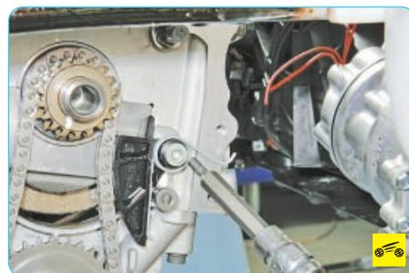
4. Выверните болт крепления натяжителя к блоку цилиндров...
