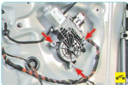
3. Выверните три болта крепления моторе-
