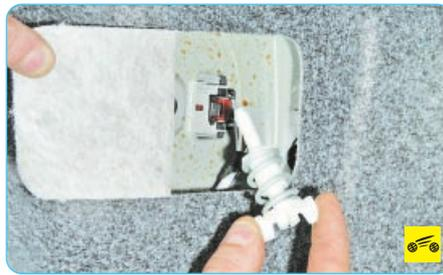
3. Выверните фиксатор заднего фонаря и извлеките фиксатор из отверстия в кузове.
