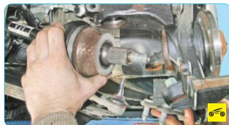
17. Извлеките хвостовик наружного шарнира из отверстия ступицы переднего колеса. Закрепите на кузове, например проволокой, привод переднего колеса, не допуская перегиба внутреннего шарнира.
