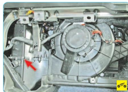
Радиатор помещен в пластмассовый кожух климатического блока, установленный под центральной частью панели приборов.
