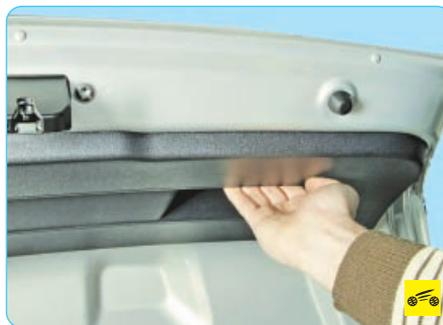
Чтобы закрыть крышку багажника, потяните ее вниз за рукоятку в обивке крышки и захлопните – замок крышки автоматически заблокируется.
