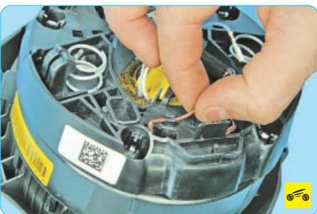
11. Извлеките провод из держателя на модуле подушки безопасности...
