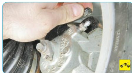
3. Очистите от грязи клапаны выпуска воздуха и снимите защитные колпачки клапанов рабочих цилиндров тормозных механизмов передних...
