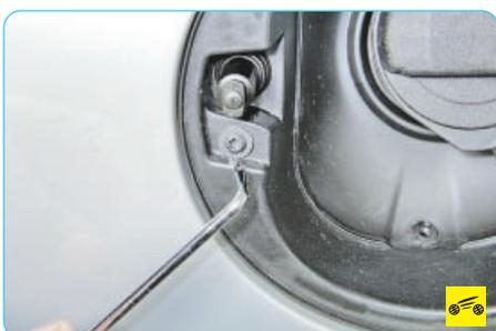
2. Выверните винт крепления облицовки люка наливной трубы топливного бака.
