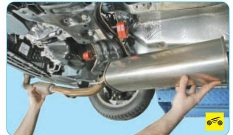
34. Снимите дополнительный глушитель (см. «Замена блока дополнительного глушителя и приемной трубы», с. 111).
