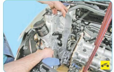
2. Снимите крышку цепи привода газораспределительного механизма (см. «Замена прокладки крышки цепи привода газораспределительного механизма», с. 75).
