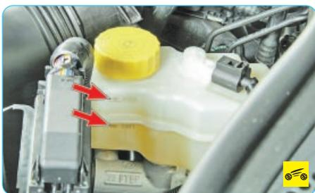
13. Долейте тормозную жидкость до уровня между метками «MAX» и «MIN» на стенке бачка и заверните пробку.
