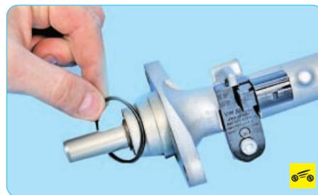
7. Снимите с корпуса главного тормозного цилиндра резиновое уплотнительное кольцо.
