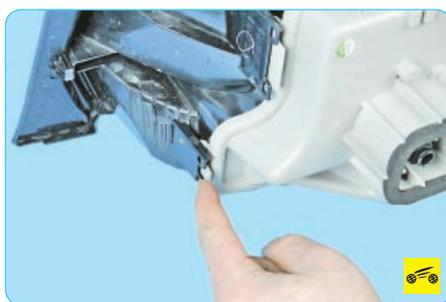
3. Отожмите фиксаторы держателя ламп заднего фонаря...
