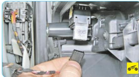
9. ...отсоедините колодки жгутов проводов от выключателя стеклоподъемника и снимите обивку.
