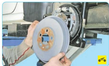
8. Снимите тормозные барабаны (см. «Снятие и установка тормозного барабана», с. 173).
