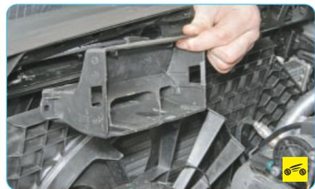
2. Снимите воздухозаборник (см. «Снятие и установка воздушного фильтра и воздухозаборника», с. 102).
