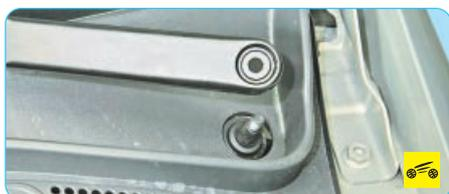
4. ...и, покачивая рычаг стеклоочистителя из стороны в сторону, снимите его с оси поводка трапеции.
