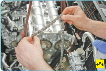
12. Снимите цепь привода газораспределительного механизма (см. «Снятие и установка цепи привода газораспределительного механизма», с. 71).
