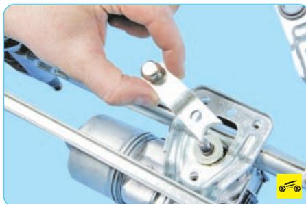
11. Подденьте отверткой и снимите кривошип с оси моторередуктора.
