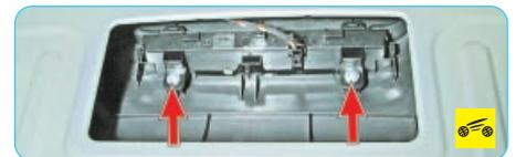
4. Выверните два винта крепления дополнительного стоп-сигнала...
