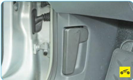
**31 – рукоятка привода замка капота** (см. «Капот», с. 33).
