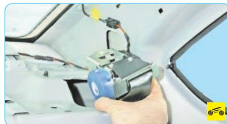
9. ...и извлеките катушку из полости задней полки. Снимите задний боковой ремень безопасности.
