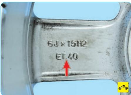
...или легкосплавные диски с вылетом ET, равным 40 мм (обозначение нанесено налицевую сторону стального диска или на внутреннюю сторону легкосплавного).
