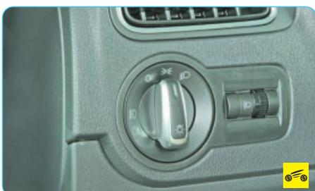
**1** – включены габаритные огни, подсветка комбинации приборов и фонари освещения номерного знака;
