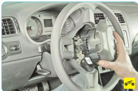
2. Снимите подушку безопасности (см. «Снятие и установка подушки безопасности водителя», с. 204).
