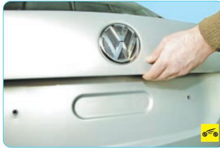
После разблокирования замка крышка багажника немного приподнимется. Возьмитесь за верхний край ниши для номерного знака и поднимите крышку вверх.
