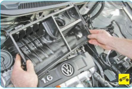
4. Снимите корпус воздушного фильтра (см. «Снятие и установка воздушного фильтра и воздухозаборника», с. 102).
