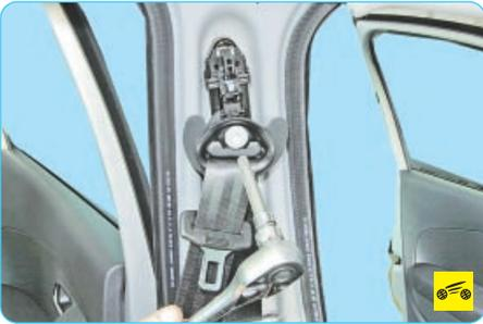
7. Выверните болт верхнего крепления ремня безопасности к механизму регулировки ремня безопасности по высоте...
