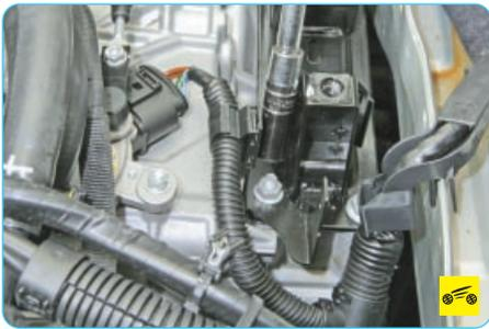
8. При необходимости снимите с коробки передач кронштейн левой опоры подвески силового агрегата, для чего отверните гайку кронштейна жгута проводов...
