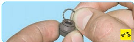
Если в комплекте новых маслоъемных колпачков нет установочной втулки, перед установкой колпачков рекомендуем снять с них пружины, иначе колпачки можно повредить, когда они будут проходить через проточки под сухари на клапанах.
