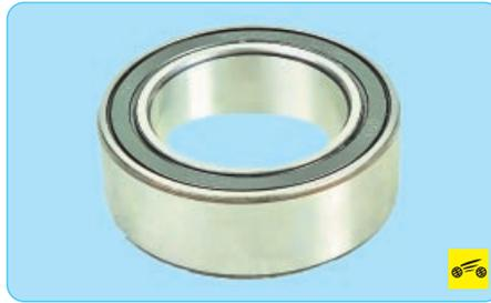
Шкив привода компрессора установлен на двухрядном шариковом подшипнике и при работающем двигателе постоянно вращается. Крутящий момент передается от шкива к валу компрессора через ведомый диск.
