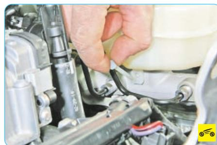
7. ...и извлеките стержень из отверстий бачка и главного тормозного цилиндра.
