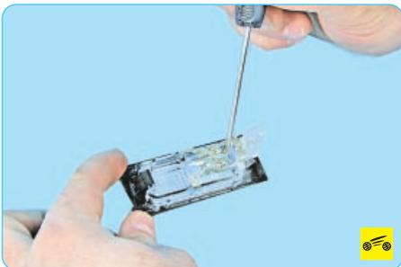
4. Отверткой вытолкните лампу фонаря освещения номерного знака из держателя в фонаре...
