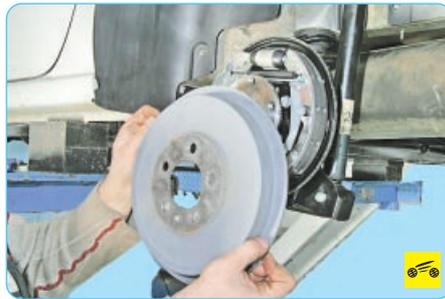
9. Снимите тормозной барабан (см. «Снятие и установка тормозного барабана», с. 173).
