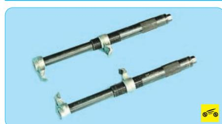
Если у вас есть приспособление для сжатия пружин, можно предварительно сжать пружину приспособлением, разгрузить подвеску и снять пружину без выполнения последующих операций.
