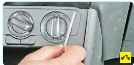
2. Подденьте отверткой с плоским лезвием декоративную накладку панели приборов...
