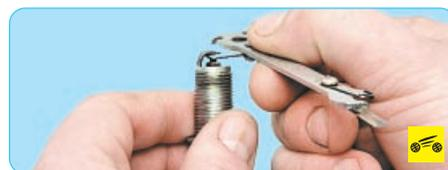
5. Проверьте круглым щупом зазор между электродами свечи. Зазор должен составлять 1,0–1,1 мм.
