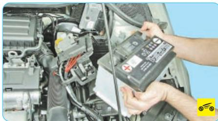
10. Извлеките аккумуляторную батарею из моторного отсека.
