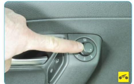
Для регулировки положения зеркал наклоните в соответствующую сторону рукоятку джойстика. При отпускании рукоятка автоматически возвращается в среднее положение. По окончании регулировки поверните рукоятку в среднее положение.
