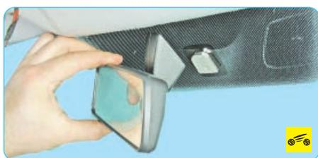
1. Преодолевая сопротивление пружинного фиксатора, сдвиньте зеркало вверх вдоль стекла и снимите с кронштейна, приклеенного к ветровому стеклу.
