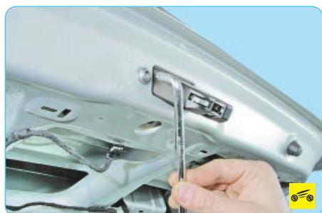
3. Выверите два винта крепления замка крышки багажника...
