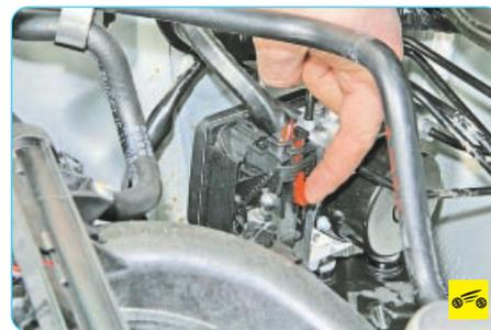
2. Отожмите вниз стопор фиксирующей скобы...
