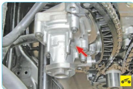
**Водяной насос** центробежного типа обеспечивает принудительную циркуляцию жидкости в системе охлаждения, установлен на передней поверхности блока цилиндров и приводится во вращение поликлиновым ремнем от шкива коленчатого вала. В насосе установлены закрытые подшипники, не нуждающиеся в пополнении смазки. Насос ремонту не подлежит, поэтому при отказе (течь жидкости или повреждение подшипников) его заменяют в сборе.
