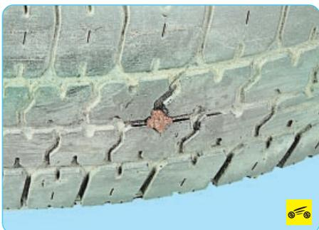
13. Подождите указанное в прилагаемой к ремонтному набору инструкции время, необходимое для полимеризации клея, и накачайте колесо до рекомендуемого давления.
