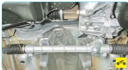
7. ...и закрепите, например проволокой, рулевой механизм на кузове (для наглядности показано при опущенной поперечине передней подвески).
