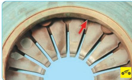
14. Внешним осмотром оцените состояние опорных колец нажимной пружины с ее наружной и внутренней стороны. На кольцах не должно быть трещин и следов износа. В противном случае замените нажимной диск в сборе.
