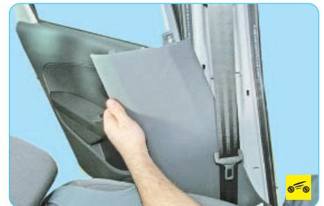
3. ...и снимите нижнюю облицовку центральной стойки (см. «Снятие и установка облицовок салона», с. 242).
