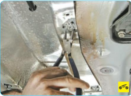
4. Снимите пассатижами держатель термоэкрана со шпилек на основании кузова...
