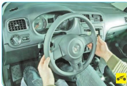
Отрегулируйте положение рулевого колеса по углу наклона и вылету таким образом, чтобы были хорошо видны все приборы в комбинации приборов, а руки на рулевом колесе находились в наиболее удобном положении, затем заблокируйте рулевую колонку, подняв рычаг до упора вверх.
