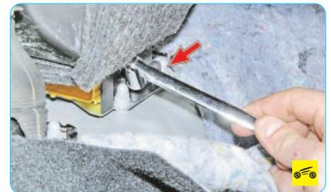
6. Отверните две гайки шпилек крепления электронного блока управления справа...
