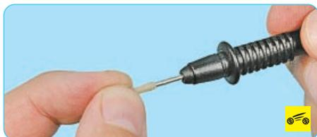
Для того чтобы было легче измерить сопротивление датчика наружной температуры, наденьте на наконечники обоих щупов тестера оболочку от провода до половины длины оболочки. Затем подсоедините оба щупа к выводам датчика, надевая оболочки на выводы датчика так, чтобы щуп коснулся вывода датчика.
