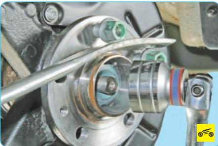
В этом случае предварительно снимите колесо и ослабьте гайку ступицы, удерживая ступицу от проворачивания монтажной лопаткой, опирая ее на два болта крепления колеса, ввернутые в отверстия ступицы на несколько ниток резьбы.
