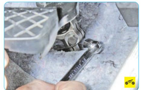
10. Выверните стяжной болт клеммового соединения промежуточного вала с валом-шестерней рулевого механизма...
