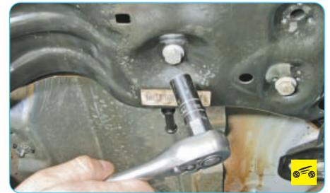
6. Выверните болт крепления задней опоры к поперечине передней подвески...
