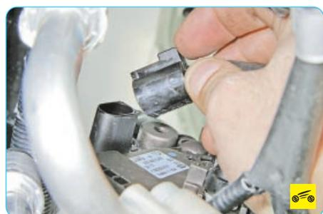
3. Отожмите фиксатор колодки жгута проводов и отсоедините колодку от генератора.
