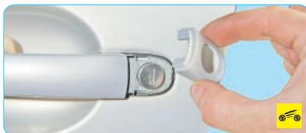
1. Подденьте отверткой и снимите декоративную накладку выключателя замка двери.
