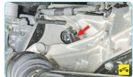
– датчика положения коленчатого вала – полный отказ системы впрыска, двигатель не пускается;
