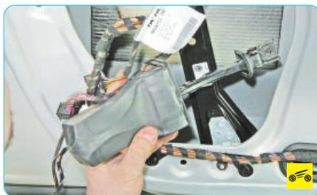
4. Снимите ограничитель через отверстие во внутренней панели двери.
