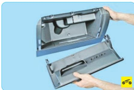
10. Снимите крышку вещевого ящика.
