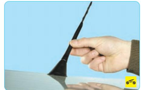
Для снятия антенны выверните ее из кронштейна, вращая против часовой стрелки...
