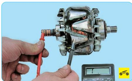
14. Проверьте замыкание обмотки ротора на «массу». Для этого подсоедините щупы тестера к полюсу ротора и поочередно к контактным кольцам. Измеренное сопротивление должно быть бесконечно большим, в противном случае замените ротор.
