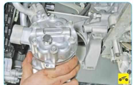
37. Снимите компрессор кондиционера, не отсоединяя от него трубопроводов, и закрепите компрессор на кузове (см. «Снятие и установка компрессора кондиционера», с. 257).
