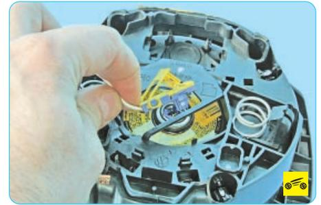
17. ...и отсоедините колодку жгута проводов от модуля подушки безопасности.
