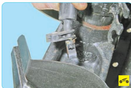
5. Снимите с поворотного кулака датчик частоты вращения колеса (см. «Снятие и установка датчиков частоты вращения колес», с. 271).
