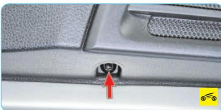
5. ...и один винт нижнего крепления обивки двери.
