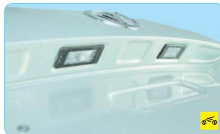
– лампы фонарей освещения номерного знака, тип лампы W5W (5 Вт).
