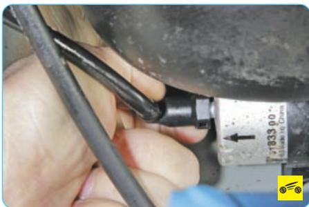
11. Сожмите фиксатор наконечника отводящего топливопровода...
