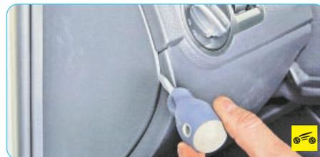
2. Подденьте отверткой крышку торца панели приборов...
