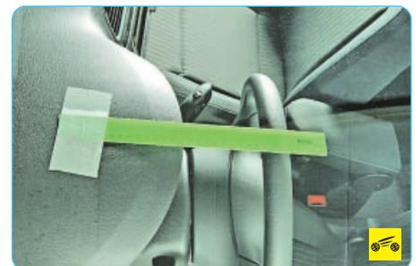
2. Установите линейку так, чтобы она была неподвижно зафиксирована на панели приборов, а плоскость линейки касалась наружной поверхности обода рулевого колеса.
