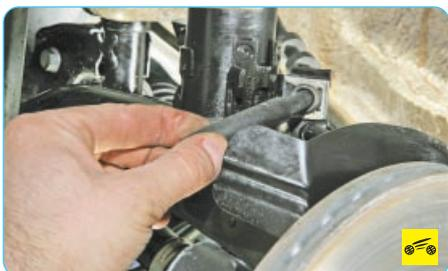
9. Извлеките втулку тормозного шланга из пазов держателя на амортизаторной стойке.
