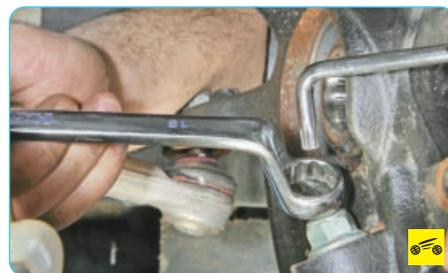
8. Отверните гайку пальца шаровой опоры, удерживая палец от проворачивания.
