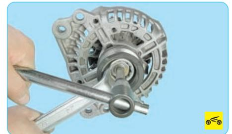
9. Удерживая вал генератора от проворачивания, отверните гайку шкива генератора...
