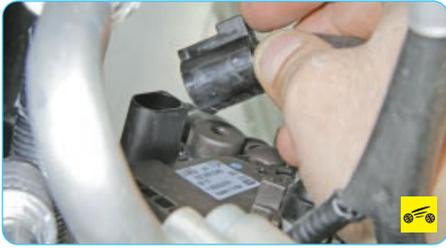
38. Отсоедините колодку жгута проводов от генератора.
