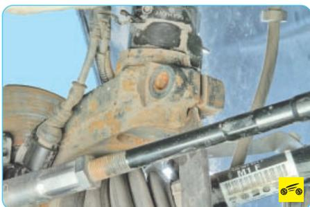
24. Извлеките стойку из клеммового соединения поворотного кулака, предварительно разжав монтажной лопаткой клемму.
