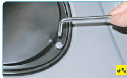
4. Выверните три винта крепления крышки люка над топливным модулем...
