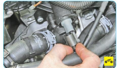
3. Сожмите фиксатор колодки жгута проводов датчика температуры охлаждающей жидкости и отсоедините колодку.
