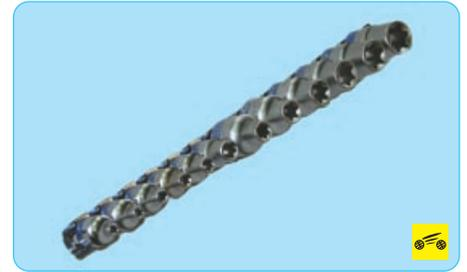
...и E. На автомобиле часть крепежных деталей (в основном на двигателе) выполнена под инструмент TORX;
