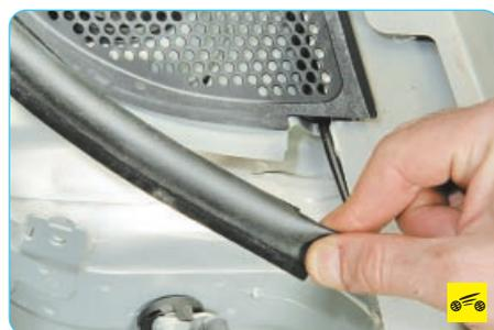
2. Возьмите за край и снимите уплотнитель капота.
