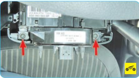
5. Выверните два винта крепления нижней части кожуха рулевой колонки...
