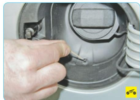
5. ...и в облицовке люка наливной горловины топливного бака.
