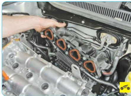
29. Выверните болты крепления и отведите впускную трубу от блока цилиндров (см. «Замена прокладок впускной трубы», с. 79).
