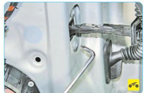
3. ...и два винта его крепления к переднему торцу двери.
