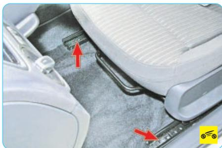
2. Сдвиньте сиденье до упора назад и выверните два передних винта крепления направляющих салазок сиденья к основанию кузова.
