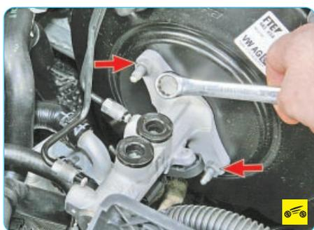
5. Отверните две гайки крепления главного тормозного цилиндра к вакуумному усилителю...
