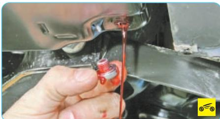
6. При нормальном уровне рабочая жидкость начинает вытекать из отверстия при достижении температуры 35–37 °С.
