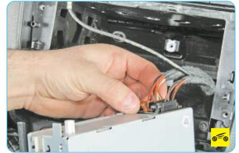
8. Отожмите фиксатор колодки жгута проводов...
