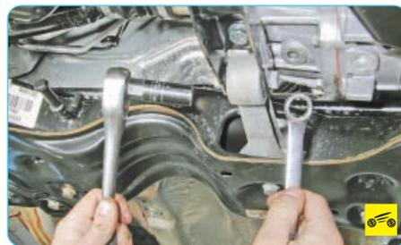
3. Удерживая головку болта крепления от проворачивания, отверните гайку крепления задней опоры к кронштейну силового агрегата и извлеките болт из отверстия.
