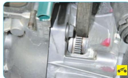
11. Удерживая коленчатый вал от проворачивания монтажной лопаткой за маховик, как показано на фото...
