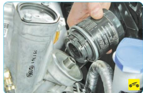
7. ...и, отвернув рукой, снимите его.
