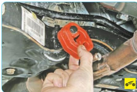
8. Снимите подушку подвески приемной трубы с кронштейна на трубе.
