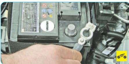
1. Отсоедините провод от клеммы «минус» аккумуляторной батареи.
