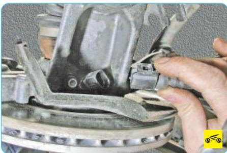
3. Отожмите фиксатор колодки жгута проводов датчика частоты вращения переднего колеса и отсоедините колодку от датчика.
