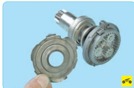
27. ...и снимите маслоотражатель планетарного механизма.
