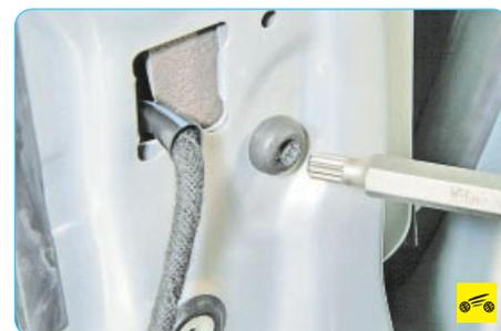
6. Выверните болт крепления зеркала, придерживая его с наружной стороны.
