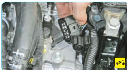
17. Отожмите фиксатор колодки жгута проводов и отсоедините колодку от блока управления коробкой передач.
