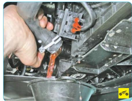
1. Слейте жидкость из системы охлаждения двигателя (см. «Замена охлаждающей жидкости», с. 94).
