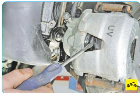
2. Вставив большую отвертку между внутренней тормозной колодкой и поршнем рабочего цилиндра, утопите поршень в цилиндр.
