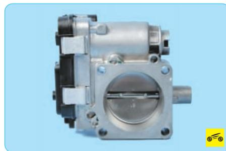
**Дроссельный узел**, представляющий собой простейшее регулирующее устройство, служит для изменения количества основного воздуха, подаваемого во впускную систему двигателя, установлен на входном фланце впускной трубы и прикреплен четырьмя болтами. На входной патрубок дроссельного узла надет формованный воздухоподводящий резиновый рукав, закрепленный хомутом и соединяющий дроссельный узел с воздушным фильтром.
