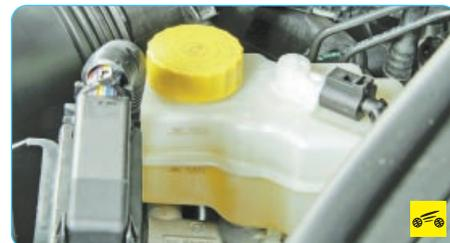
4. Проверьте уровень тормозной жидкости в бачке гидроприводов тормозной системы и выключения сцепления (на автомобилях с механической коробкой передач). При необходимости долейте жидкость до нормы.
