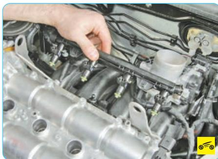
7. ...и снимите рампу, вынимая форсунки из отверстий впускной трубы.
