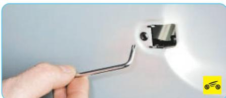
6. Выверните винт крепления кронштейна наружной ручки...
