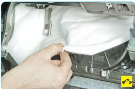
6. При необходимости снимите шумоизоляционную шторку.
