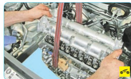
13. Снимите корпус распределительных валов (см. «Замена прокладок корпуса распределительных валов», с. 76).
