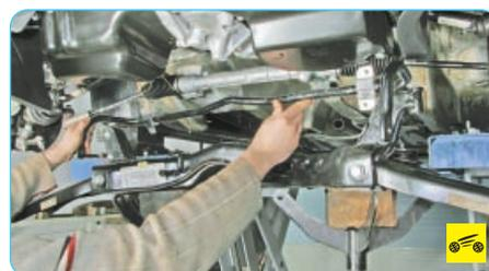
13. ...и снимите стабилизатор.
