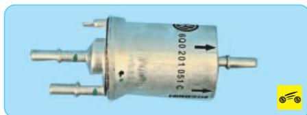
**Фильтр очистки топлива** полнопоточный, установлен на кронштейне топливного бака. При засорении фильтра его необходимо заменить.
