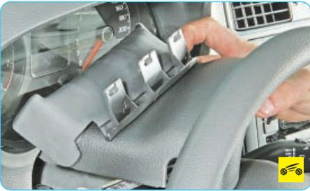
3. ...и, преодолевая усилие фиксаторов, снимите две верхние части кожуха.
