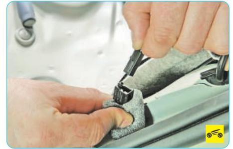
5. В салоне автомобиля нажмите на фиксатор колодки жгута проводов датчика частоты вращения заднего колеса и отсоедините колодку датчика от переходной колодки.
