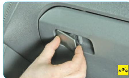
...потяните на себя фиксатор крышки ящика...
