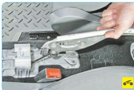
8. ...и снимите рычаг.
