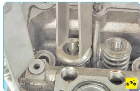
6. Сожмите приспособлением пружину клапана...
