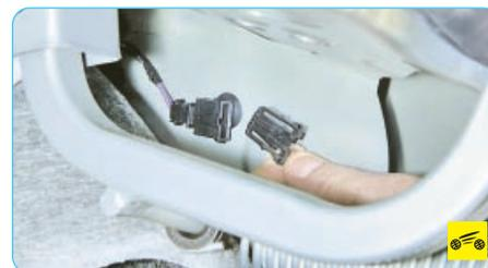
3. Отсоедините колодку замка крышки люка наливной трубы топливного бака от колодки жгута проводов.
