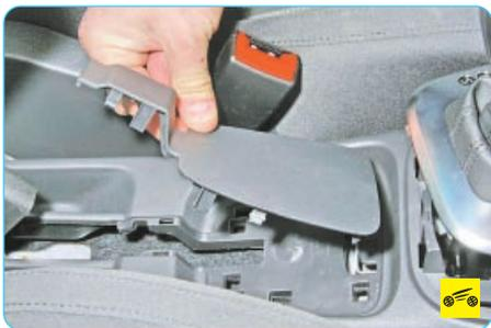
14. Подденьте отверткой облицовку рычага стояночного тормоза и снимите ее.
