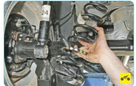
2. Отсоедините нижние крепления амортизаторов задней подвески (см. «Снятие и установка амортизатора задней подвески», с. 146) и снимите пружины задней подвески (см. «Замена пружины задней подвески», с. 147).
