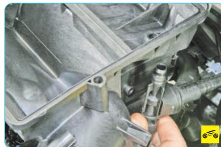
9. Извлеките наконечник вакуумного шланга из отверстия в корпусе воздушного фильтра.
