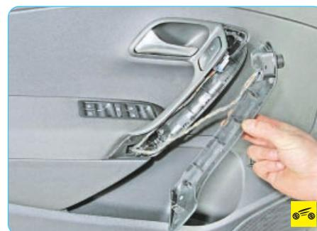
3. ...и, преодолевая сопротивление фиксаторов, снимите крышку.
