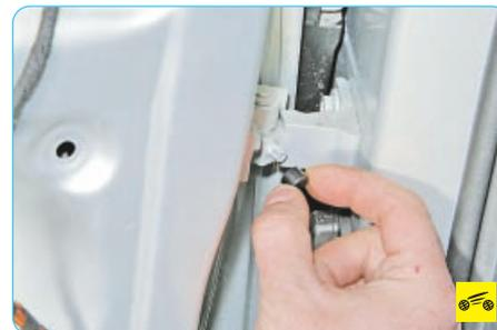
4. Снимите защитные колпачки с болтов крепления осей верхней и нижней петель двери.
