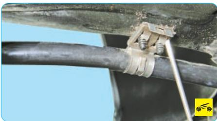
11. Подденьте отверткой фиксатор держателя троса привода стояночного тормоза...
