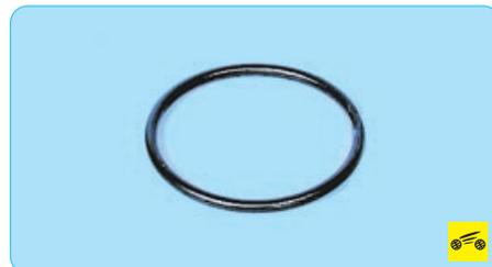
Уплотнительное кольцо главного тормозного цилиндра при каждой разборке соединения заменяйте новым.
