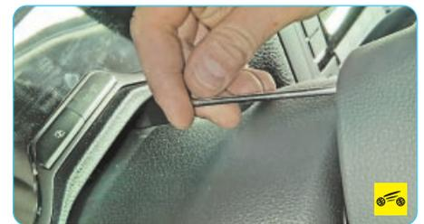
4. Вставьте отвертку в отверстие кожуха рулевого колеса...
