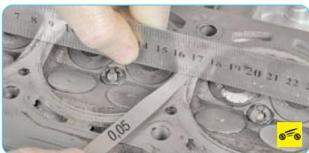
18. Проверьте головку блока на отсутствие коробления. Для этого поставьте линейку ребром на поверхность головки сначала посередине вдоль...
