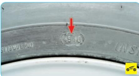
**дата изготовления шины** – состоит из четырех цифр, первые две указывают неделю, а две последние – год изготовления (до 2000 года – из трех цифр, одна последняя из которых – год изготовления);
