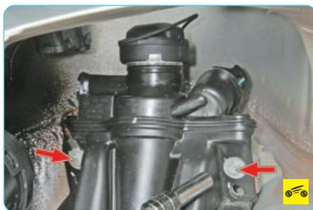
17. Выверните два винта крепления наливной горловины к кузову.
