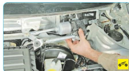
7. ...и снимите трапецию стеклоочистителя в сборе с моторедуктором.
