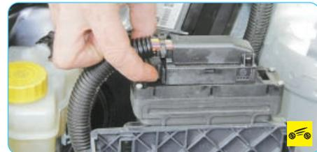
2. Выдвиньте фиксатор колодки жгута проводов блока управления автоматической коробкой передач...
