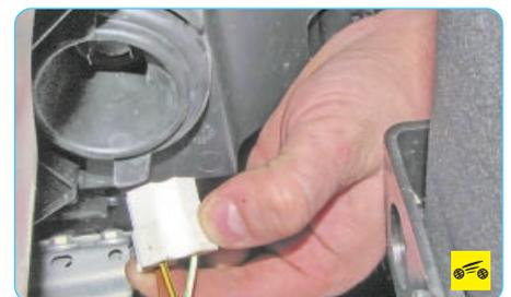
2. Подденьте колодку жгута проводов лампы ближнего/дальнего света фары и отсоедините колодку от лампы.
