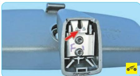
Так выглядит пружинный фиксатор снятого с автомобиля зеркала.
