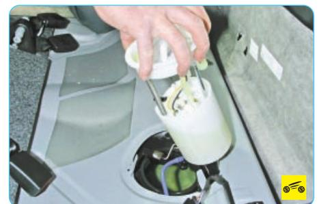
13. ...и извлеките топливный модуль из топливного бака.
