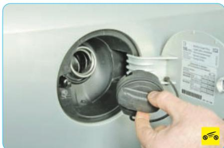
4. Поверните пробку наливной горловины топливного бака против часовой стрелки и снимите ее.
