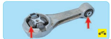
8. Проверьте состояние резинометаллических шарниров задней опоры. Опору с надорванными или со следами выпучивания резины шарнирами замените.
