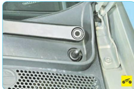
1. Снимите рычаги с валов поводков трапеции стеклоочистителя (см. «Снятие и установка рычагов стеклоочистителя ветрового окна», с. 227).
