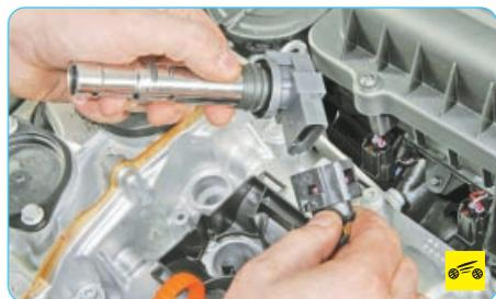
3. Снимите катушки зажигания (см. «Снятие и установка катушек зажигания», с. 194).
