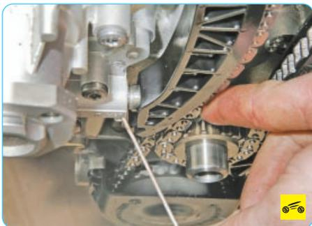
16. Натяните цепь привода газораспределительного механизма, вынув фиксирующий штифт из отверстия натяжителя.
