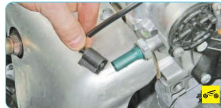
8. Отсоедините колодку жгута проводов от датчика сигнальной лампы аварийного падения давления масла.
