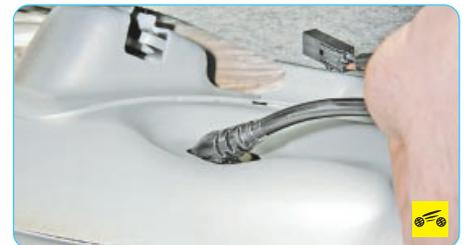
7. Протолкните уплотнитель провода датчика в отверстие кузова.
