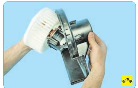
6. ...и извлеките электродвигатель с крыльчаткой из корпуса воздуходувателя.
