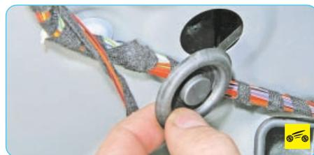
2. Снимите заглушку отверстия во внутренней панели двери и, подсоединив колодку жгута проводов управления электростеклоподъемниками дверей к блоку управления электростеклоподъемниками (см. «Снятие и установка обивки передней двери», с. 227), установите стекло передней двери в положение, при котором передний винт крепления стекла к электростеклоподъемнику будет расположен напротив открывшегося отверстия.
