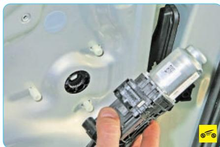
6. ...и снимите моторедуктор.
