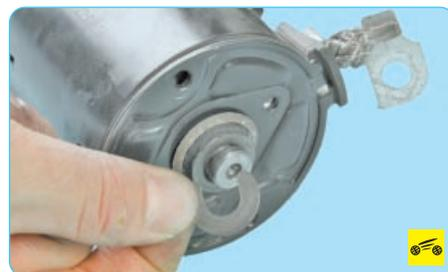
10. Снимите стопорное...
