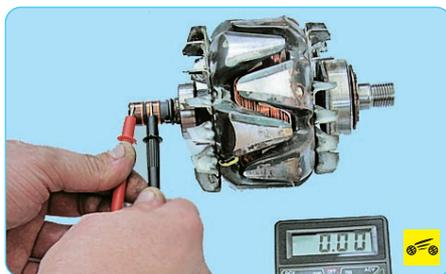
15. Проверьте тестером сопротивление обмотки ротора, подсоединив его к контактным кольцам. Сопротивление должно составлять не более 2,1–2,4 Ом. Если тестер покажет бесконечность, значит, в обмотках обрыв и нужно заменить ротор.
