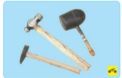
– молотки разных размеров с металлическими и резиновым бойками (последние необходимы при проведении рихтовочных работ);
