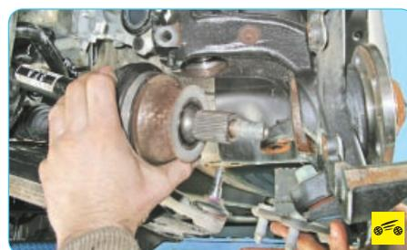
10. Выведите наконечник наружного шарнира из отверстия ступицы переднего колеса. Закрепите привод переднего колеса на кузове, например проволокой, не допуская перегибов внутреннего шарнира.
