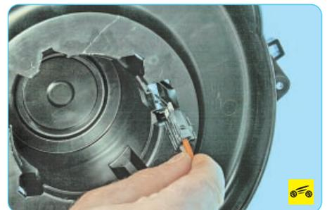
7. Извлеките колодку жгута проводов из проема корпуса воздуходувателя.
