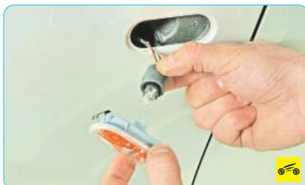
3. Проверните патрон и извлеките его из фонаря указателя поворота.
