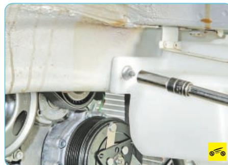
7. Отверните гайку заднего крепления бачка стеклоомывателя к кузову. Аналогично отверните гайку переднего крепления бачка стеклоомывателя к кузову.
