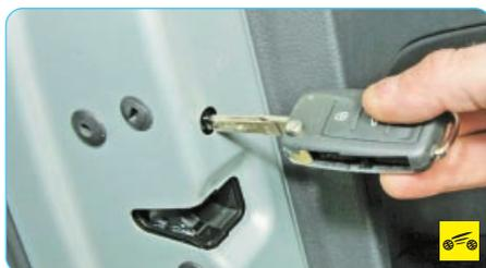
Для отключения «детской» блокировки поверните выключатель в левой двери против часовой стрелки, а в правой – по часовой стрелке.
