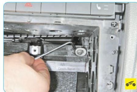
13. ...и четыре верхних винта крепления отсека для головного устройства аудиосистемы.
