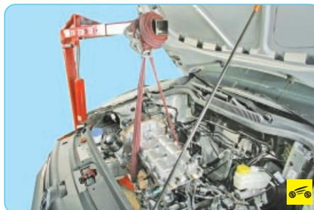
46. Вывесите силовой агрегат с помощью подъемного устройства.
