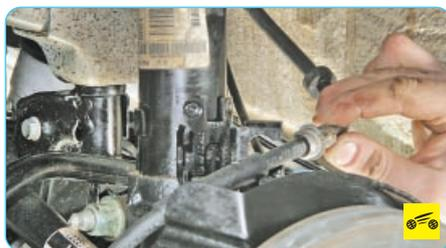
6. ...и отсоедините шланг от амортизаторной стойки передней подвески.
