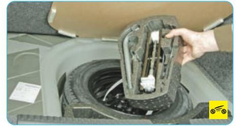
...находятся запасное колесо, а также уложенные в специальную кассету баллонный ключ, вороток домкрата, съемная буксирная проушина и домкрат.
