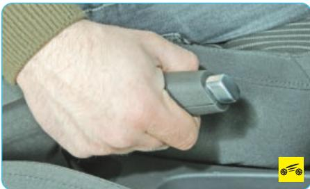
6. Проверьте работу стояночного тормоза. Для этого, поднимая рычаг до упора, подсчитайте количество щелчков. Если щелчков больше четырех, стояночный тормоз надо отрегулировать.
