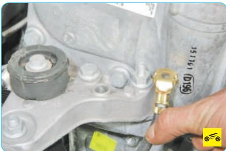
4. ...снимите гайку и провод «массы» со шпильки.
