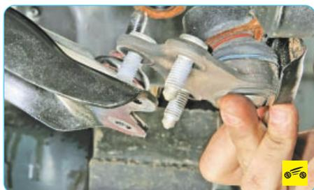
16. ...и выведите болты крепления шаровой опоры из отверстий в рычаге.
