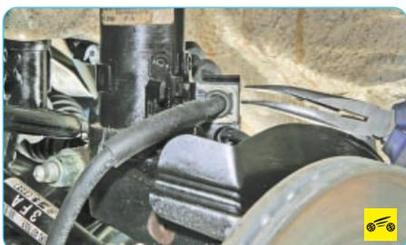
10. Подденьте пассатижами пружинный фиксатор...
