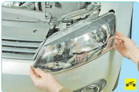
9. ...выдвиньте блок-фару вперед, преодолевая сопротивление фиксаторов, и снимите ее с автомобиля.
