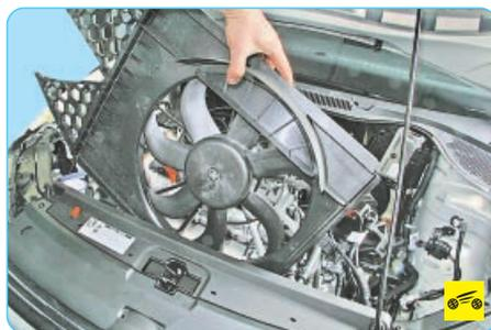
13. ...и снимите вентилятор в сборе с кожухом.
