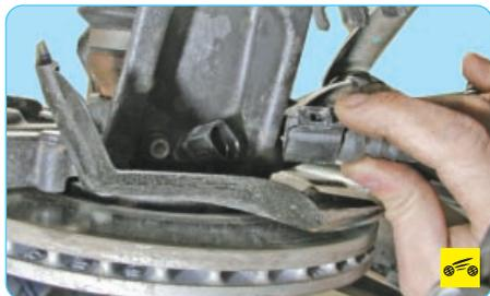
14. Отсоедините колодку жгута проводов от датчика частоты вращения колеса.
