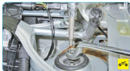
22. Удерживая шток амортизатора от проворачивания, отверните гайку верхнего крепления амортизаторной стойки...
