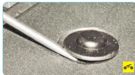
2. Для снятия датчика подденьте его отверткой...
