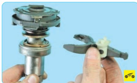
23. Разъедините рычаг и муфту привода.
