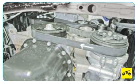
3. Проверьте состояние ремня внешним осмотром. Если на ремне обнаружены признаки сильного износа, его необходимо заменить. Если при выполнении ремонтных работ ремень привода вспомогательных агрегатов снимают не для замены, пометьте стрелкой направление движения ремня при работе двигателя, чтобы при сборке установить его в том же положении.
