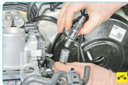
4. Отсоедините обратный клапан от вакуумного шланга к впускной трубе.
