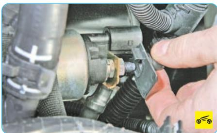
5. Снимите защитный колпачок с наконечника силового провода.
