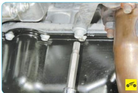
4. Выверните два винта крепления кронштейна крепления катколлектора к блоку цилиндров.
