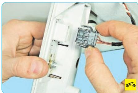
6. Сожмите фиксаторы и отсоедините колодку проводов от плафона.
