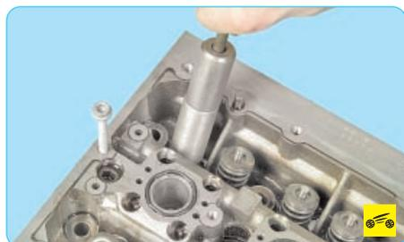
12. Снимите маслоъемный колпачок, потянув за съемник строго вверх.
