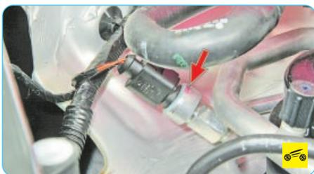
**Датчик давления** установлен в моторном отсеке на трубопроводе линии высокого давления.
