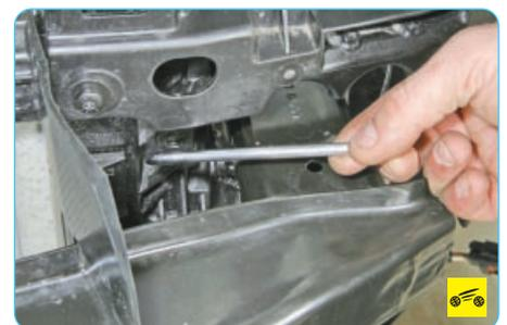
10. Выверните четыре винта крепления радиатора к кузову..
