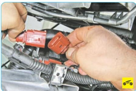
3. Отожмите фиксатор колодки жгута проводов датчика и разъедините колодки.
