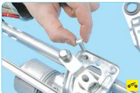
10. ...и извлеките винт из отверстия. Аналогично выверните два оставшихся винта крепления моторередуктора.
