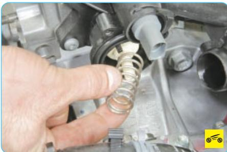
6. Извлеките из корпуса водораспределителя пружину...
