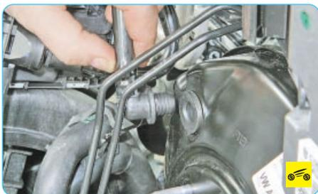
3. Извлеките наконечник вакуумного шланга из уплотнительной втулки в отверстии корпуса вакуумного усилителя тормозов.
