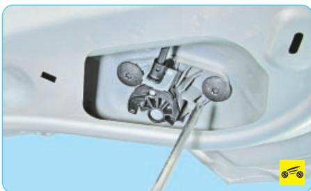
6. Выверните два винта крепления выключателя замка крышки багaжника...
