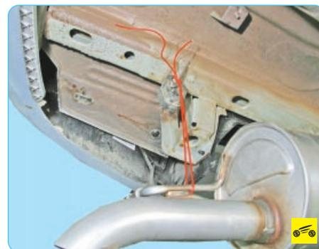
18. Снимите подушку подвески основного глушителя с кронштейна на глушителе (см. «Замена подушек подвески системы выпуска отработавших газов», с. 110) и, немного отведя глушитель вниз, подвяжите его к кузову проволокой.
