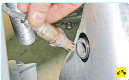
7. ...и снимите его с автомобиля.
