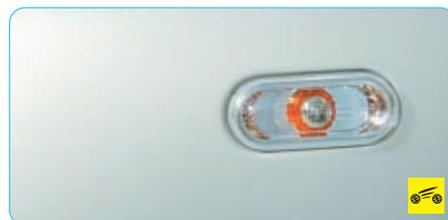
– лампа бокового указателя поворота, тип лампы W5W (5 Вт);
