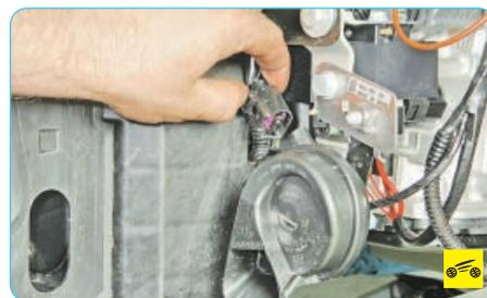
4. ...и отсоедините колодку (для наглядности показано со снятым передним бампером).
