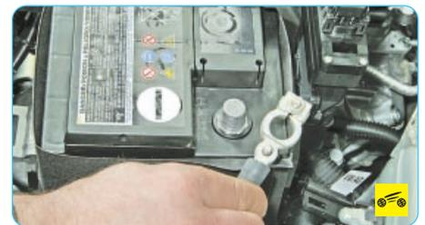
1. Отсоедините провод от клеммы «минус» аккумуляторной батареи.
