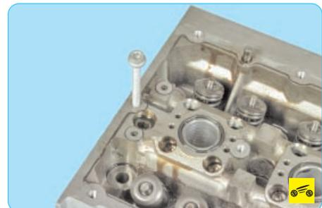
4. Для установки приспособления для сжатия пружин клапанов верните болт крепления крышки головки блока цилиндра в отверстие блока цилиндров.
