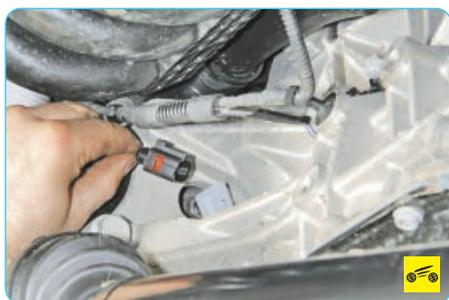
13. Нажмите на фиксатор колодки жгута проводов и отсоедините колодку от датчика положения коленчатого вала.
