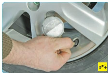
3. ...подсоедините манометр к вентилю и нажмите на золотник вентиля наконечником манометра.
