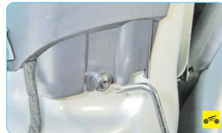
3. Выверните винт крепления внутренней угловой накладки двери...
