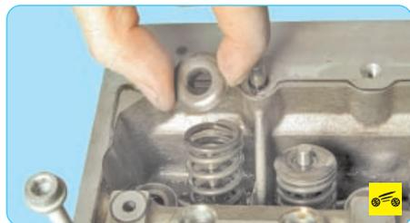
8. Снимите тарелку пружины...
