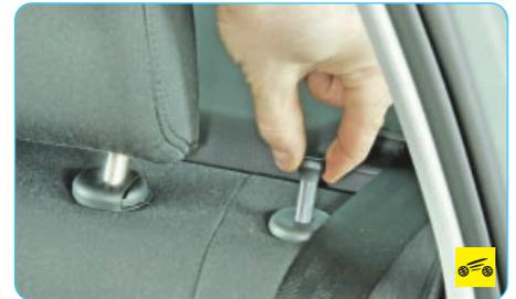
...поднимите вверх фиксатор замка спинки...
