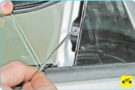
5. Выверните фиксатор пистона крепления угловой накладки оконного проема...
