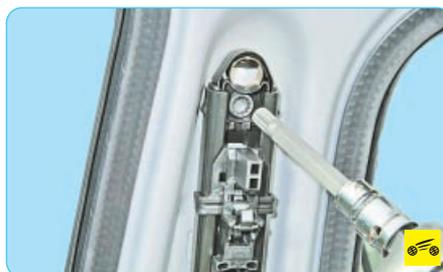
15. При необходимости снимите механизм регулировки переднего ремня безопасности по высоте. Для этого выверните болт крепления механизма регулировки к центральной стойке...
