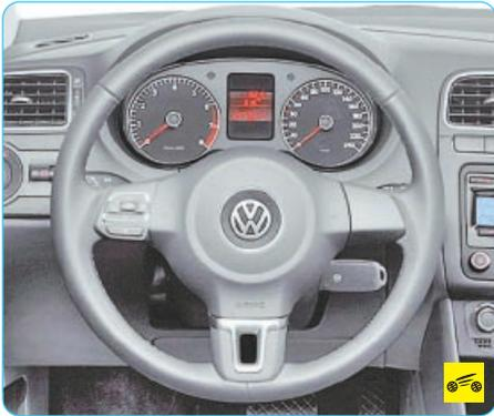
**Рулевое колесо** оснащено подушкой безопасности и выключателем звукового сигнала. В зависимости от комплектации автомобиля в левой спице рулевого колеса может быть установлен блок управления аудиосистемой и телефоном.
