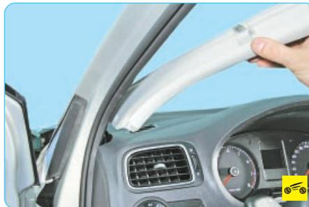
5. Подденьте отверткой и снимите облицовки передних стоек.
