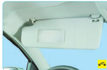
С тыльной стороны обоих козырьков под сдвижными крышками установлены косметические зеркала.
